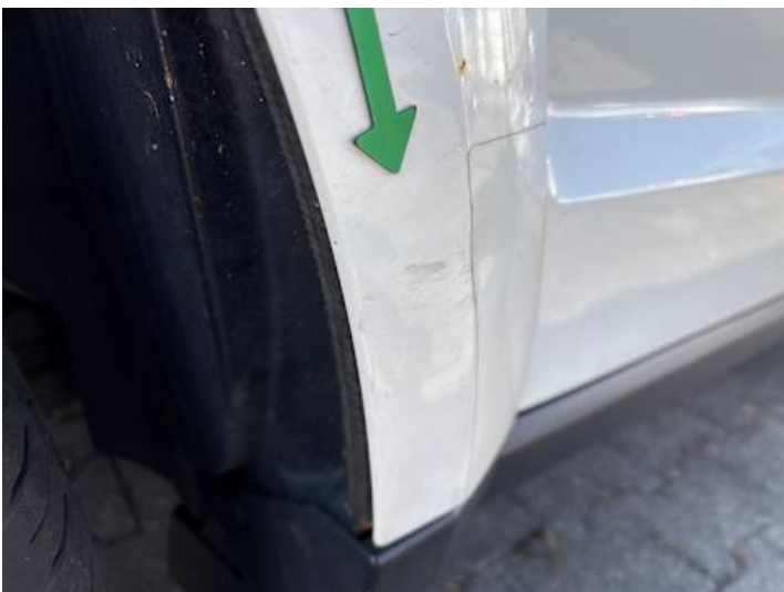
Türe hinten rechts (Rost, Kratzer, Delle)
