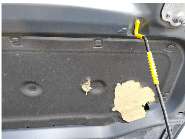
Beschädigung #7: Motorhaube: Dämmmatte - Marderschaden - erneuern
