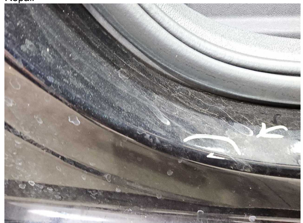
Beschädigung #11: Schweller rechts: Einstieg - Kratzer - Smart Repair
