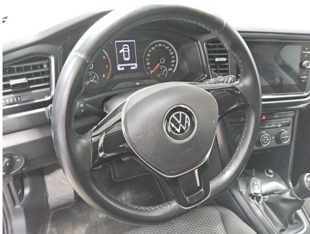
Beschädigung #5: Lenkanlage: Lenkrad - Kratzer - Wertminderung
