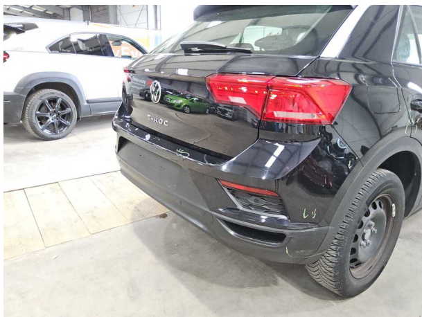
Beschädigung #16: Stossfänger hinten: Stossfänger hinten - verfor... erneuern
