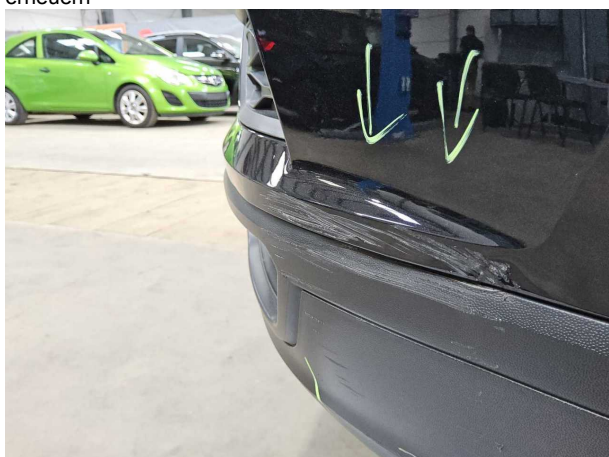
Beschädigung #16: Stossfänger hinten: Stossfänger hinten - verfor... erneuern
