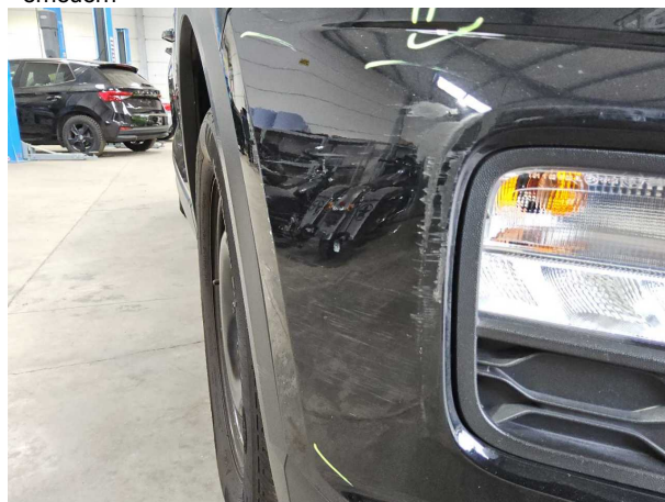
Beschädigung #15: Stossfänger vorn: Stossfänger vorn - verformt - erneuern
