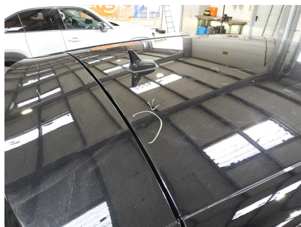
Beschädigung #8: Fahrzeugdach: Dach - Delle(n) - sanft instandsetzen
