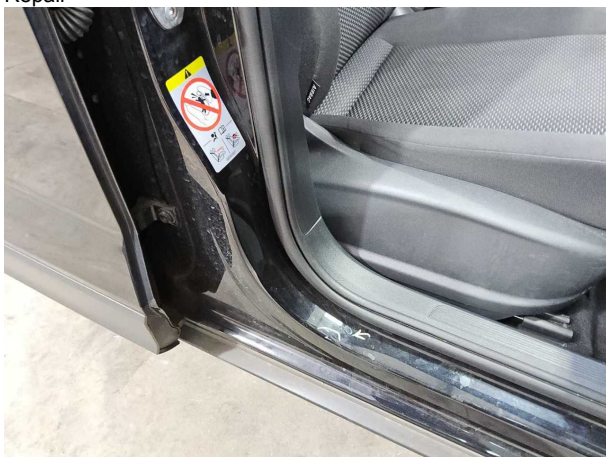
Beschädigung #11: Schweller rechts: Einstieg - Kratzer - Smart Repair
