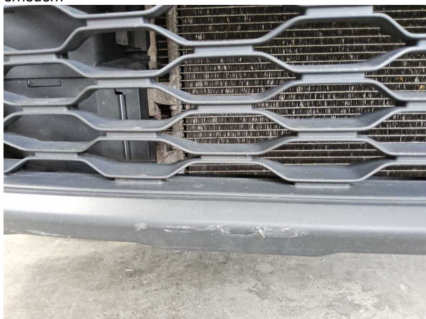
Beschädigung #15: Stossfänger vorn: Stossfänger vorn - verformt - erneuern
