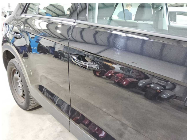
Beschädigung #3: Tür vorn rechts: Griff außen - Kratzer - Smart Repair
