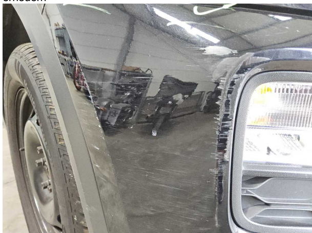
Beschädigung #15: Stossfänger vorn: Stossfänger vorn - verformt - erneuern
