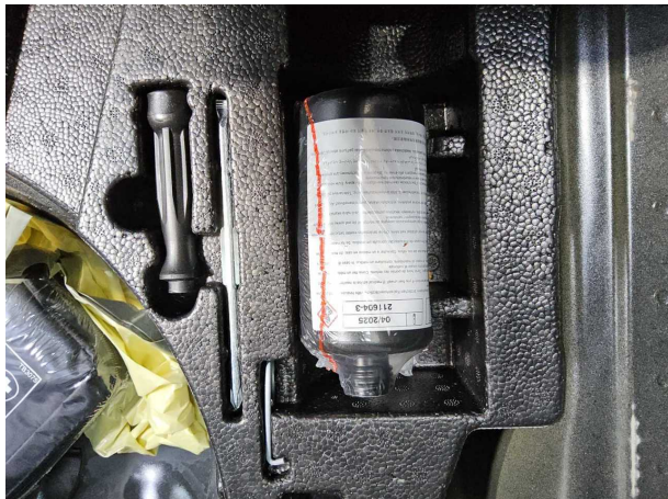
Beschädigung #1: Ausrüstung: Tirefit Füllmittel - abgelaufen - erneuern
