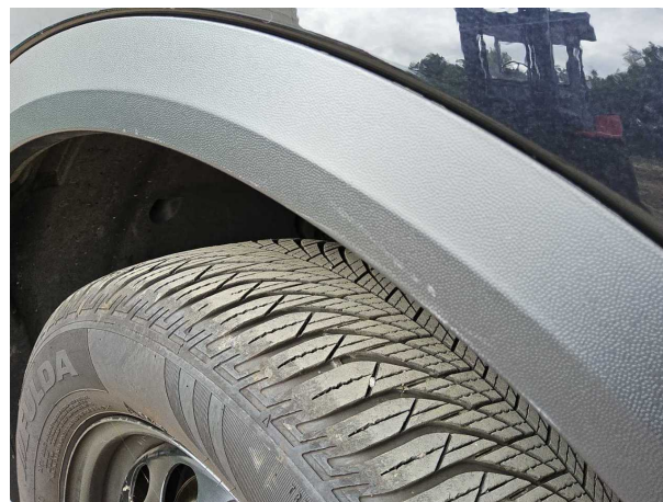
Beschädigung #12: Kotflügel rechts: Kotflügel rechts (Radlaufverbreiterung) - verkratzt / verschürft - erneuern
