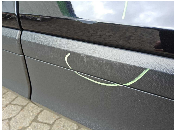
Beschädigung #2: Tür vorn rechts: Tür (Verkleidung) - Kratzer - Wertminderung
