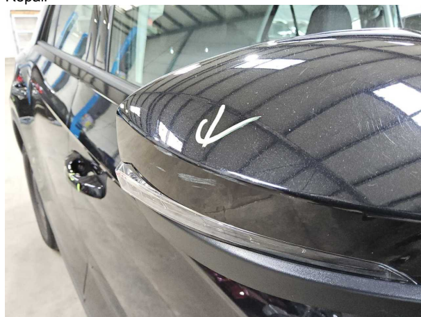
Beschädigung #4: Außenspiegel rechts: Abdeckkappe - Kratzer - Smart Repair
