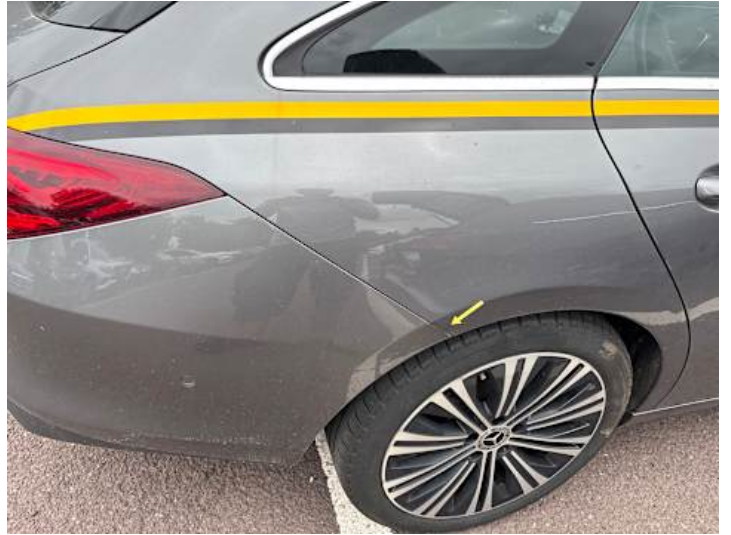
Stoßstange hinten (Spaltmaße ungenau)
