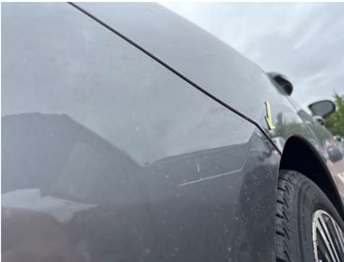
Stoßstange hinten (Spaltmaße ungenau)
