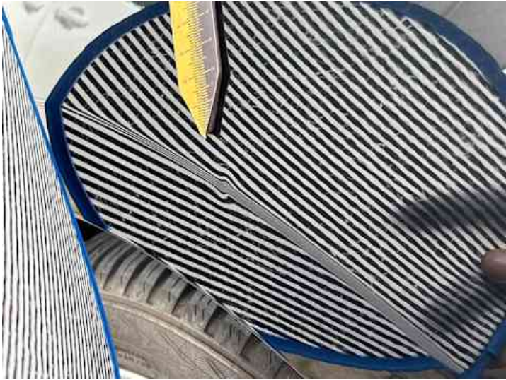
Seitenteil hinten rechts (Delle, Lackschaden)
