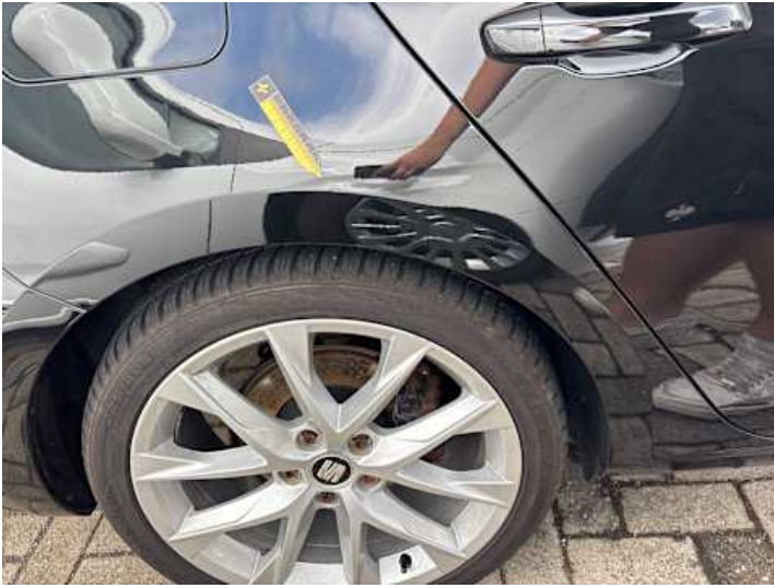
Seitenteil hinten rechts (Delle, Lackschaden)
