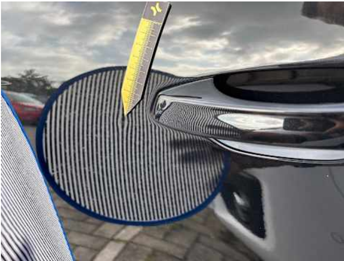
Türe hinten links (Delle)
