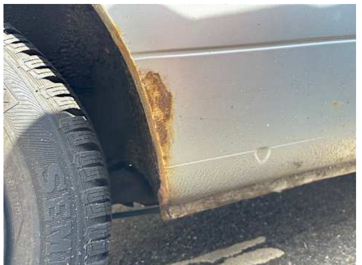
Schweller rechts (Rost)
