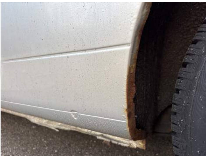
Schweller links (Rost)
