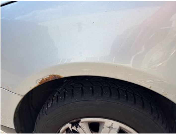
Kotflügel vorne links (Rost)
