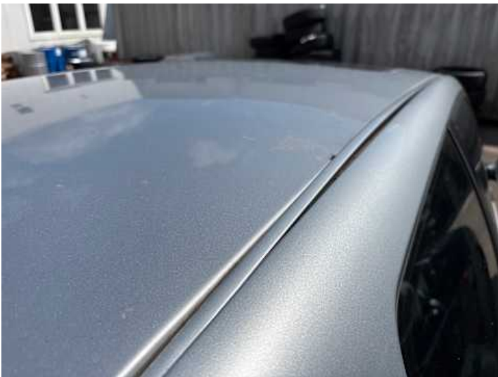
Dach (Spaltmaße ungenau)
