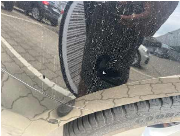
Seitenteil hinten rechts (Lackschaden)
