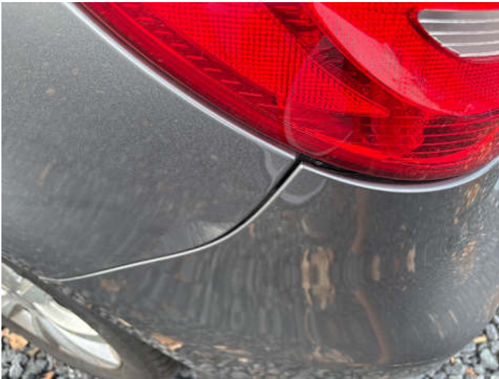
Stoßstange hinten (Kratzer, Spaltmaße ungenau)
