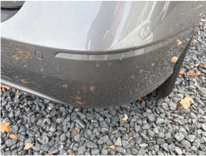
Stoßstange hinten (Kratzer, Spaltmaße ungenau)
