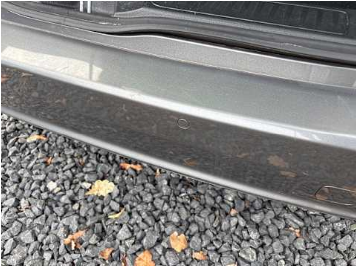
Stoßstange hinten (Kratzer, Spaltmaße ungenau)
