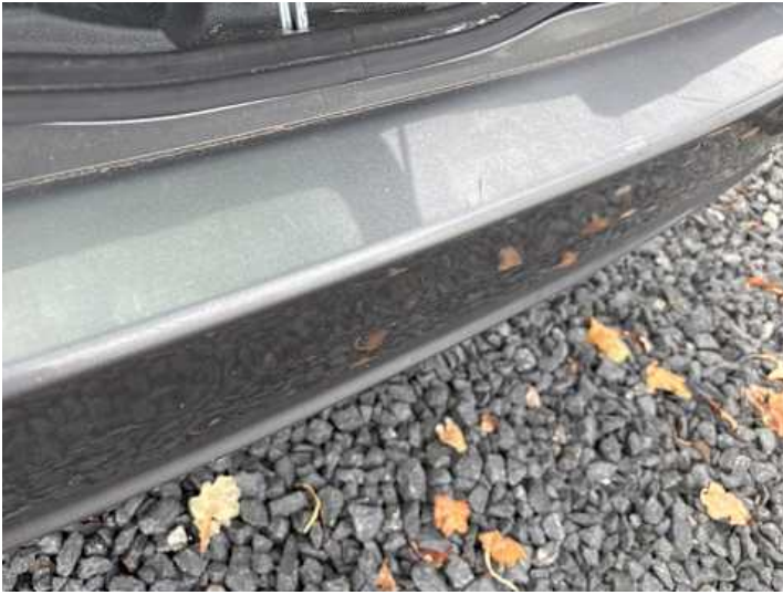
Stoßstange hinten (Kratzer, Spaltmaße ungenau)
