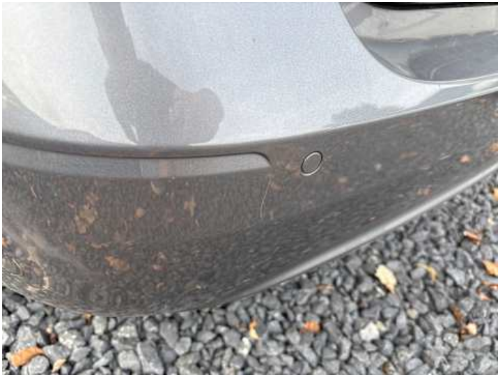
Stoßstange hinten (Kratzer, Spaltmaße ungenau)
