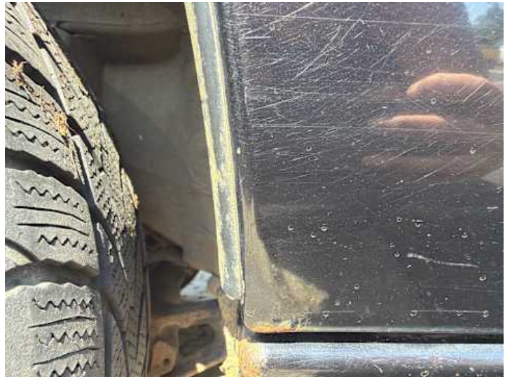
Türe hinten rechts (Rost)
