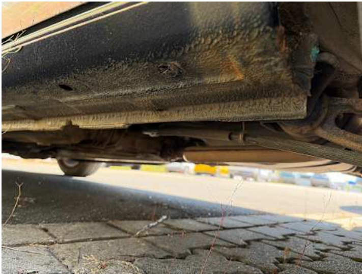
Schweller links (Rost)
