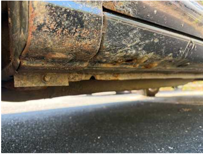
Schweller links (Rost)
