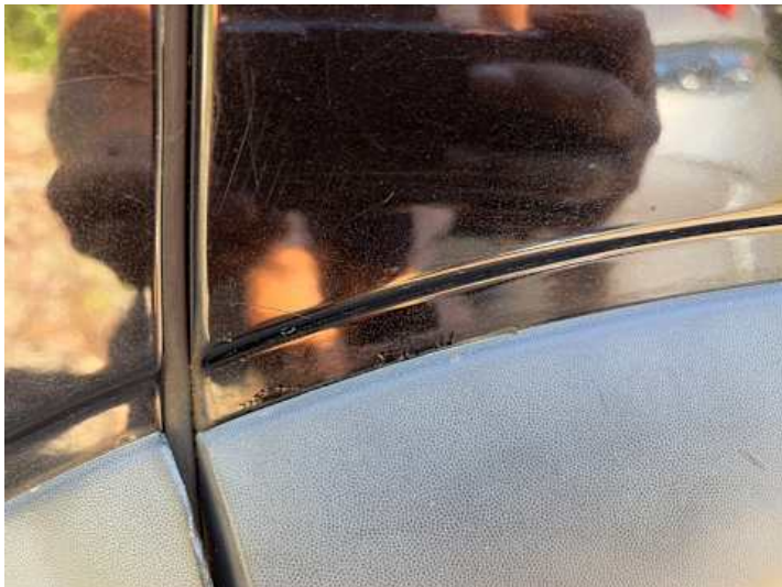
Seitenteil hinten links (Rost)
