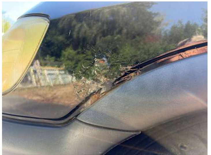
Kotflügel vorne links (Rost)
