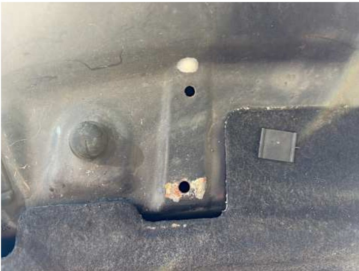
Motorhaube (Kratzer, Rost)
