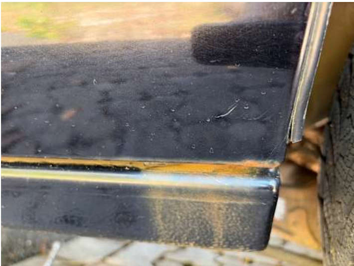
Türe hinten links (Rost)
