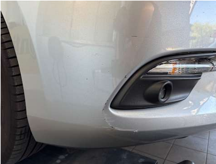
Stoßstange vorne (Kratzer, Verformung, Lackschaden, Unsachgemäß instand gesetzt, Steinschlag)
