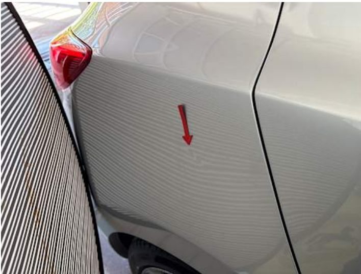
Seitenteil hinten rechts (Kratzer, Lackschaden, Delle, Verformung)
