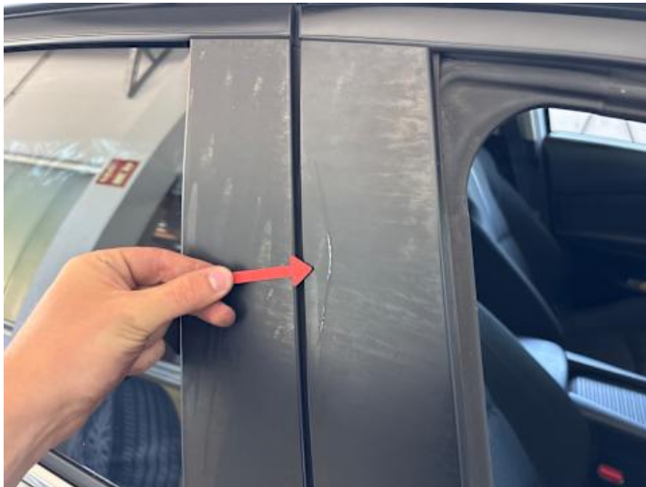
Beifahrertür (Lackschaden, Unsachgemäß instand gesetzt, Rost)
