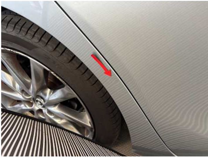
Seitenteil hinten rechts (Kratzer, Lackschaden, Delle, Verformung)
