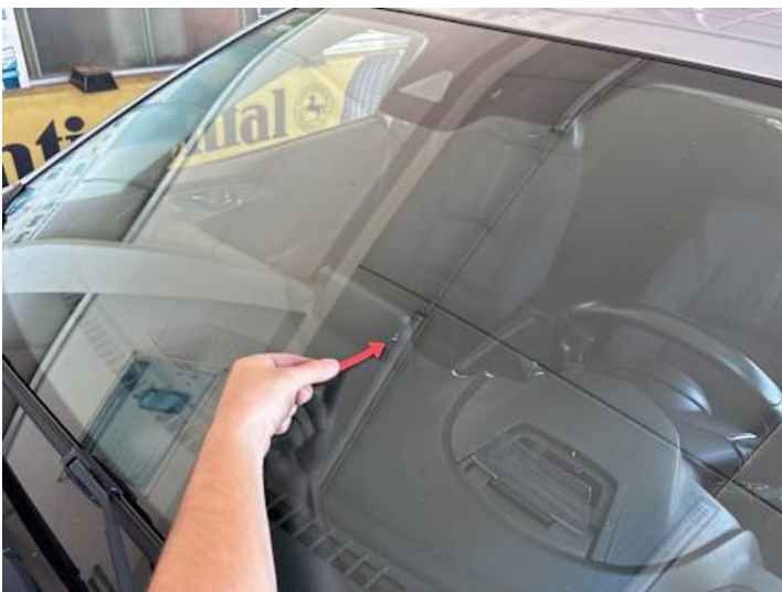
Windschutzscheibe (Riss/Bruch, Steinschlag)
