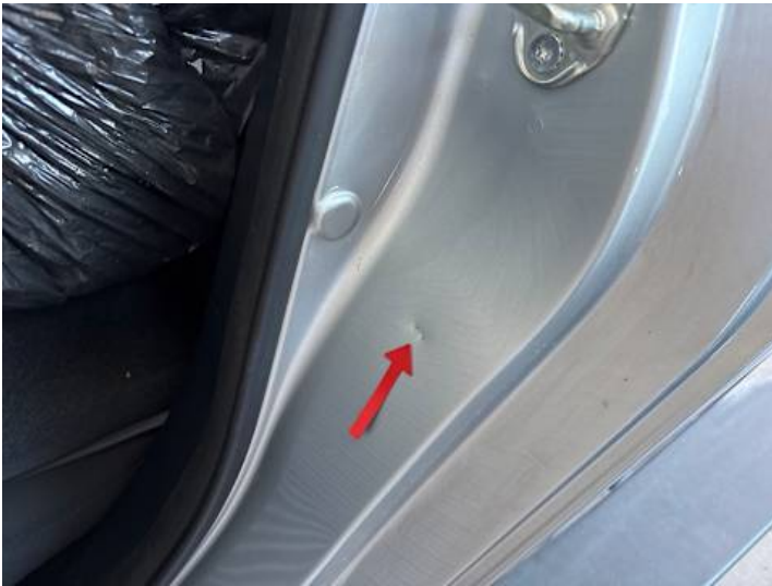
Seitenteil hinten links (Delle, Kratzer, Lackschaden)
