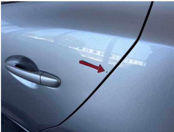
Türe hinten links (Lackschaden, Delle, Kratzer)
