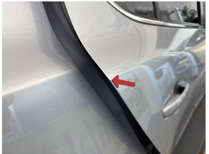
Türe hinten rechts (Lackschaden)
