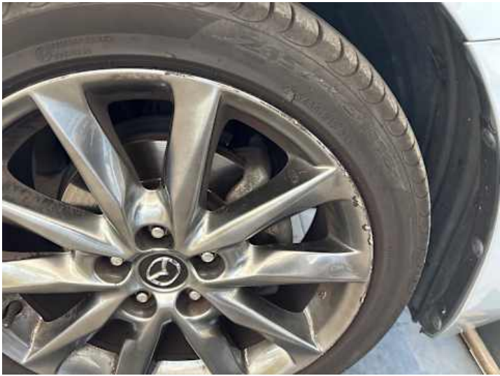
Rad (Kratzer, Kerben, Riss/Bruch)
