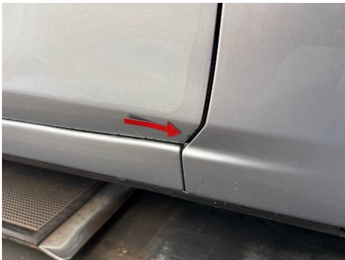
Beifahrertür (Lackschaden, Unsachgemäß instand gesetzt, Rost)
