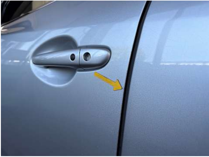
Fahrtür (Kratzer, Lackschaden)
