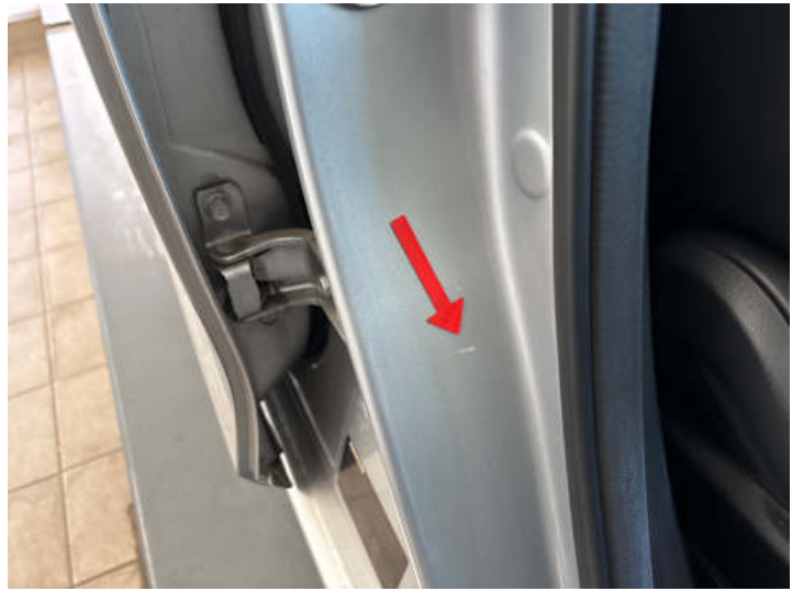
Schweller rechts (Kratzer, Lackschaden)
