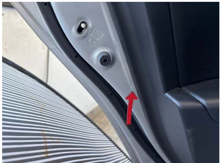
Türe hinten links (Lackschaden, Delle, Kratzer)
