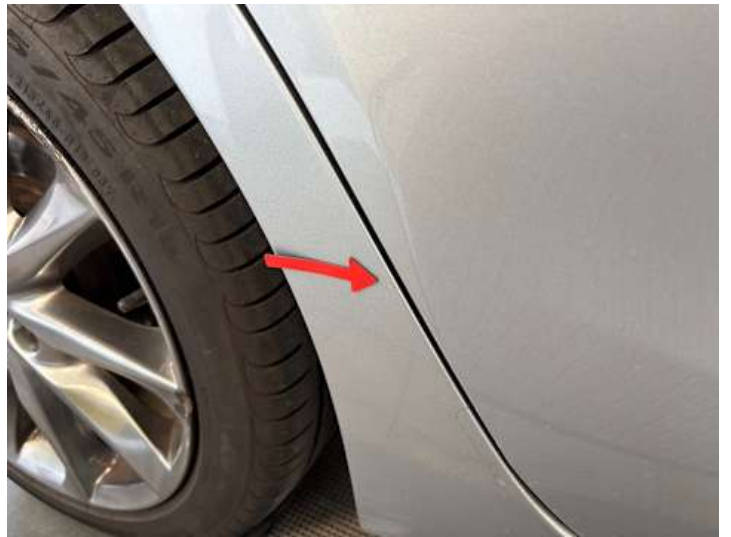
Seitenteil hinten rechts (Kratzer, Lackschaden, Delle, Verformung)
