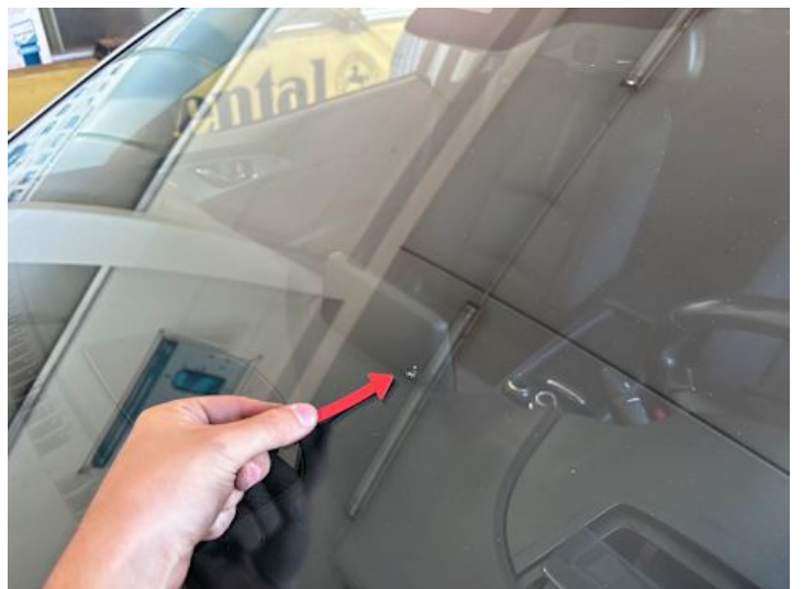
Windschutzscheibe (Riss/Bruch, Steinschlag)
