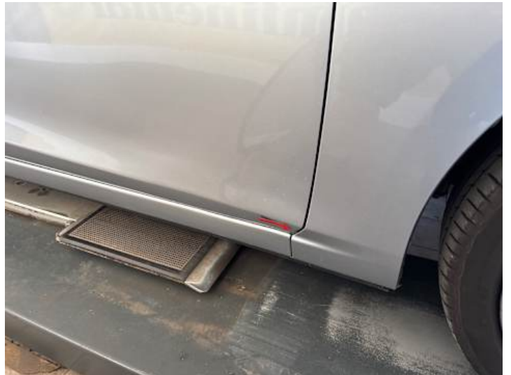
Beifahrertür (Lackschaden, Unsachgemäß instand gesetzt, Rost)
