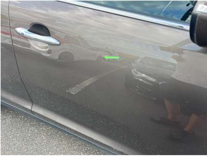
Beifahrtür (Lackschaden, Kratzer)
