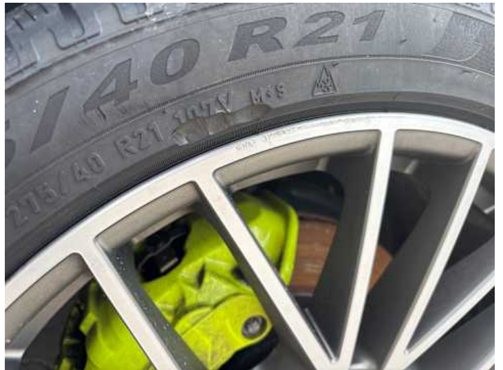
Rad (Kratzer, Kerben, Riss/Bruch)
