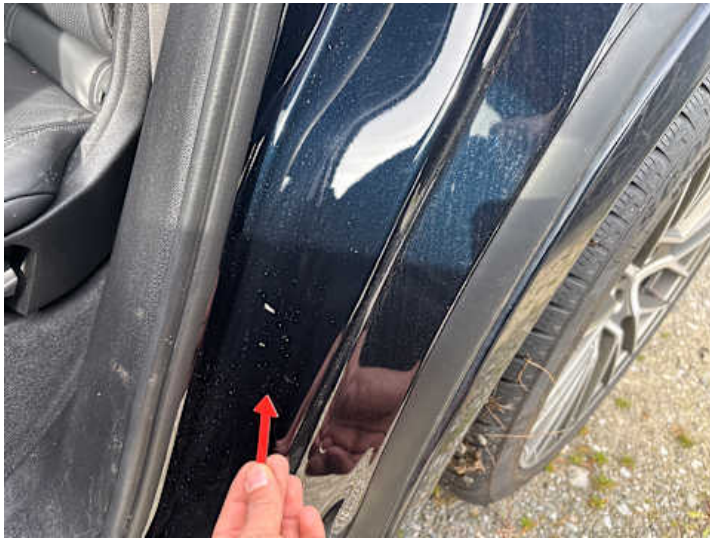
Schweller links (Kratzer, Delle)
