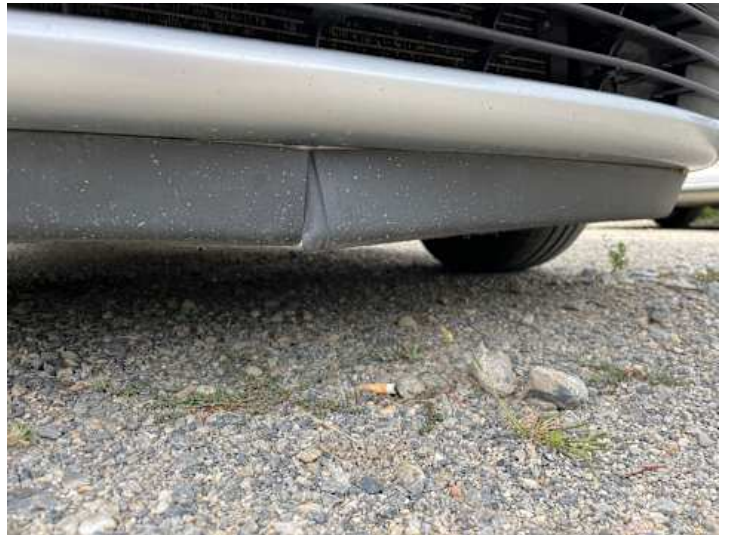
Stoßstange vorne (Verformung)
