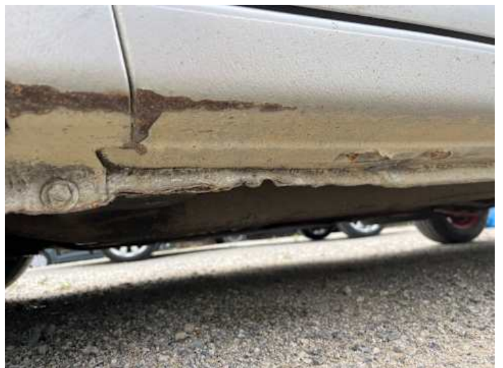
Schweller links (Rost)
