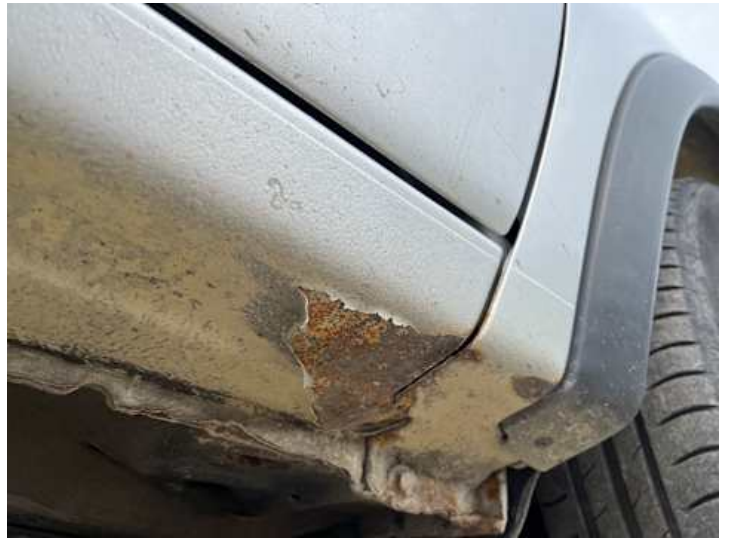
Schweller rechts (Rost, Lackschaden)
