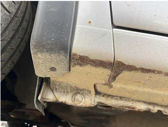
Kotflügel vorne links (Rost)
