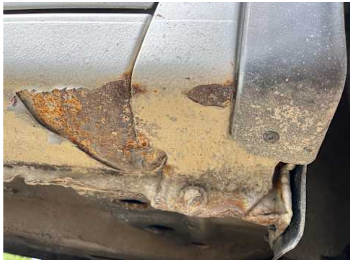
Kotflügel vorne rechts (Rost)
