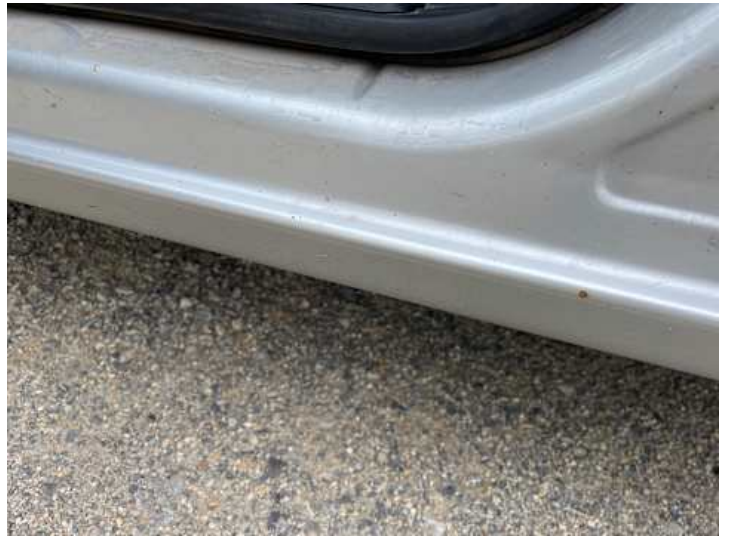
Schweller links (Rost)
