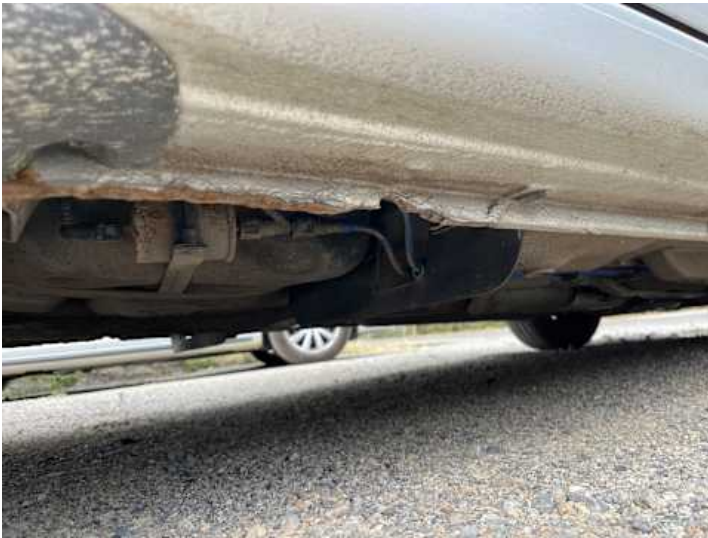
Schweller rechts (Rost, Lackschaden)
