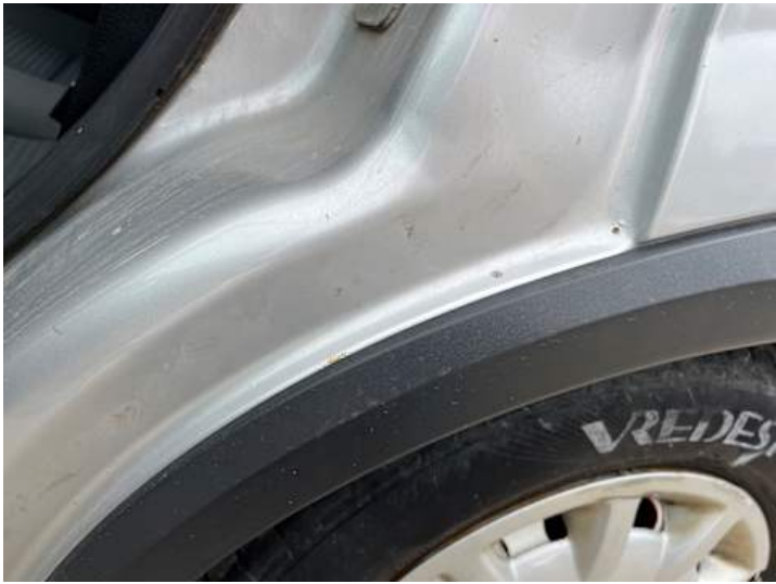
Seitenteil hinten links (Rost)
