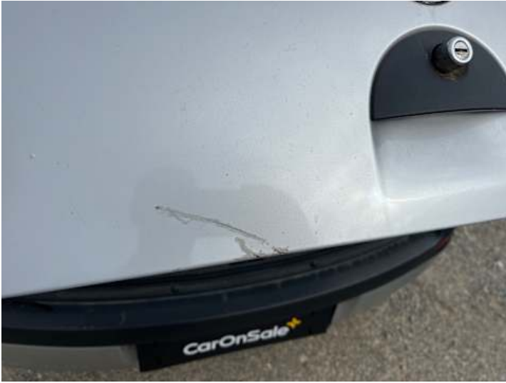
Heckklappe (Kratzer, Rost)
