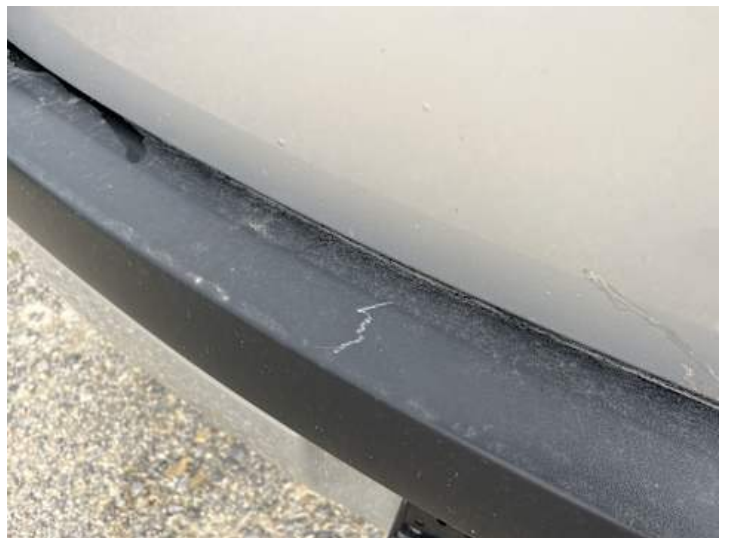
Stoßstange hinten (Kratzer)
