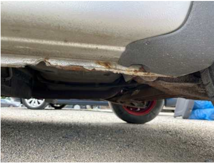
Schweller links (Rost)
