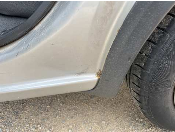
Seitenteil hinten links (Rost)
