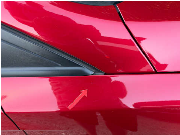
Kotflügel vorne rechts (Kratzer, Lackschaden)
