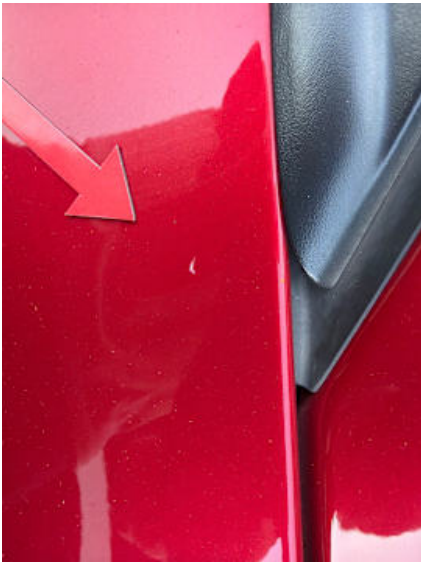
Kotflügel vorne rechts (Kratzer, Lackschaden)
