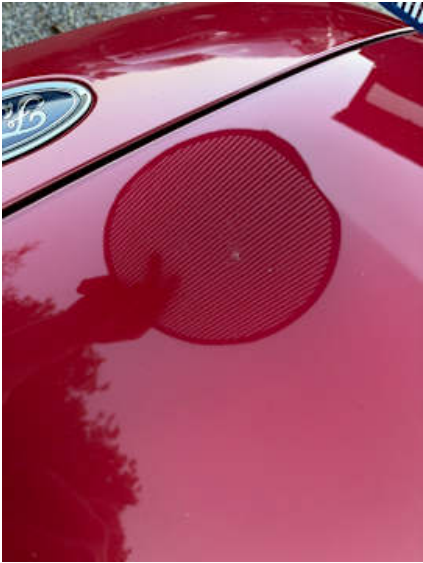
Motorhaube (Lackschaden, Delle)
