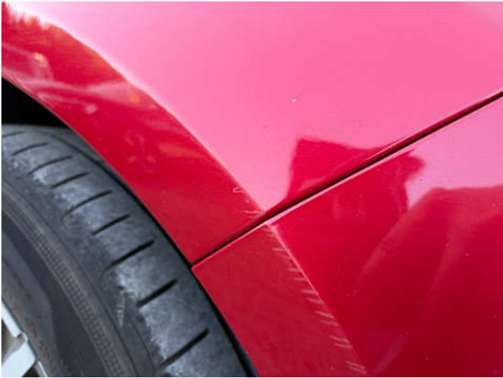
Kotflügel vorne rechts (Kratzer, Lackschaden)
