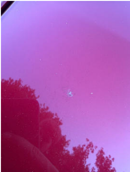
Motorhaube (Lackschaden, Delle)
