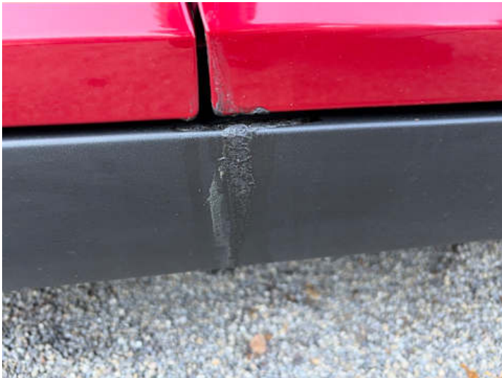
Schweller rechts (Lackschaden)
