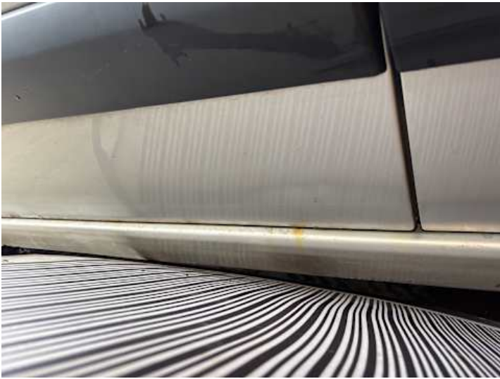
Türe hinten rechts (Rost, Lackschaden, Kratzer)
