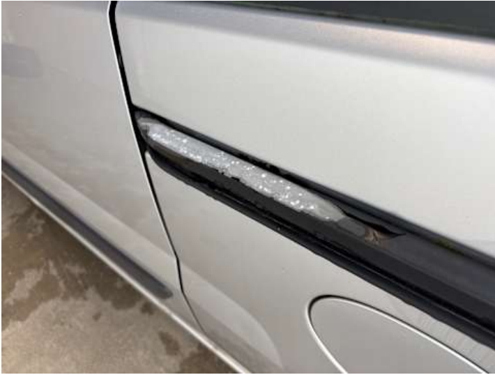
Seitenteil hinten links (Lackschaden, Ausgeblichen/Matt)
