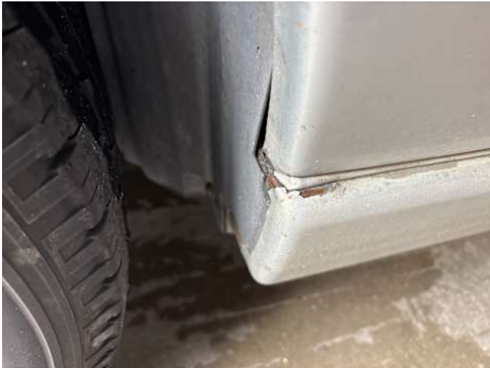
Schweller rechts (Lackschaden)
