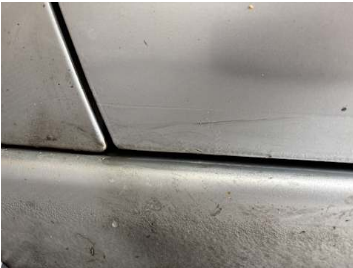
Fahrertür (Rost, Unsachgemäß instand gesetzt)
