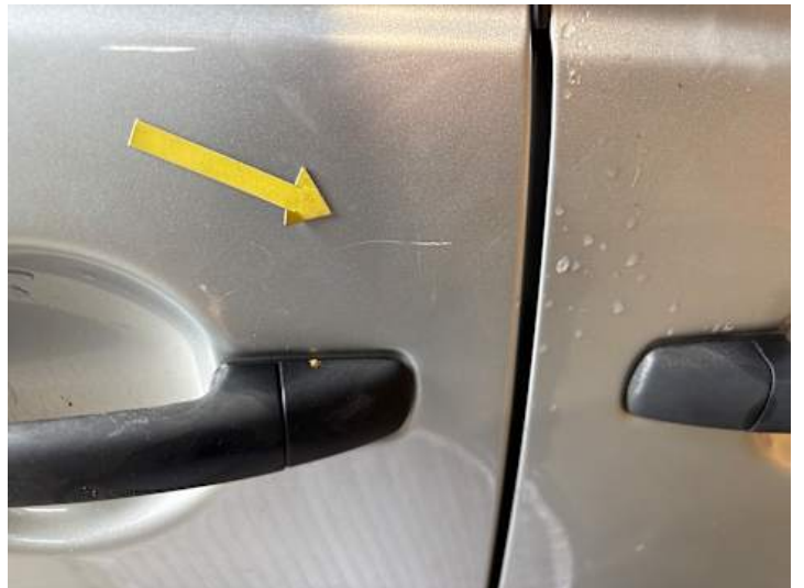
Türe hinten rechts (Rost, Lackschaden, Kratzer)
