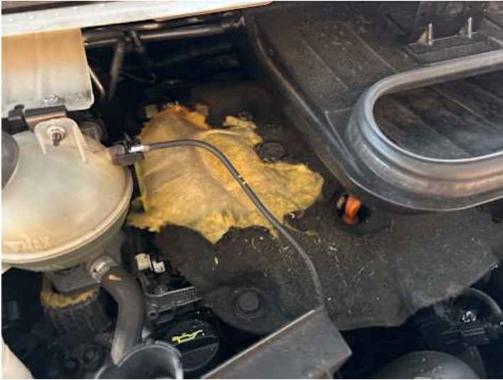
Motorhaube (Anderer Schaden): Dämmmatte angefressen
