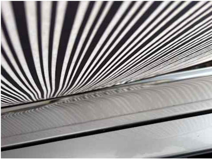
Seitenteil hinten links (Lackschaden, Ausgeblichen/Matt)
