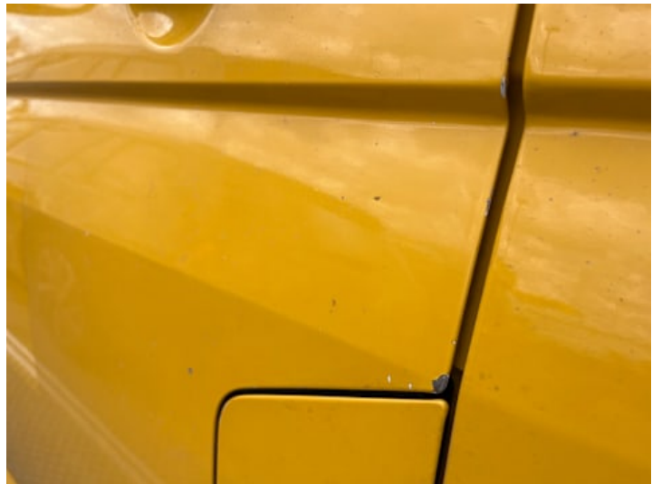
Fahrertür (Lackschaden, Rost)
