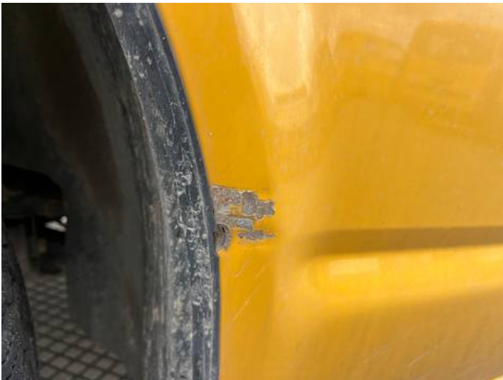
Fahrertür (Lackschaden, Kratzer, Verformung, Rost)
