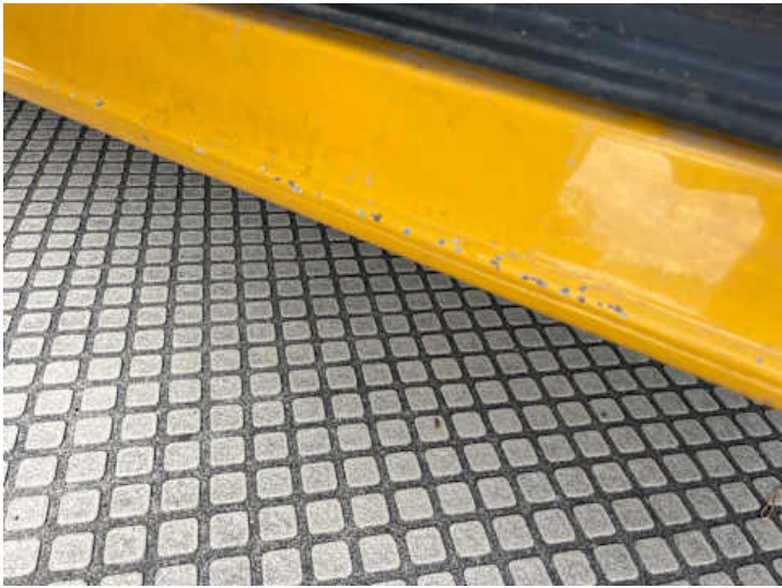
Schweller links (Lackschaden)
