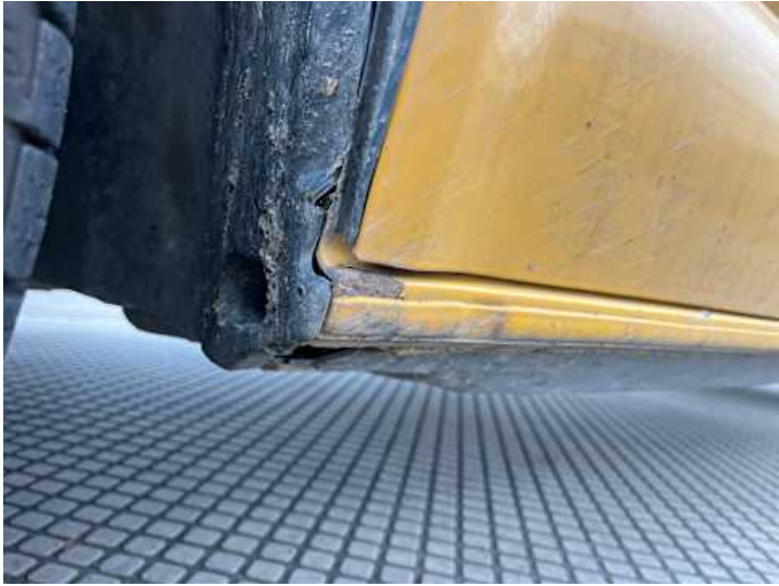
Schweller links (Rost)
