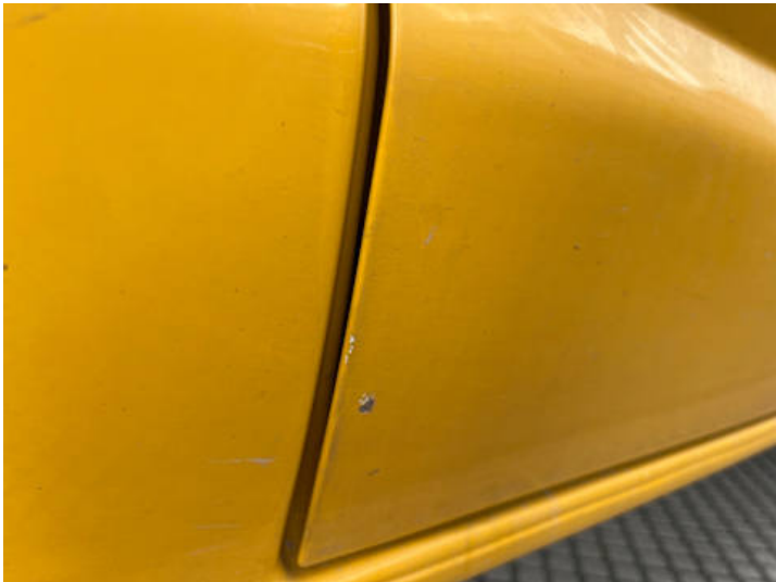
Türe hinten rechts (Lackschaden)
