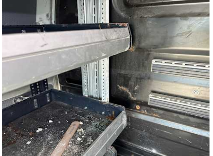
Innenraum (Diverse Schäden, Verschmutzung, Anderer Schaden): Korrosion
