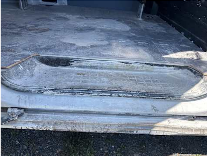
Innenraum (Diverse Schäden, Verschmutzung, Anderer Schaden): Korrosion
