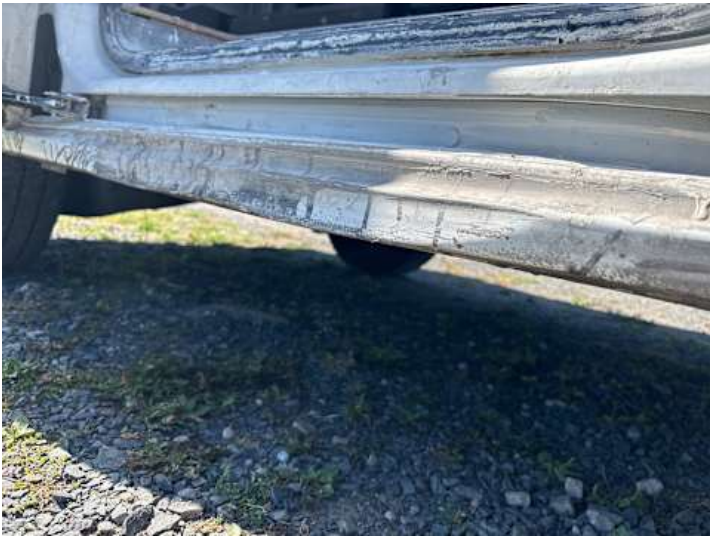
Schweller rechts (Delle, Verformung)
