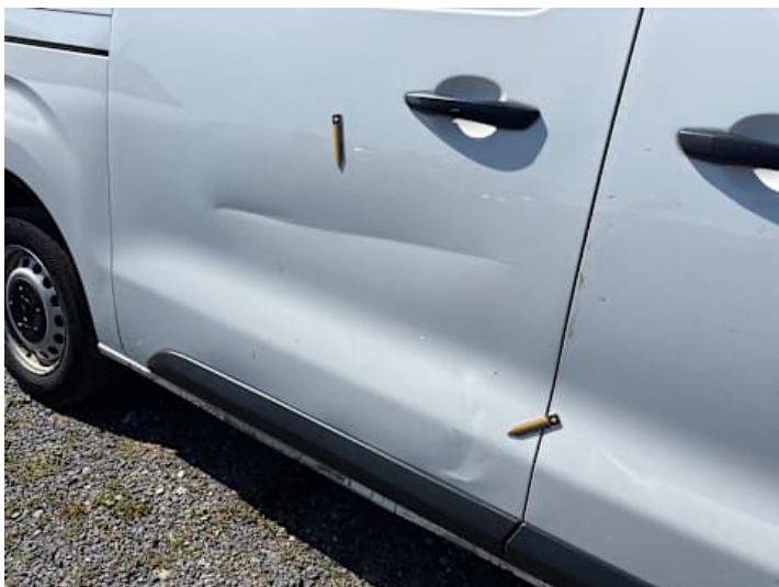
Türe hinten rechts (Verformung, Kratzer)
