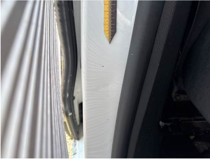
Schweller rechts (Delle, Verformung)
