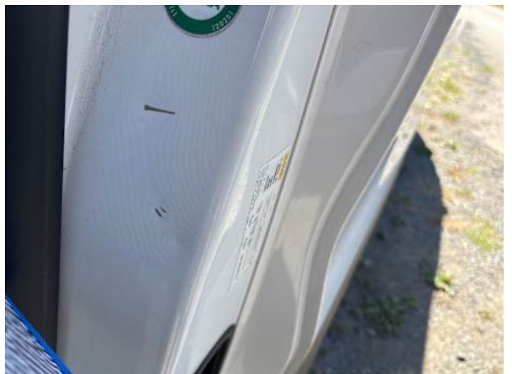
Schweller links (Delle, Kratzer)
