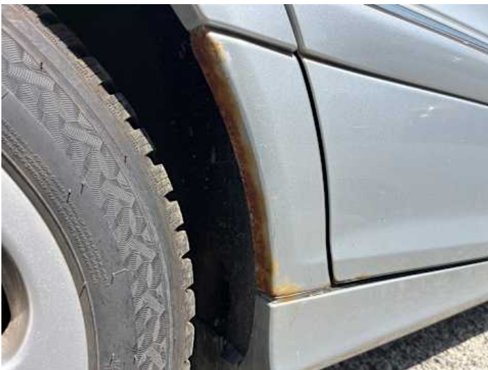
Seitenteil hinten rechts (Lackschaden, Rost)
