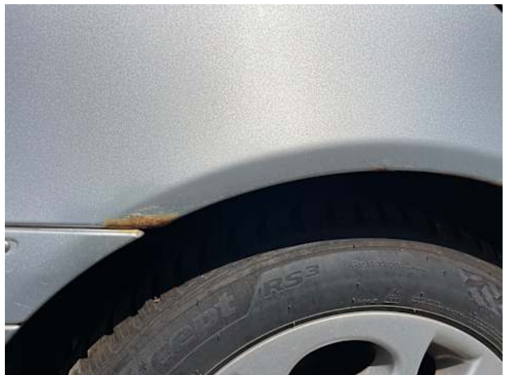
Seitenteil hinten rechts (Lackschaden, Rost)
