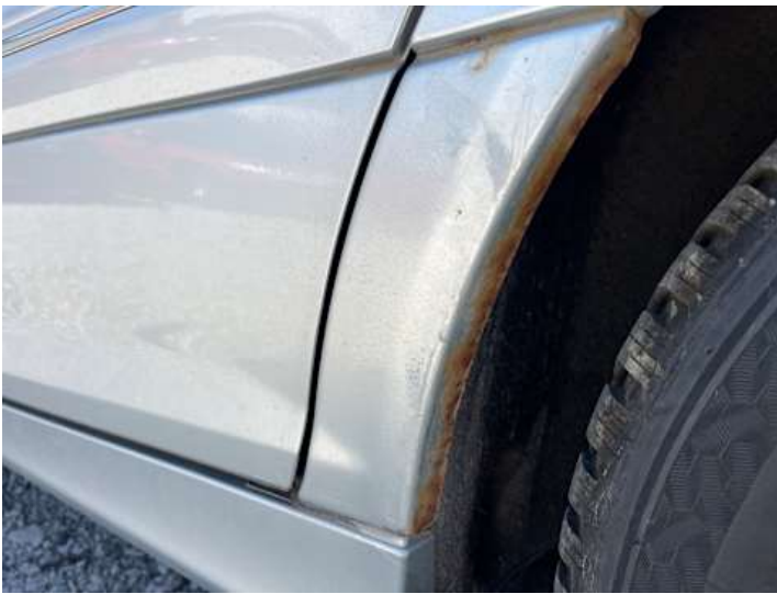
Seitenteil hinten links (Lackschaden, Rost, Unsachgemäß instand gesetzt)
