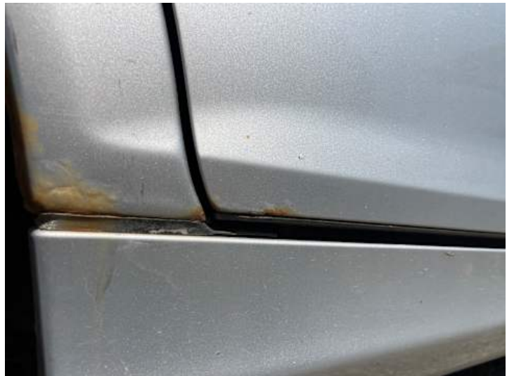
Türe hinten rechts (Lackschaden, Rost)
