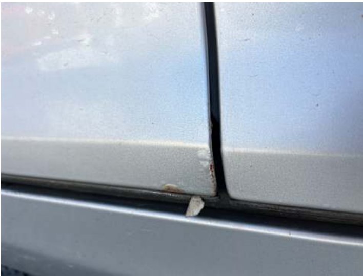
Fahrertür (Lackschaden, Rost)
