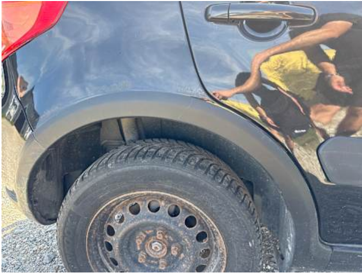
Seitenteil hinten rechts (Kratzer, Verformung)
