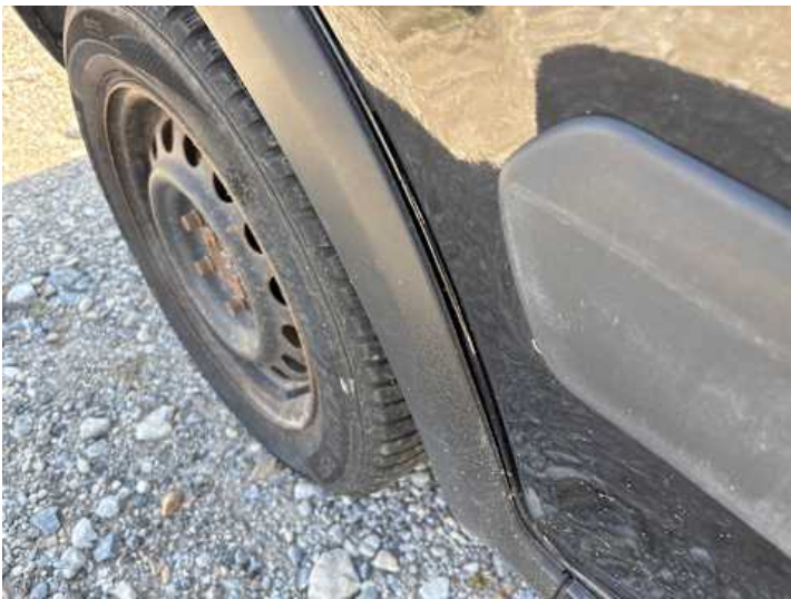
Seitenteil hinten rechts (Kratzer, Verformung)
