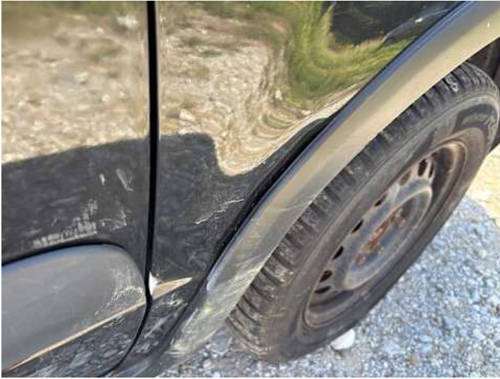
Kotflügel vorne rechts (Kratzer, Verformung)
