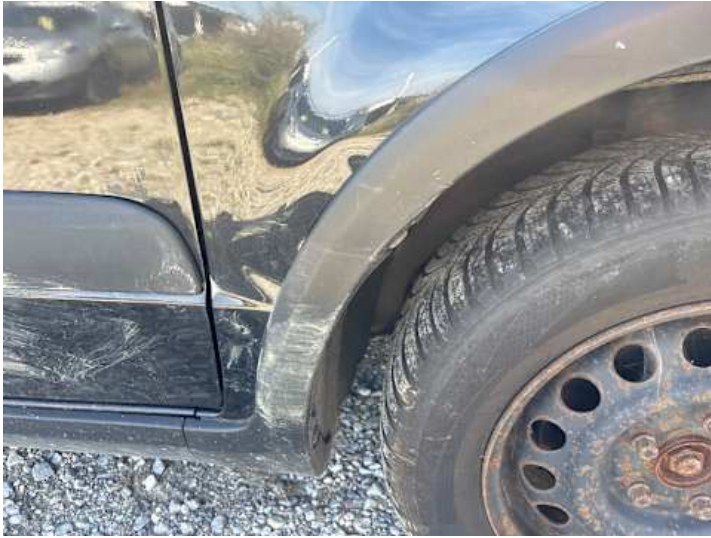
Kotflügel vorne rechts (Kratzer, Verformung)
