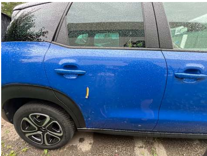
Türe hinten rechts (Kratzer, Lackschaden)
