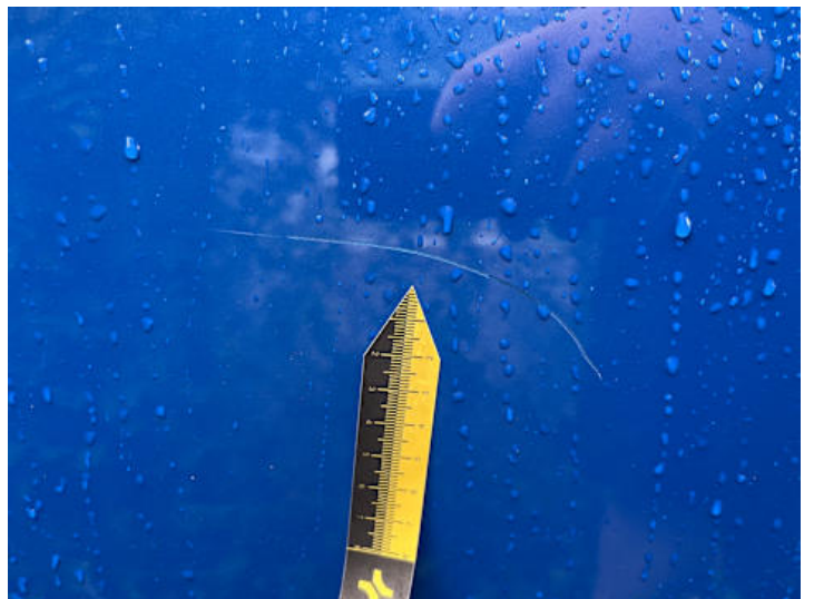
Türe hinten rechts (Kratzer, Lackschaden)
