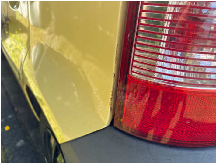
Seitenteil hinten links (Rost)
