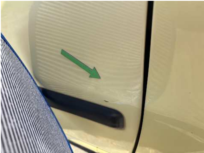
Beifahrertür (Kratzer, Delle)
