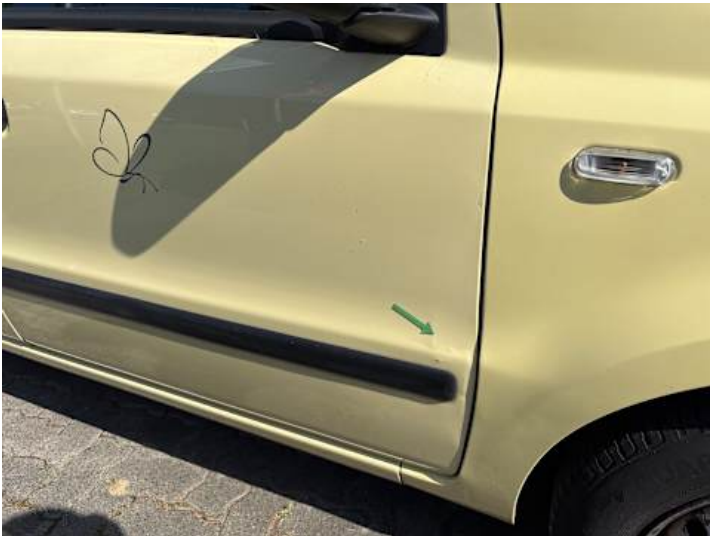
Beifahrertür (Kratzer, Delle)
