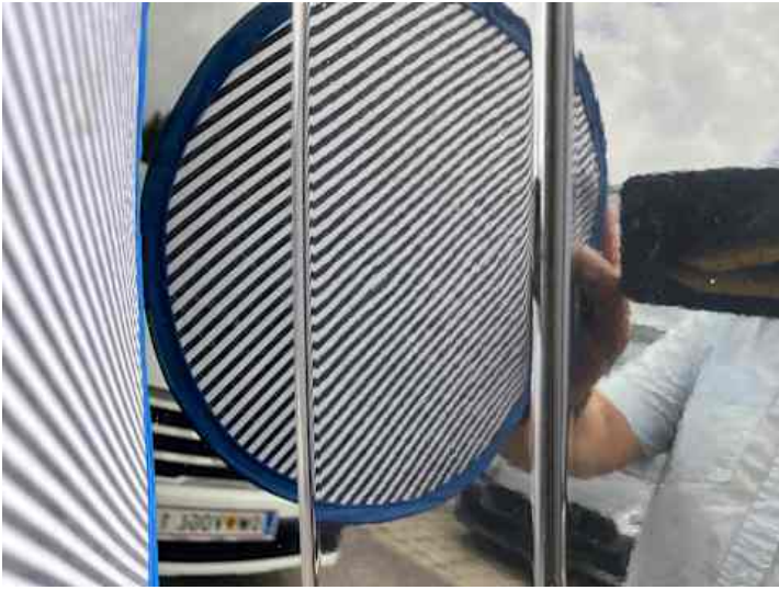
Türe hinten rechts (Delle)
