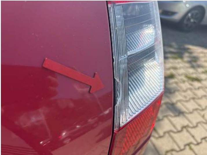
Rücklicht (rechts) (Riss/Bruch)
