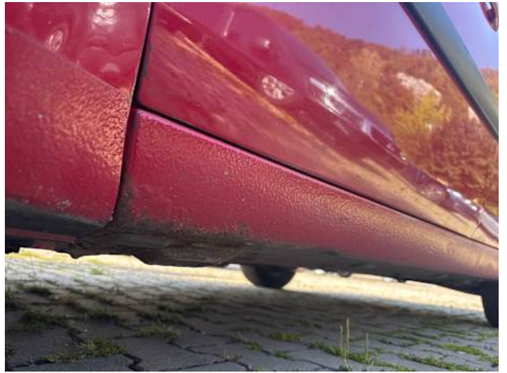
Schweller links (Rost)
