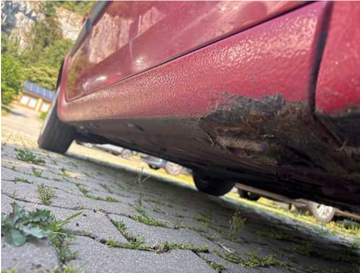
Schweller rechts (Rost, Unsachgemäß instand gesetzt)
