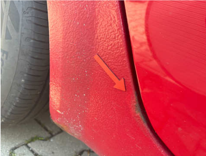
Seitenteil hinten rechts (Rost)
