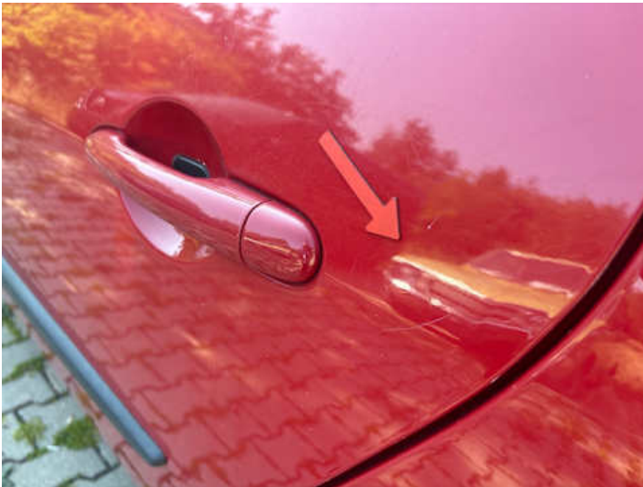
Türe hinten links (Kratzer)
