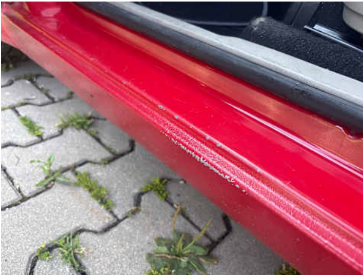
Schweller links (Kratzer)
