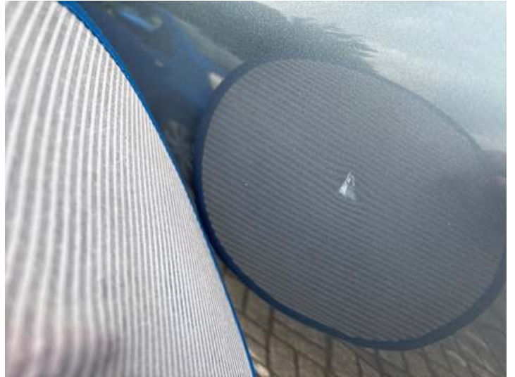
Türe hinten links (Kratzer, Delle)
