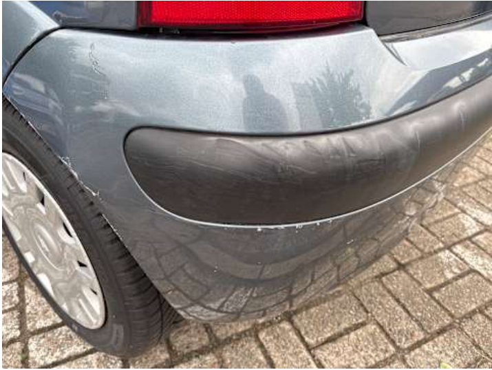
Stoßstange hinten (Lackschaden)
