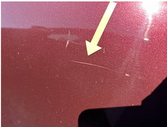
Seitenteil hinten links (Lackschaden, Kratzer)
