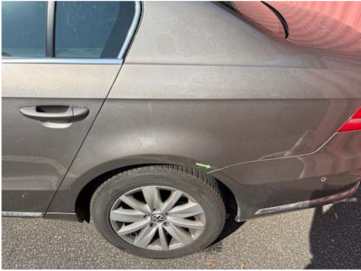
Seitenteil hinten links (Rost)
