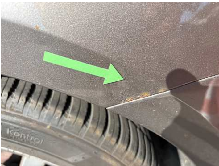
Seitenteil hinten links (Rost)
