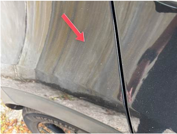
Seitenteil hinten rechts (Kratzer)
