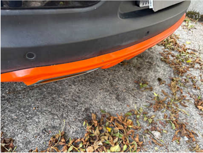
Stoßstange hinten (Delle)
