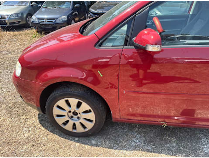
Kotflügel vorne links (Verformung, Lackschaden)
