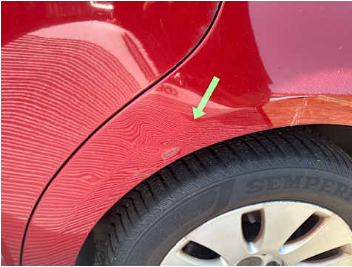
Seitenteil hinten links (Lackschaden, Kratzer, Verformung, Rost)
