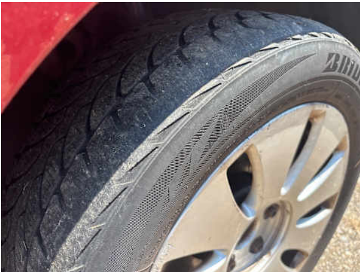
Rad (Kerben, Kratzer, Ungleichmäßig abgefahren)
