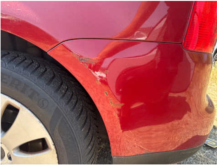
Stoßstange hinten (Lackschaden, Kratzer, Unsachgemäß instand gesetzt)
