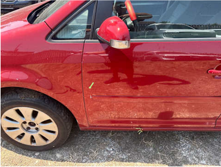
Fahrtür (Lackschaden, Verformung)
