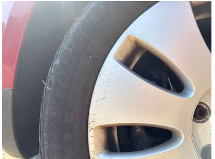
Rad (Kerben, Kratzer, Ungleichmäßig abgefahren)
