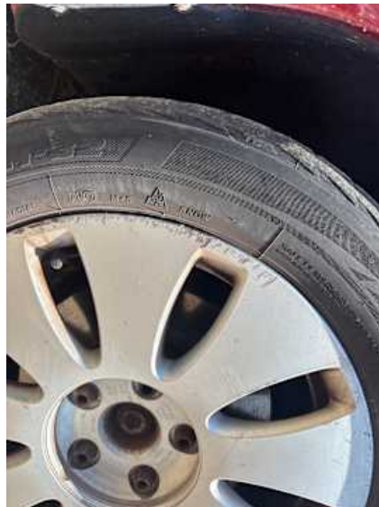
Rad (Kerben, Kratzer, Ungleichmäßig abgefahren)
