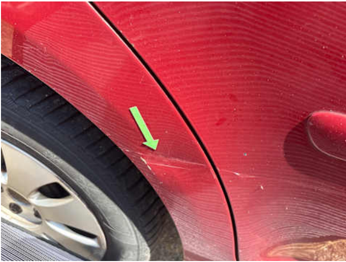
Seitenteil hinten rechts (Lackschaden, Kratzer, Verformung)
