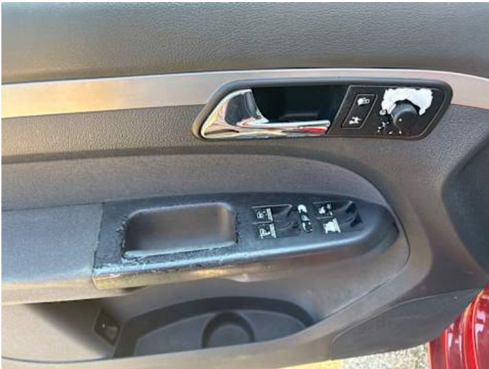
Innenraum (Verschleiß, Verschmutzung, Riss/Bruch)
