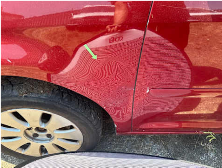
Kotflügel vorne links (Verformung, Lackschaden)
