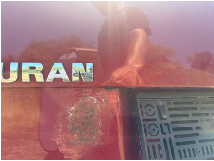
Heckklappe (Rost, Lackschaden, Verformung)
