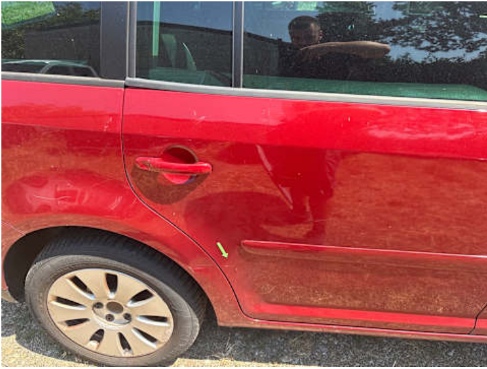
Türe hinten rechts (Lackschaden, Kratzer, Verformung)
