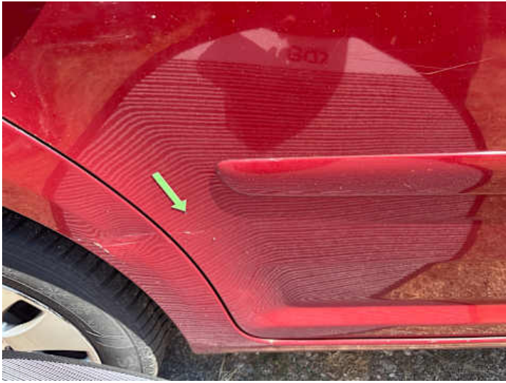
Türe hinten rechts (Lackschaden, Kratzer, Verformung)
