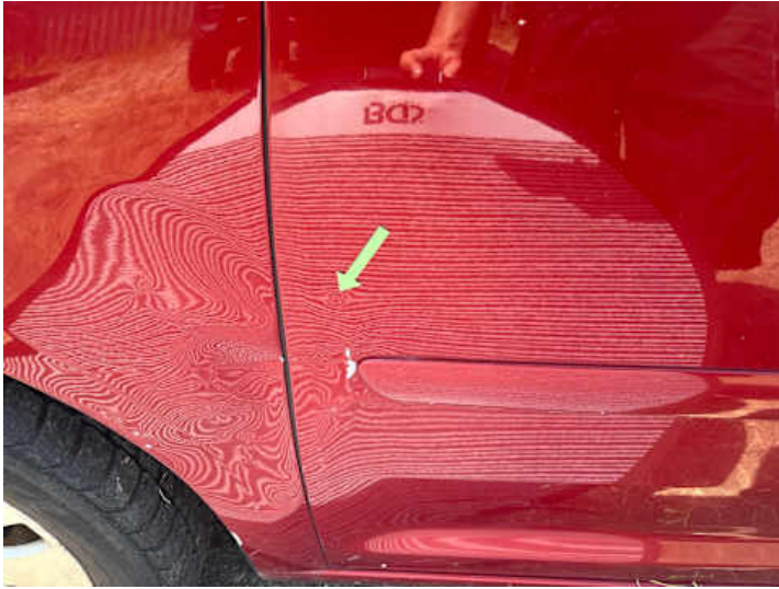
Fahrtür (Lackschaden, Verformung)
