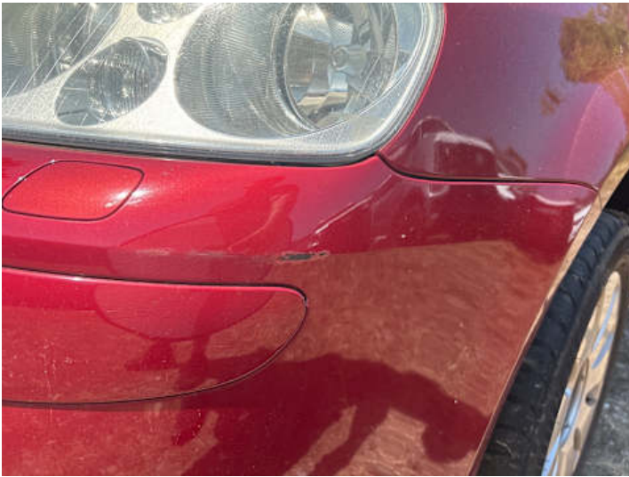
Stoßstange vorne (Lackschaden, Kratzer)
