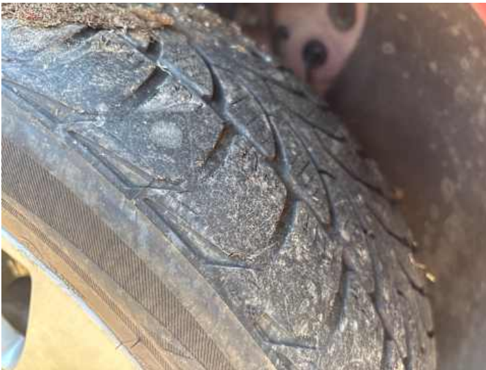
Rad (Kerben, Kratzer, Ungleichmäßig abgefahren)
