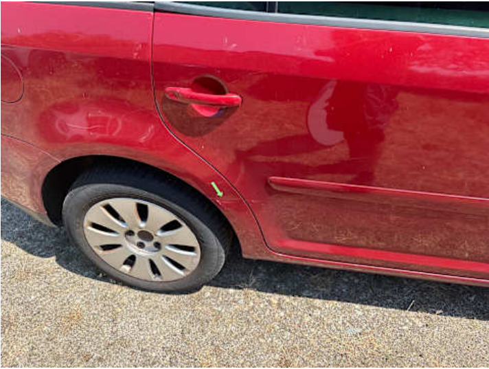
Seitenteil hinten rechts (Lackschaden, Kratzer, Verformung)
