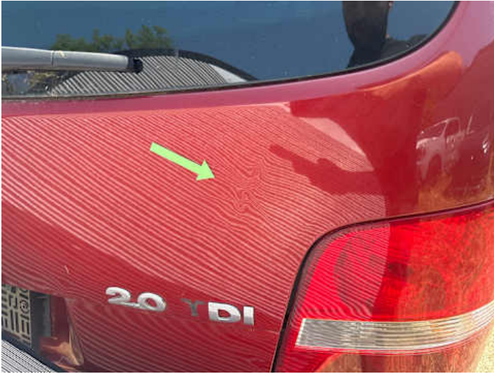
Heckklappe (Rost, Lackschaden, Verformung)
