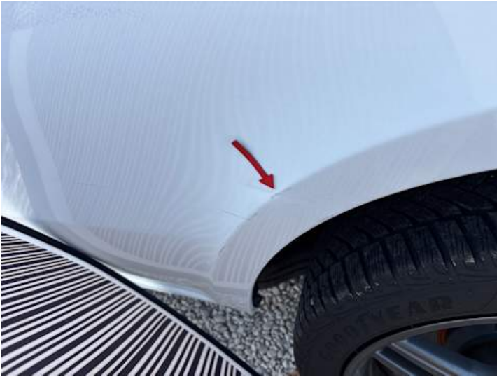
Seitenteil hinten links (Kratzer, Lackschaden, Verformung)
