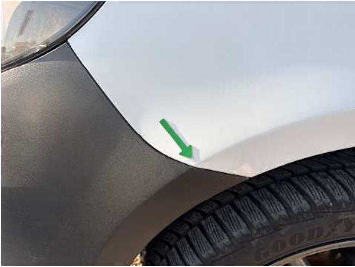
Kotflügel vorne links (Kratzer)
