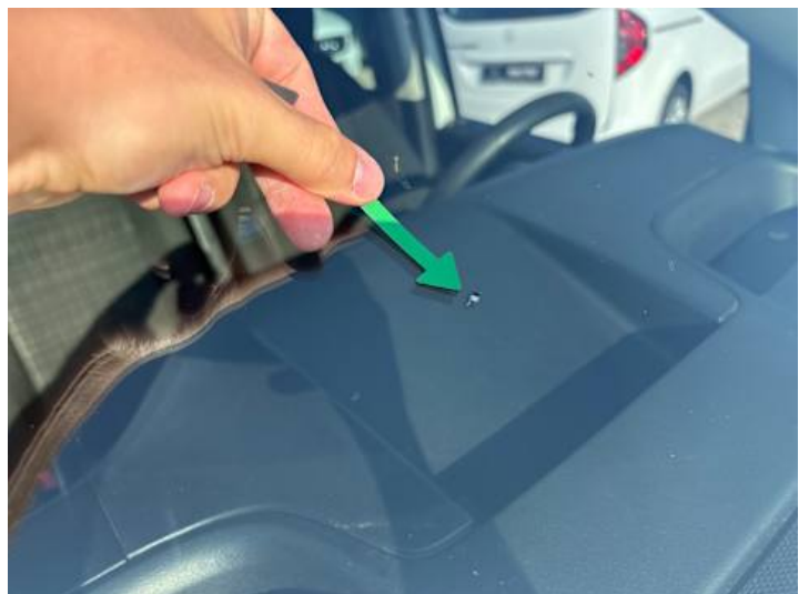
Windschutzscheibe (Riss/Bruch, Steinschlag)
