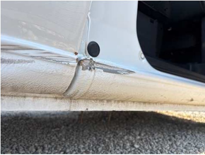
Schweller rechts (Verformung, Kratzer, Lackschaden, Rost)
