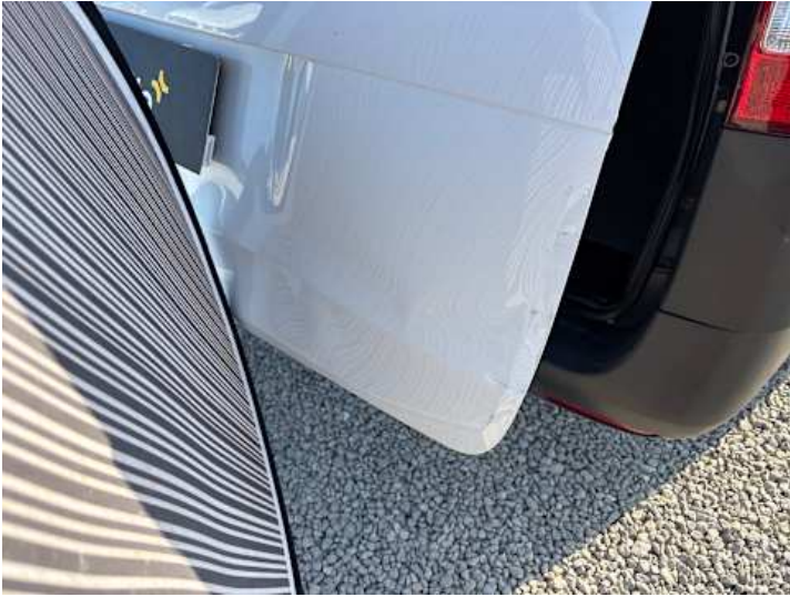
Heckklappe (Verformung, Lackschaden, Kratzer, Rost)
