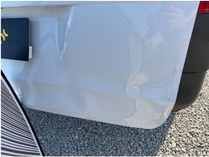
Heckklappe (Verformung, Lackschaden, Kratzer, Rost)
