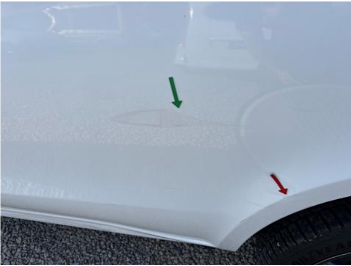
Seitenteil hinten links (Kratzer, Lackschaden, Verformung)
