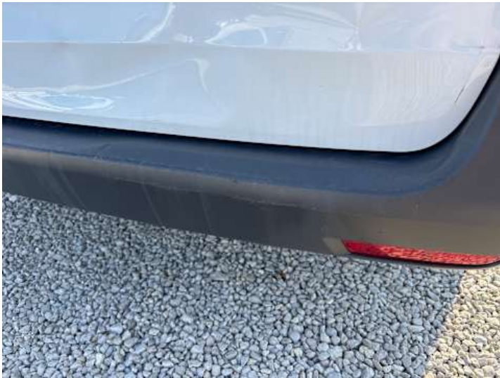
Stoßstange hinten (Verformung, Kratzer, Riss/Bruch)
