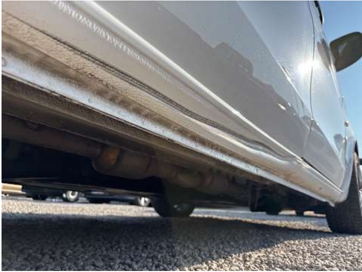
Schweller rechts (Verformung, Kratzer, Lackschaden, Rost)
