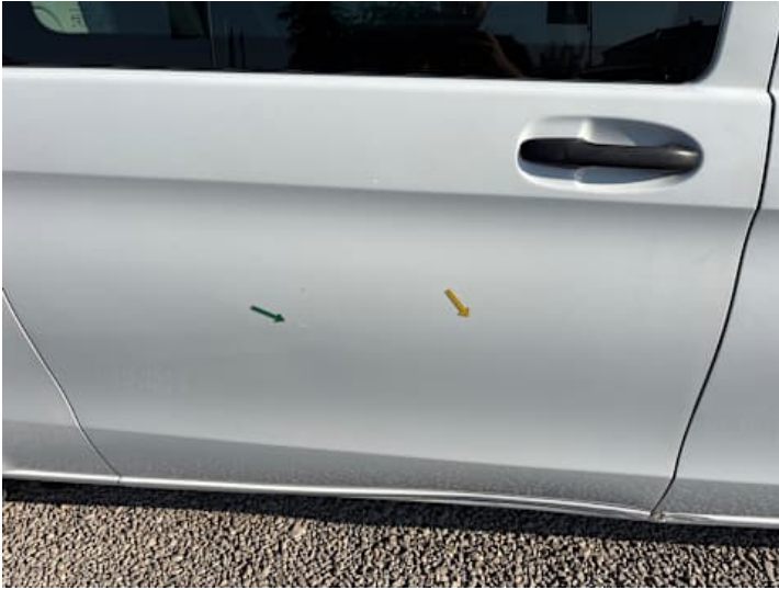
Türe hinten rechts (Kratzer, Lackschaden)
