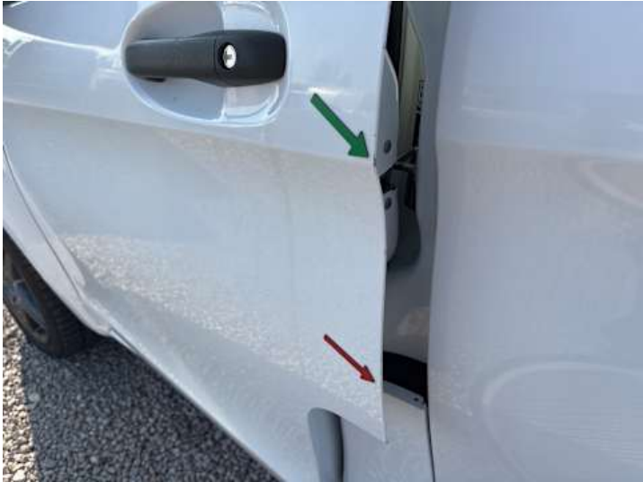
Fahrtür (Lackschaden, Rost)
