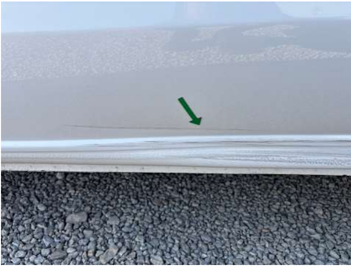
Seitenteil hinten links (Kratzer, Lackschaden, Verformung)
