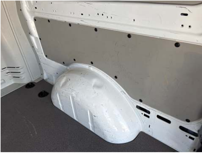
Innenraum (Verschmutzung, Kratzer, Anderer Schaden): Dellen
