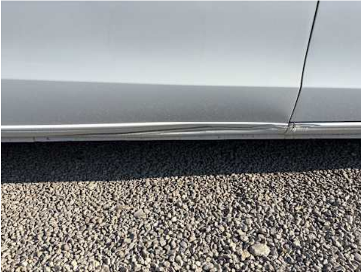
Schweller rechts (Verformung, Kratzer, Lackschaden, Rost)
