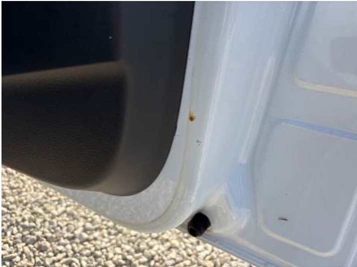
Beifahrtür (Kratzer, Lackschaden, Rost, Delle)
