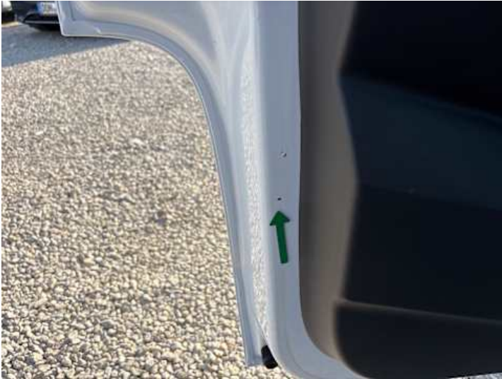
Fahrtür (Lackschaden, Rost)
