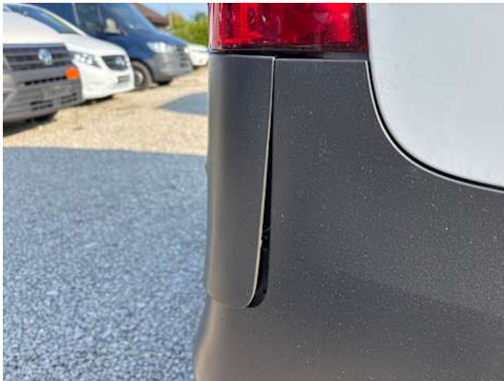
Stoßstange hinten (Verformung, Kratzer, Riss/Bruch)
