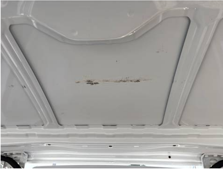
Innenraum (Verschmutzung, Kratzer, Anderer Schaden): Dellen
