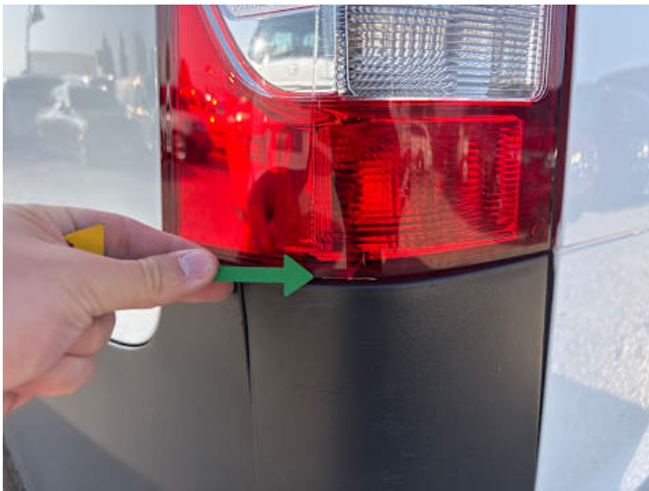
Rücklicht (links) (Kratzer, Riss/Bruch)
