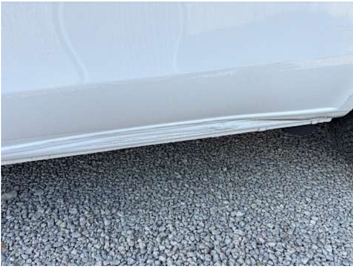
Schweller links (Verformung, Kratzer, Lackschaden)
