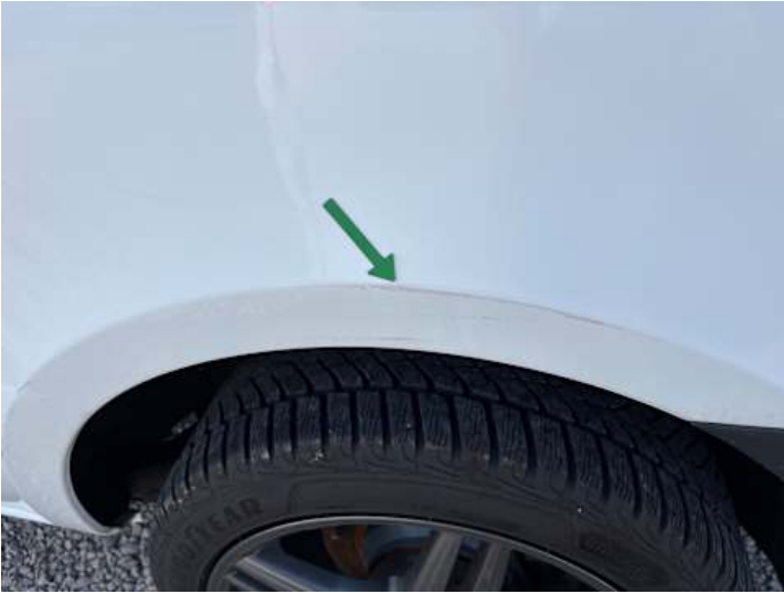
Seitenteil hinten links (Kratzer, Lackschaden, Verformung)
