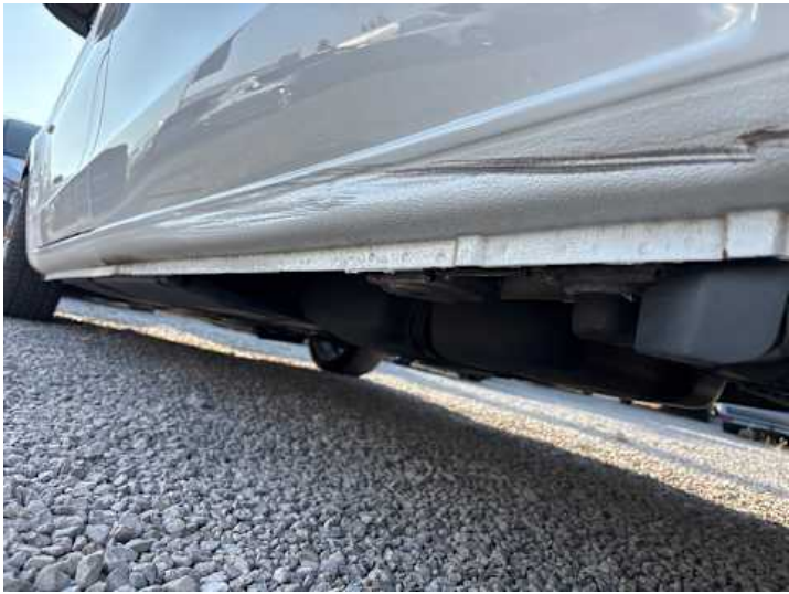
Schweller links (Verformung, Kratzer, Lackschaden)
