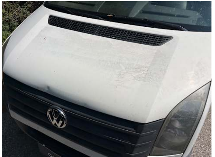
Motorhaube (Verformung, Lackschaden, Ausgeblichen/Matt)
