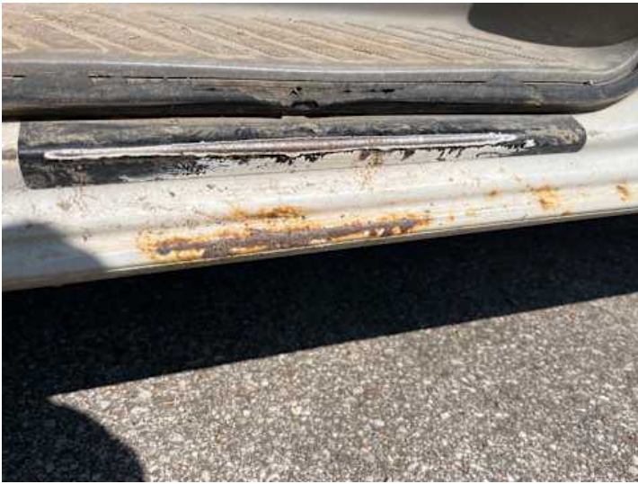
Schweller links (Rost, Lackschaden)
