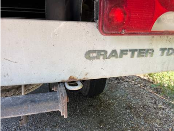
Stoßstange hinten (Lackschaden, Rost)
