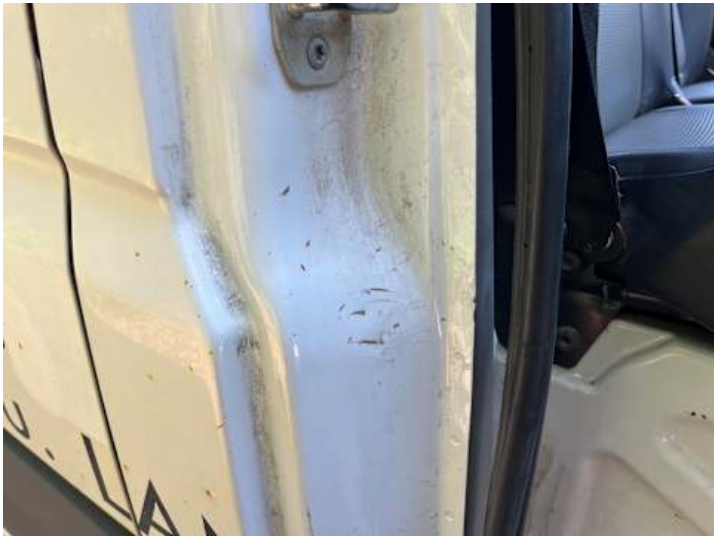
Beifahrertür (Kratzer, Lackschaden, Delle)
