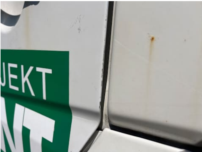
Fahrtür (Rost, Lackschaden)
