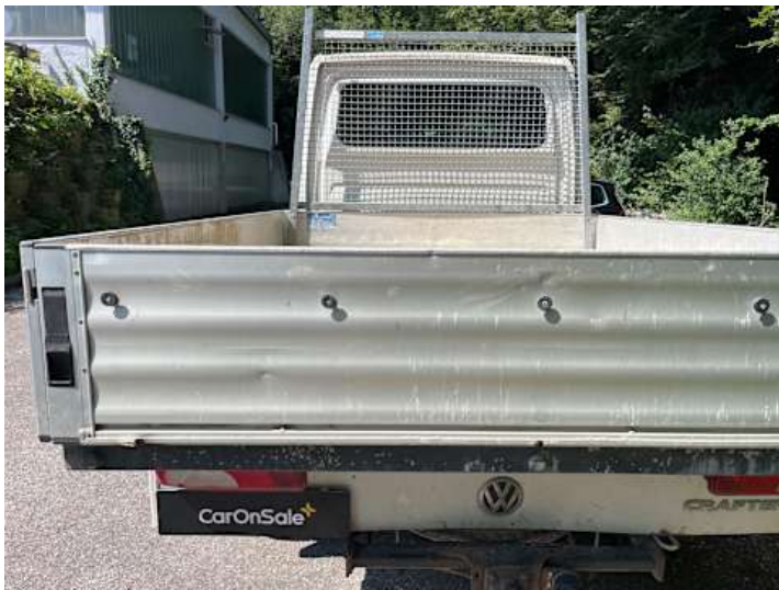
Heckklappe (Kratzer, Delle)
