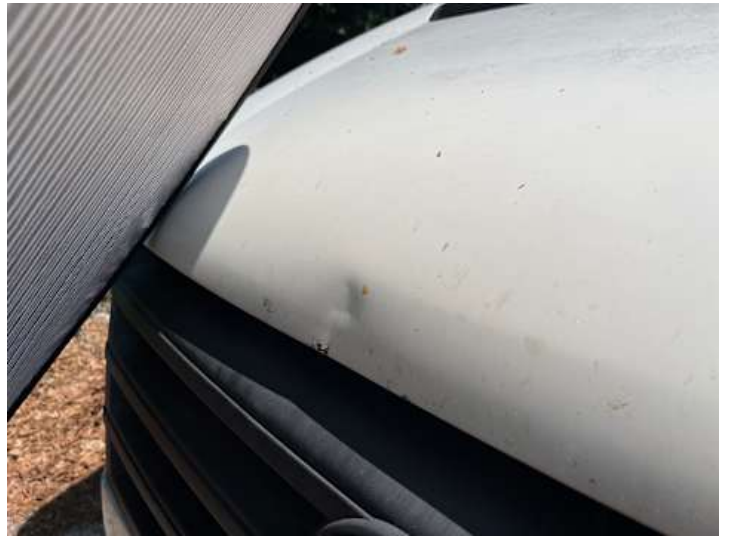
Motorhaube (Verformung, Lackschaden, Ausgeblichen/Matt)
