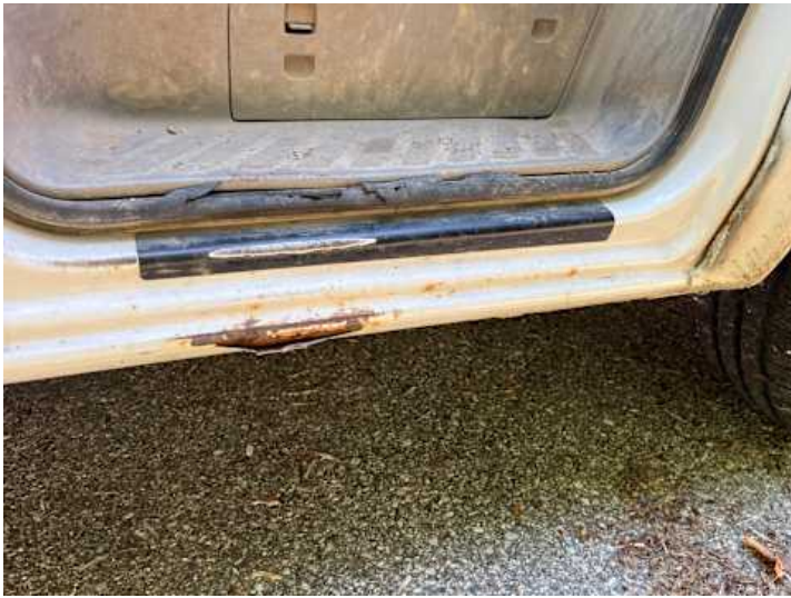
Schweller rechts (Rost, Lackschaden)
