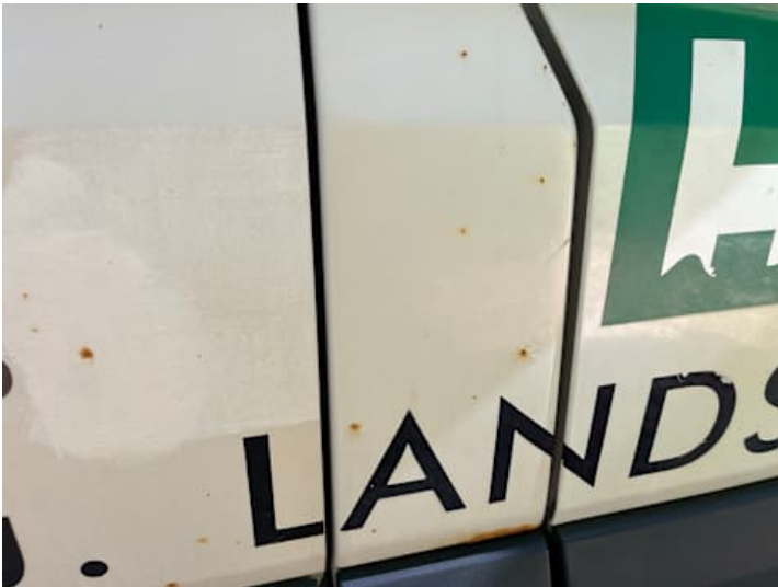
Beifahrertür (Rost, Lackschaden)
