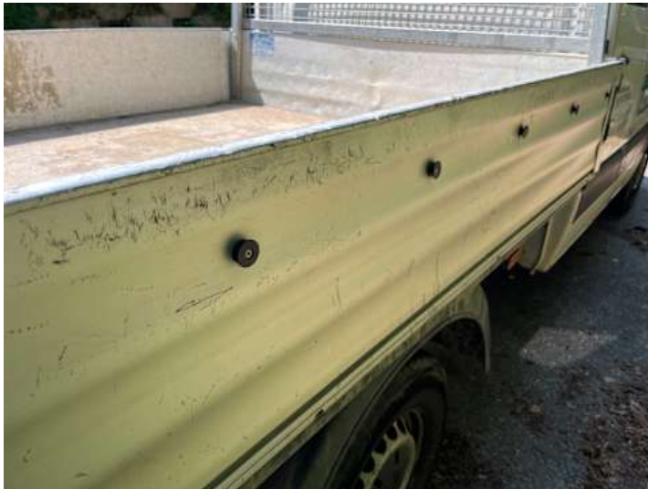
Seitenteil hinten rechts (Kratzer, Lackschaden, Delle)
