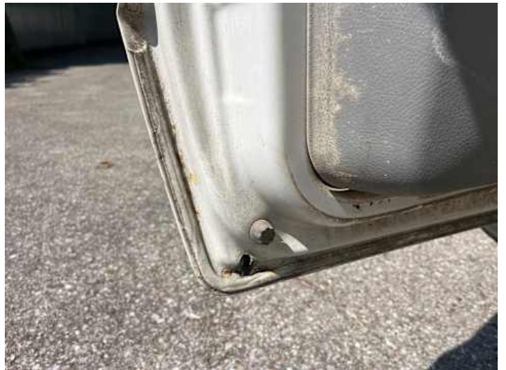
Fahrtür (Rost, Lackschaden)
