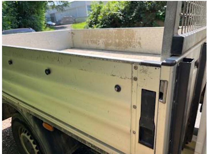
Seitenteil hinten rechts (Kratzer, Lackschaden, Delle)
