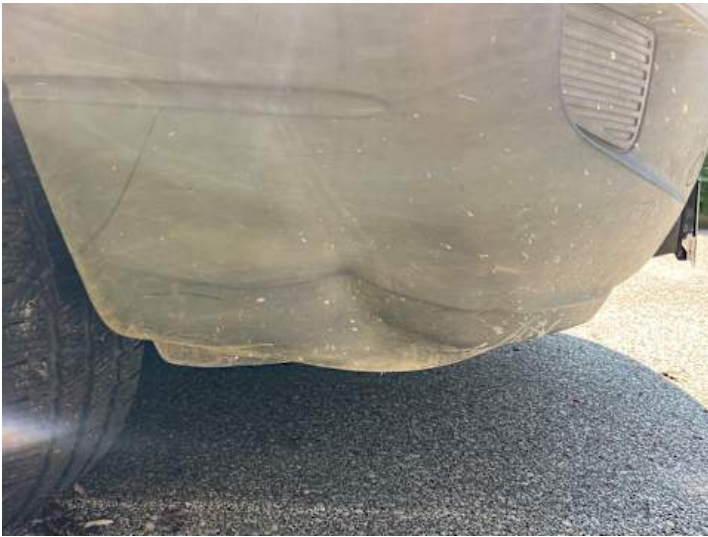
Stoßstange vorne (Kratzer, Verformung)
