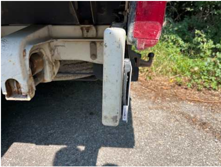
Stoßstange hinten (Lackschaden, Rost)
