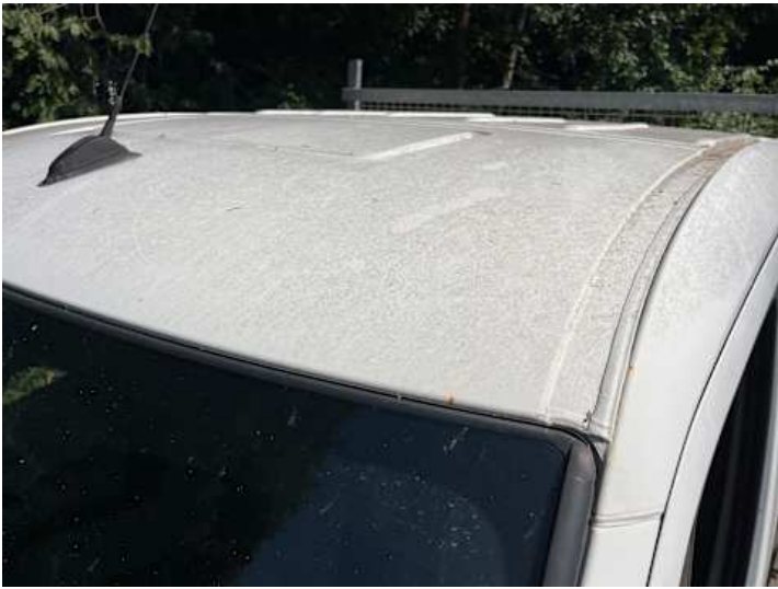
Dach (Ausgeblichen/Matt, Lackschaden)
