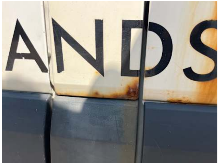
Fahrtür (Rost, Lackschaden)
