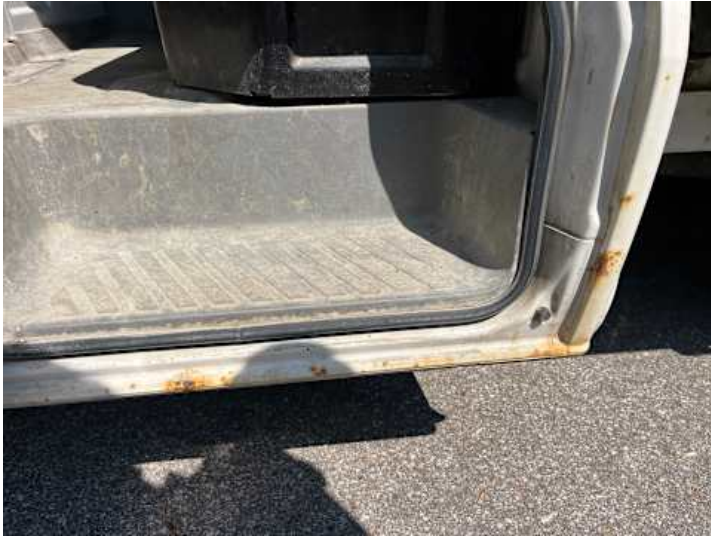
Schweller links (Rost, Lackschaden)
