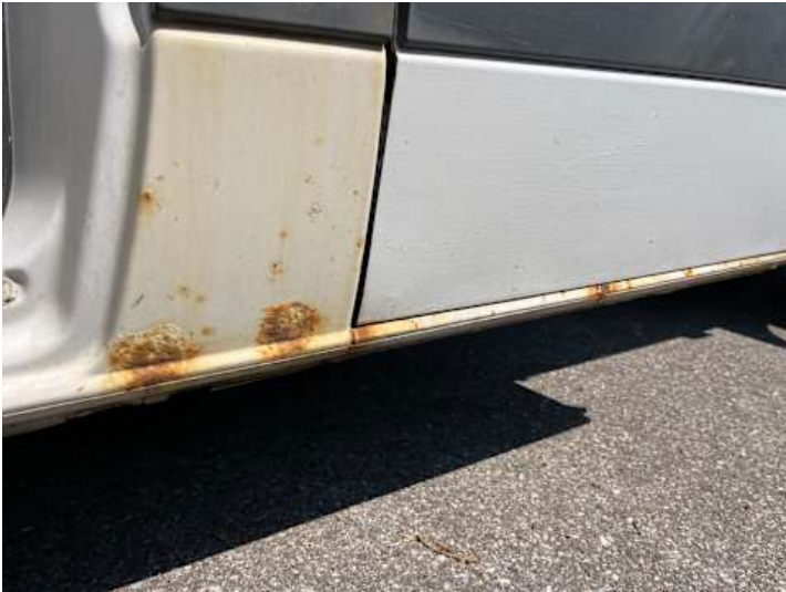
Schweller links (Rost, Lackschaden)
