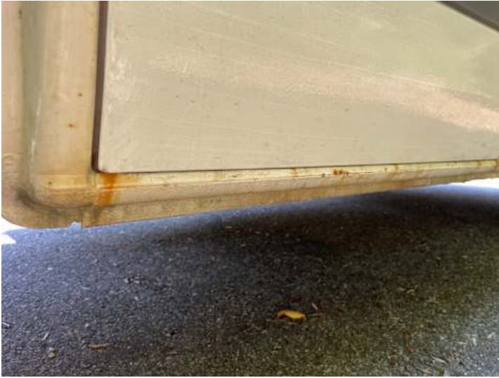
Schweller rechts (Rost, Lackschaden)
