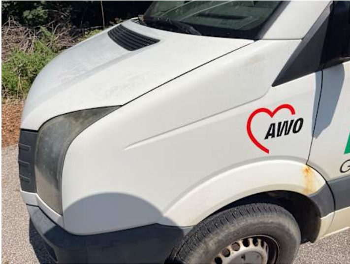
Kotflügel vorne links (Lackschaden, Rost, Ausgeblichen/Matt)
