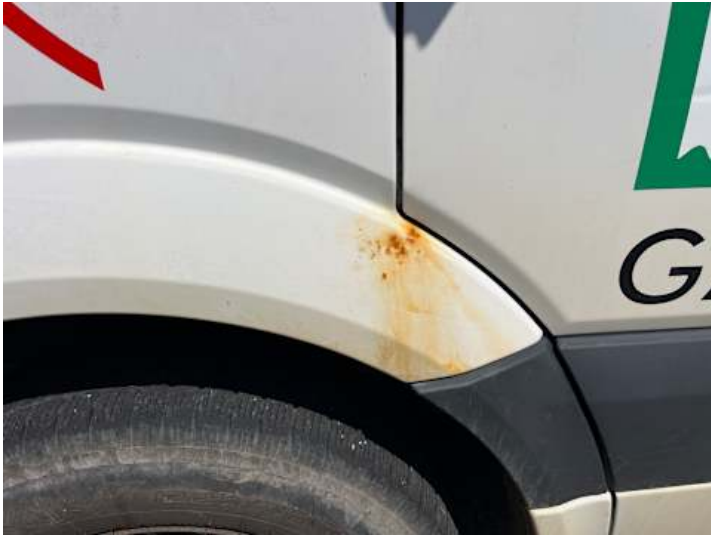
Kotflügel vorne links (Lackschaden, Rost, Ausgeblichen/Matt)
