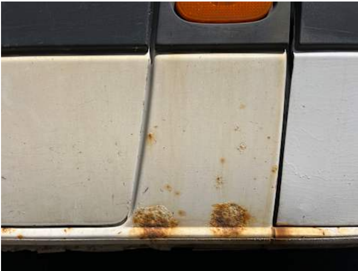
Fahrtür (Rost, Lackschaden)
