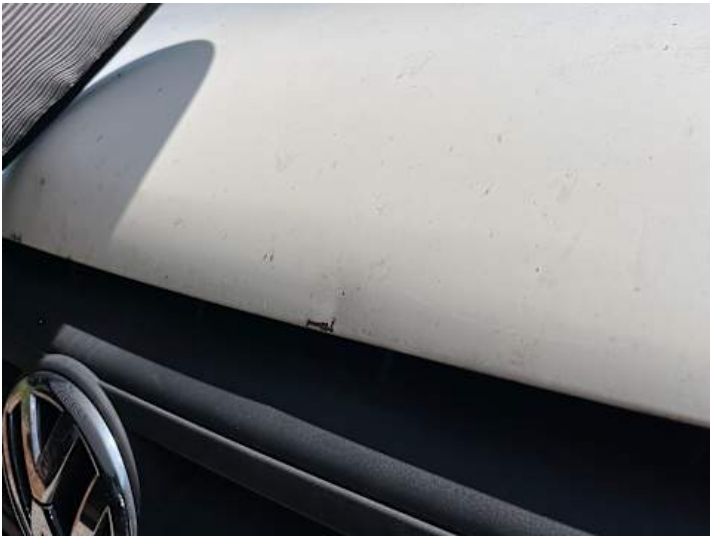
Motorhaube (Verformung, Lackschaden, Ausgeblichen/Matt)
