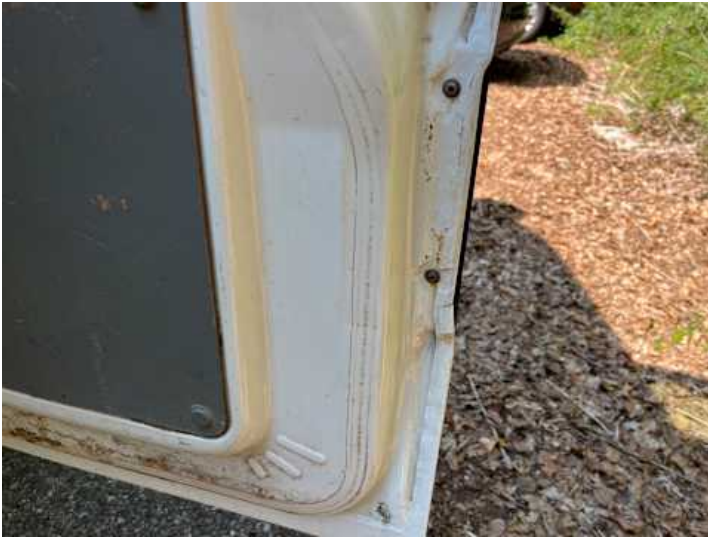
Türe hinten rechts (Lackschaden, Rost, Unsachgemäß instand gesetzt)
