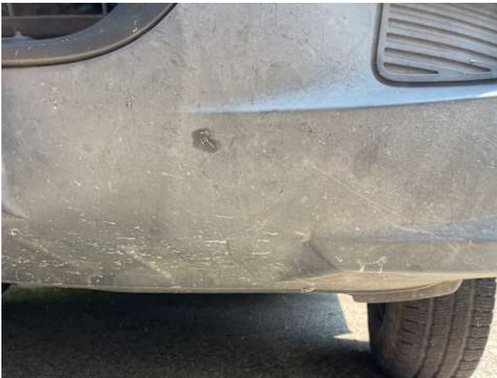
Stoßstange vorne (Kratzer, Verformung)
