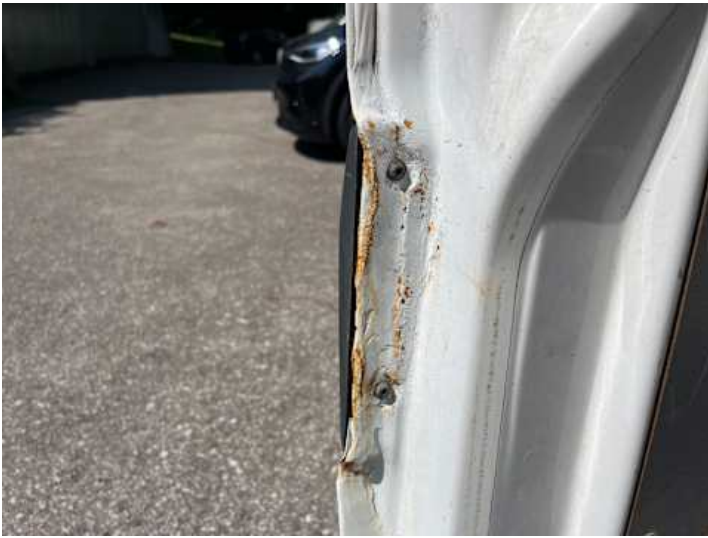
Türe hinten links (Lackschaden, Rost, Unsachgemäß instand gesetzt)
