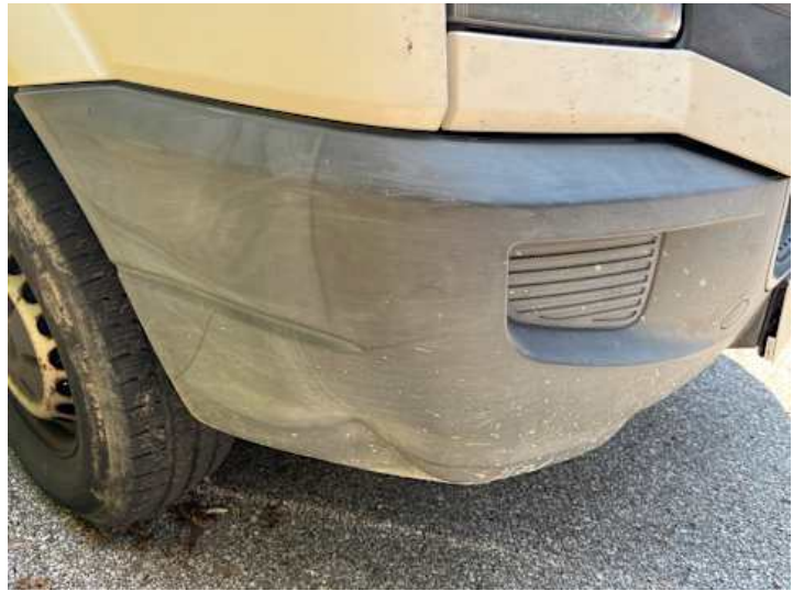
Stoßstange vorne (Kratzer, Verformung)
