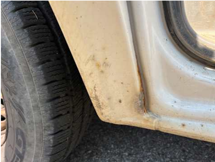
Schweller links (Rost, Lackschaden)
