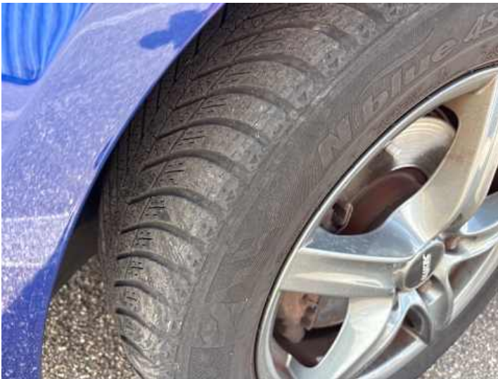
Rad (vehicle.damage-label.porous, Ungleichmäßig abgefahren)
