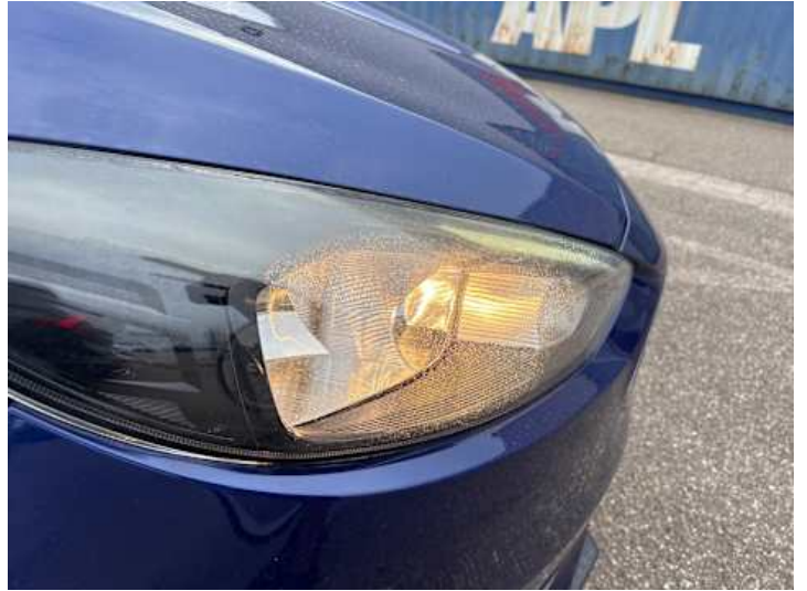
Scheinwerfer (rechts) (Anderer Schaden): Porös
