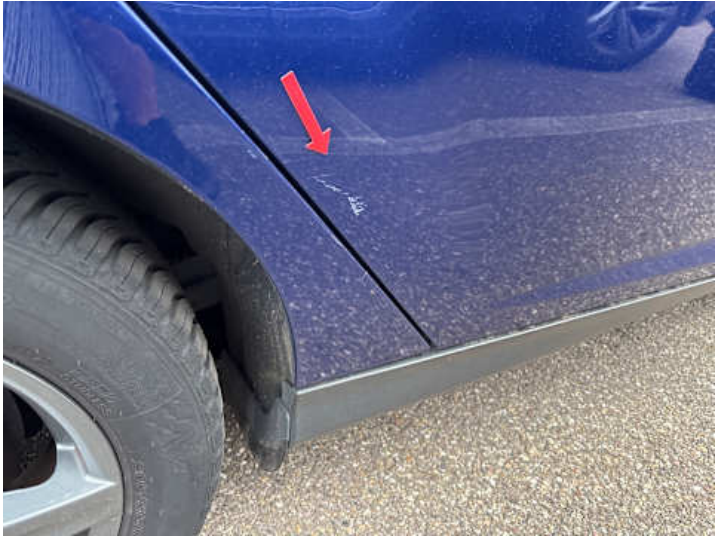
Türe hinten rechts (Kratzer)
