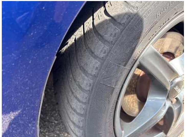
Rad (vehicle.damage-label.porous, Ungleichmäßig abgefahren)
