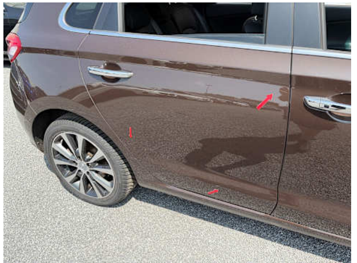
Türe hinten rechts (Kratzer, Delle)
