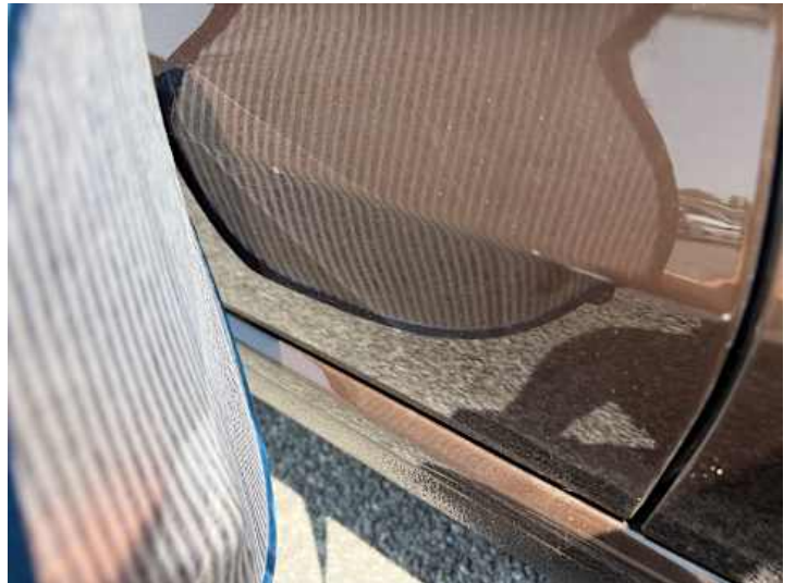
Türe hinten rechts (Kratzer, Delle)
