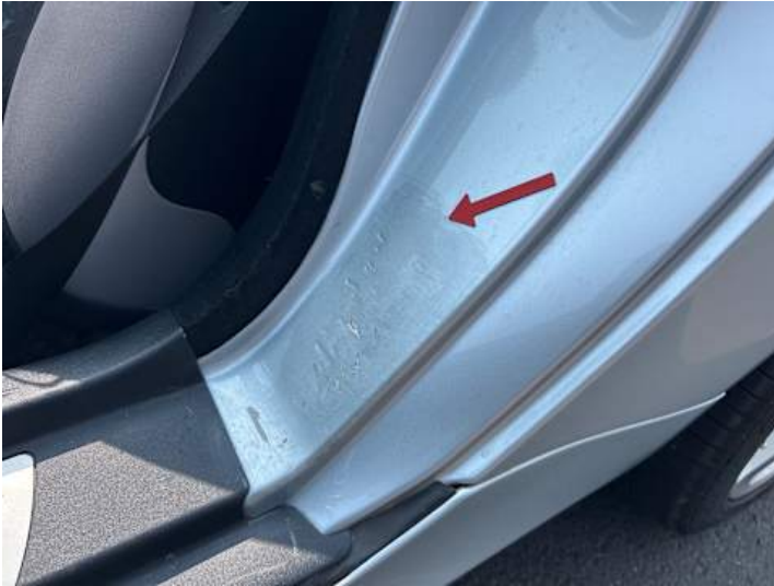
Fahrtür (Kratzer, Delle, Unsachgemäß instand gesetzt)
