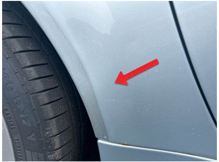
Seitenteil hinten rechts (Unsachgemäß instand gesetzt)
