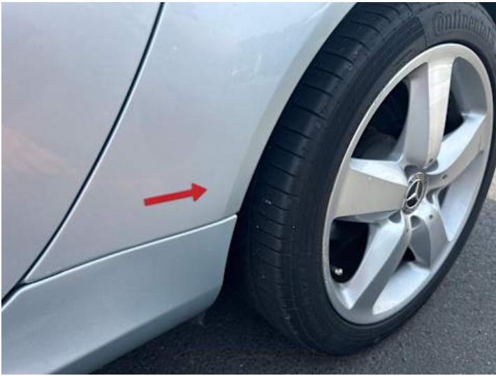
Seitenteil hinten links (Unsachgemäß instand gesetzt)
