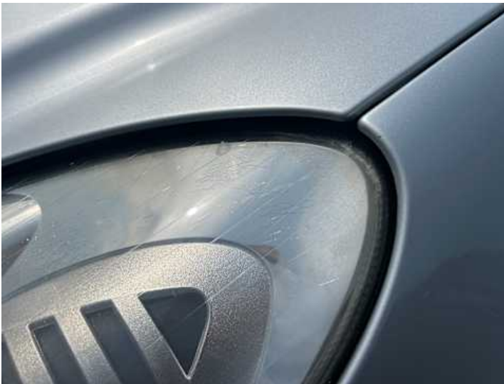
Scheinwerfer (links) (Riss/Bruch)
