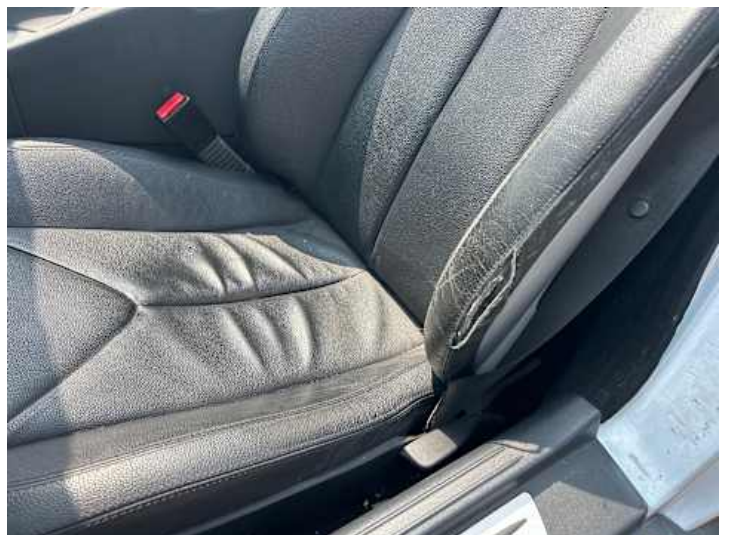
Innenraum (Verschleiß, Riss/Bruch)
