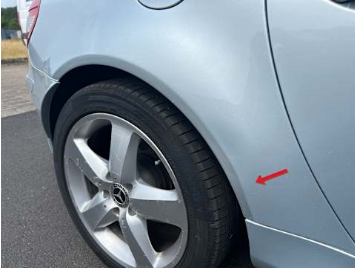
Seitenteil hinten rechts (Unsachgemäß instand gesetzt)
