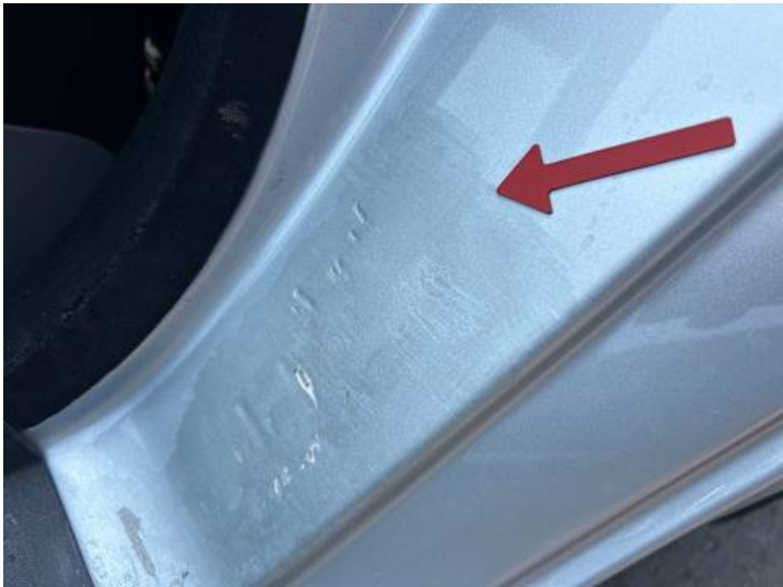
Fahrtür (Kratzer, Delle, Unsachgemäß instand gesetzt)
