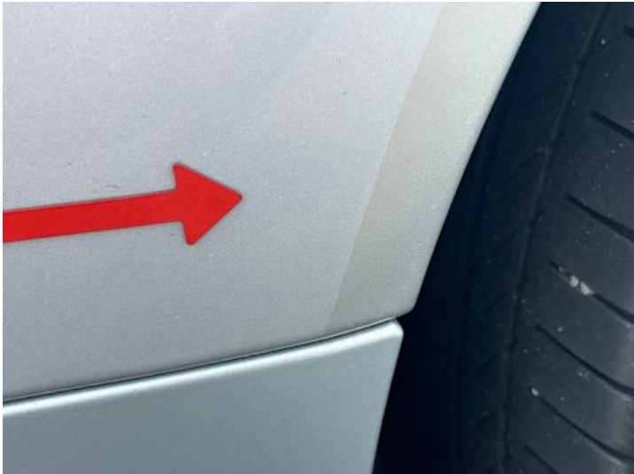
Seitenteil hinten links (Unsachgemäß instand gesetzt)
