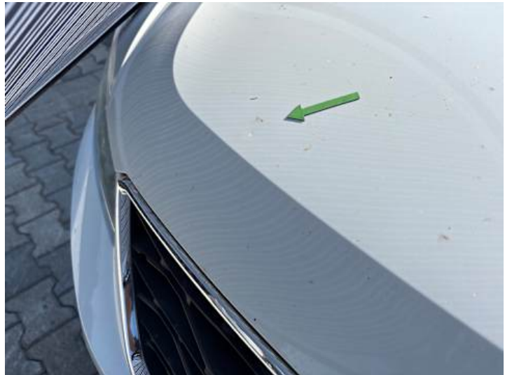
Motorhaube (Steinschlag, Delle)
