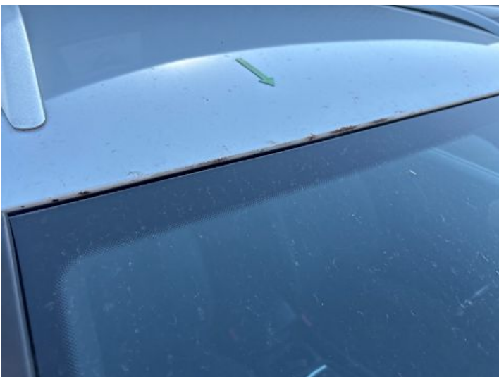
Dach (Lackschaden, Rost)
