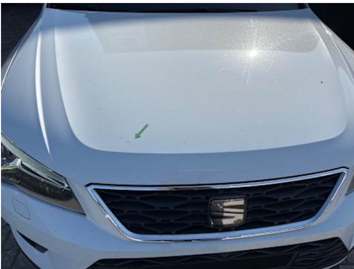
Motorhaube (Steinschlag, Delle)
