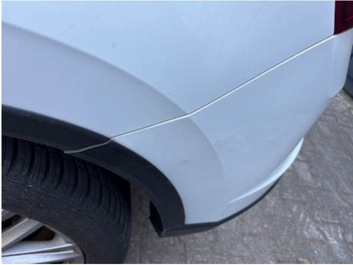
Stoßstange hinten (Lackschaden, Spaltmaße ungenau)
