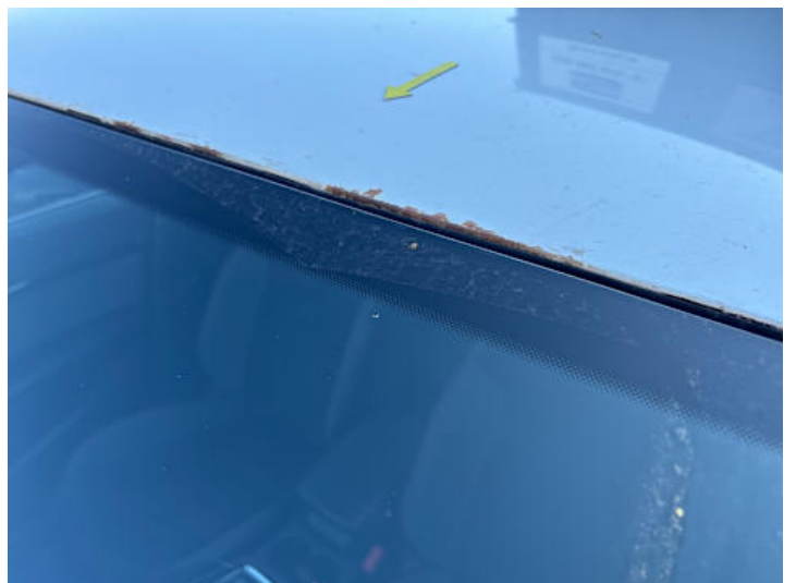
Dach (Lackschaden, Rost)
