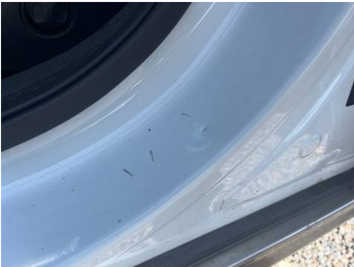
Schweller links (Lackschaden, Kratzer, Delle)
