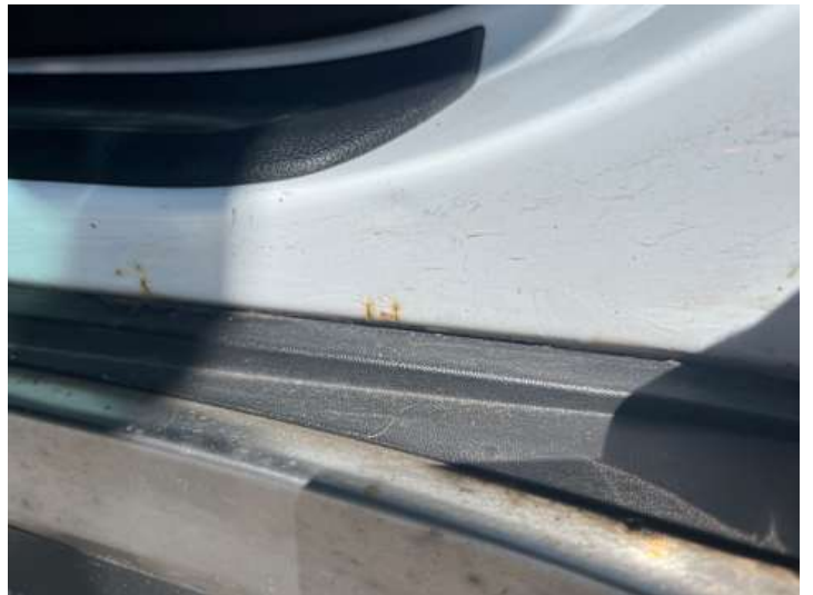
Schweller links (Rost)
