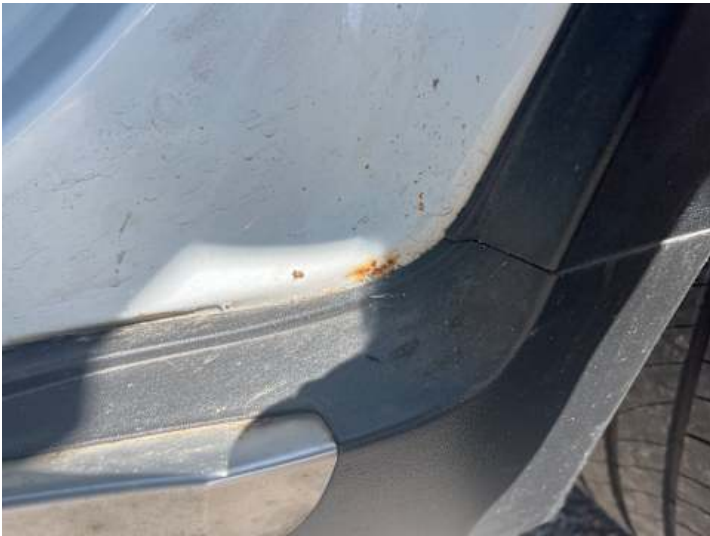
Schweller links (Rost)
