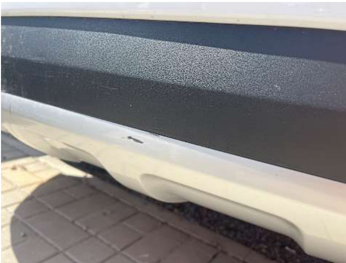
Stoßstange hinten (Lackschaden, Kratzer)
