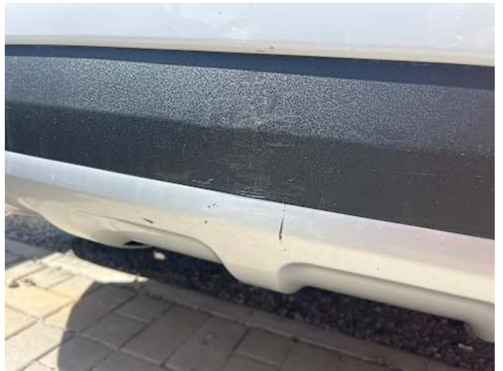
Stoßstange hinten (Lackschaden, Kratzer)
