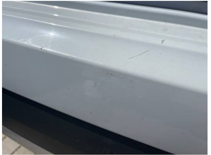
Stoßstange hinten (Lackschaden, Unsachgemäß instand gesetzt)
