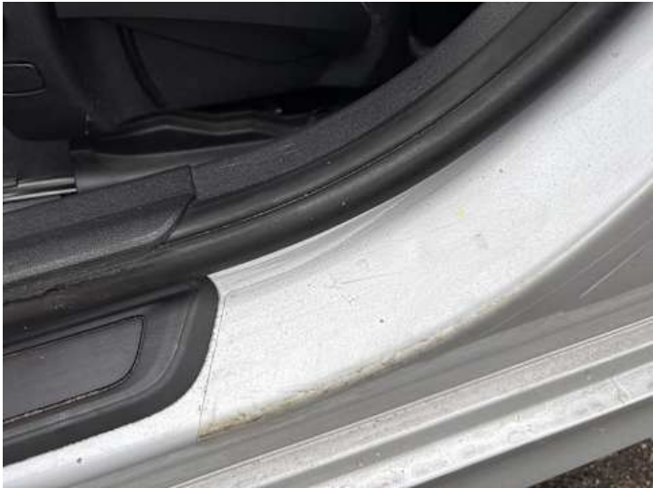
Schweller links (Kratzer, Delle)
