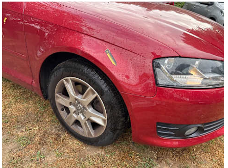
Kotflügel vorne rechts (Lackschaden)
