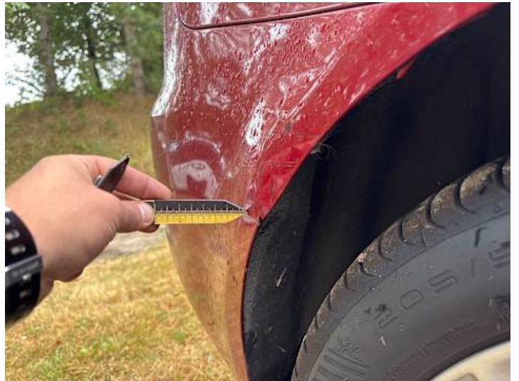
Stoßstange hinten (Riss/Bruch)
