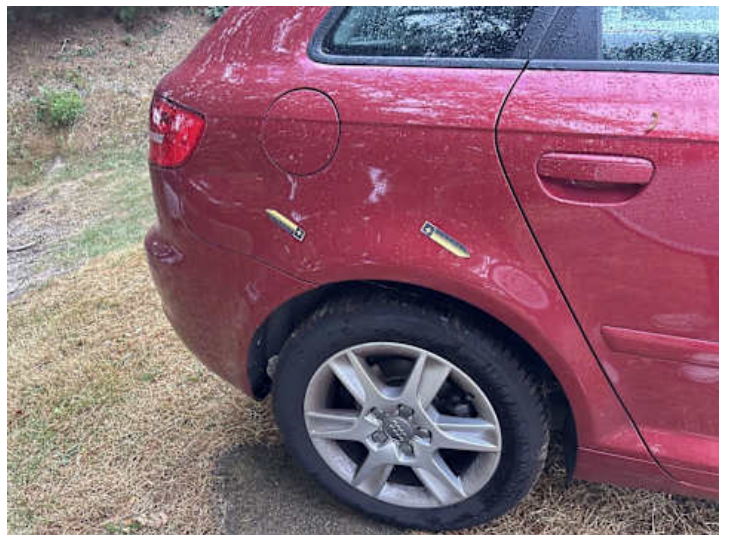
Seitenteil hinten rechts (Lackschaden, Verformung)
