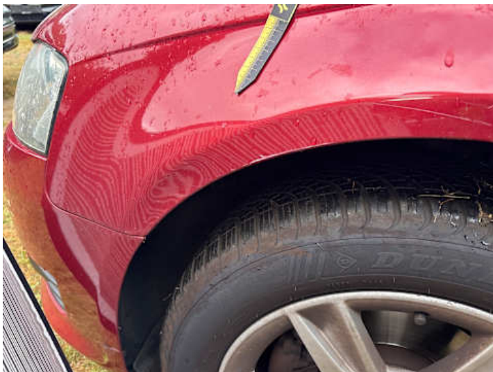
Kotflügel vorne links (Lackschaden, Verformung)
