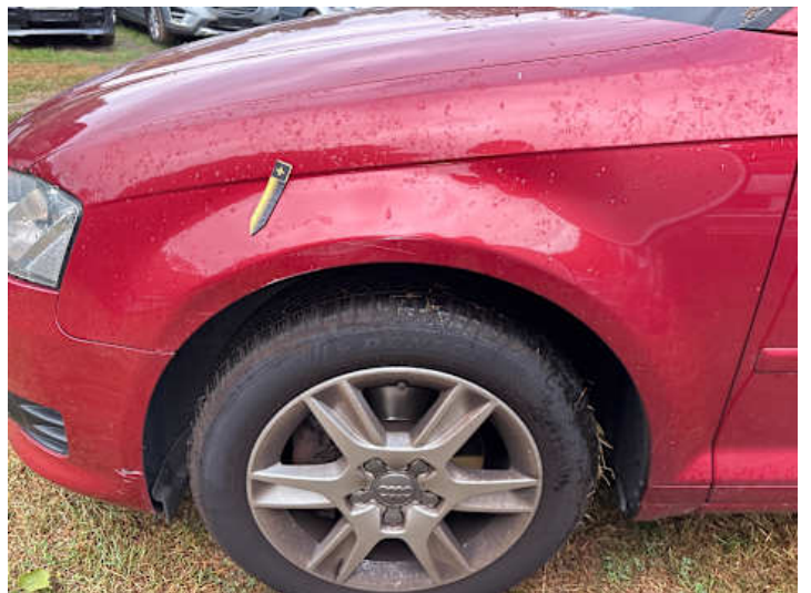
Kotflügel vorne links (Lackschaden, Verformung)
