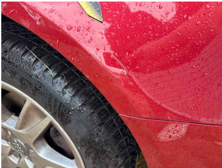
Kotflügel vorne rechts (Lackschaden)
