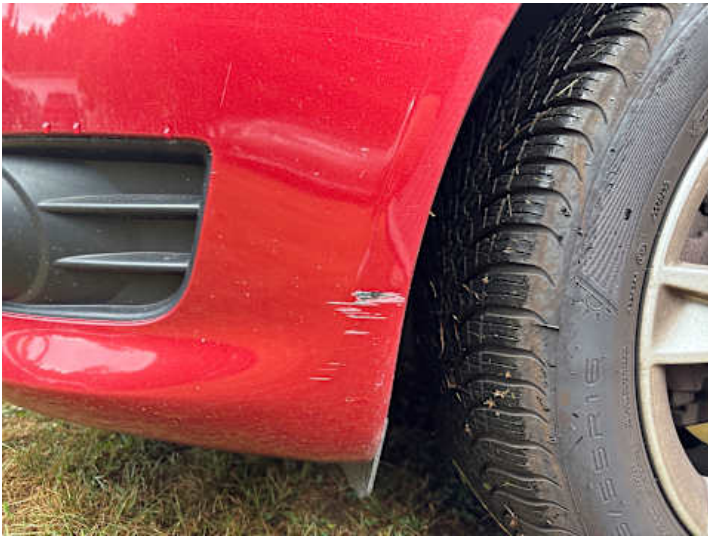
Stoßstange vorne (Lackschaden, Verformung)
