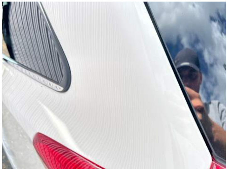
Seitenteil hinten links (Unsachgemäß instand gesetzt)
