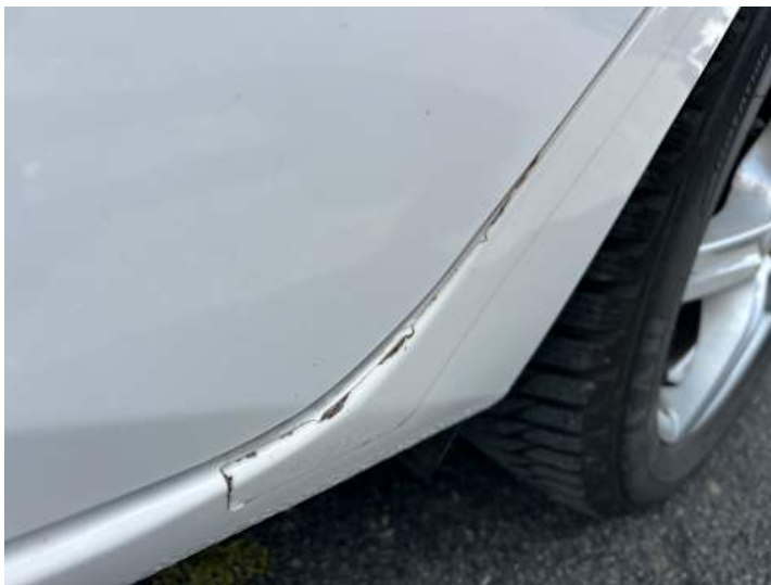
Seitenteil hinten links (Unsachgemäß instand gesetzt)
