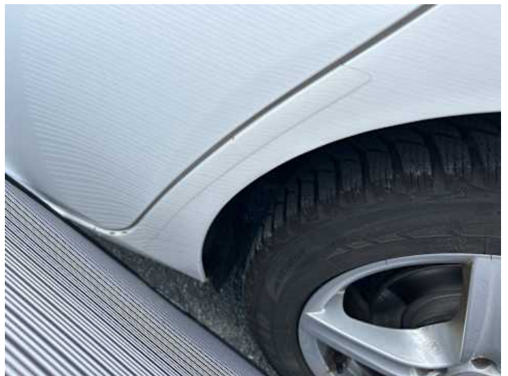
Seitenteil hinten links (Unsachgemäß instand gesetzt)
