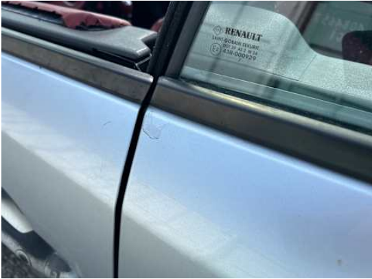
Seitenteil hinten links (Lackschaden)
