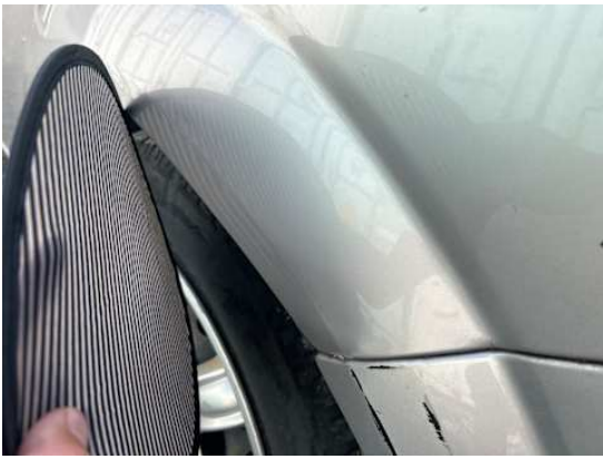
Seitenteil hinten links (Kratzer, Verformung)
