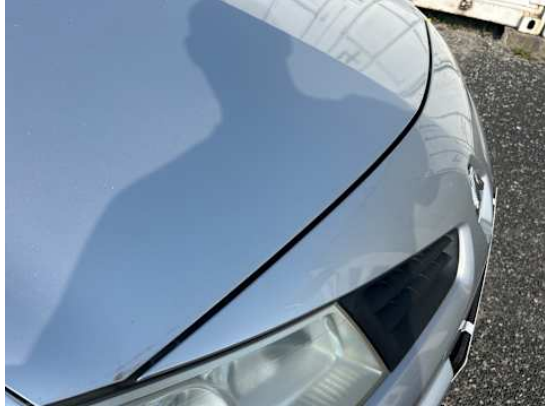
Motorhaube (Spaltmaße ungenau)
