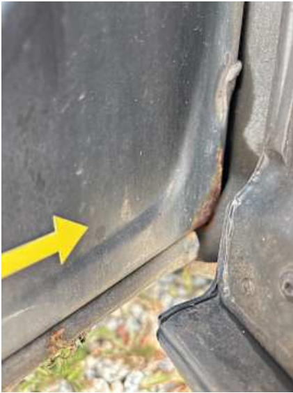
Schweller rechts (Rost)
