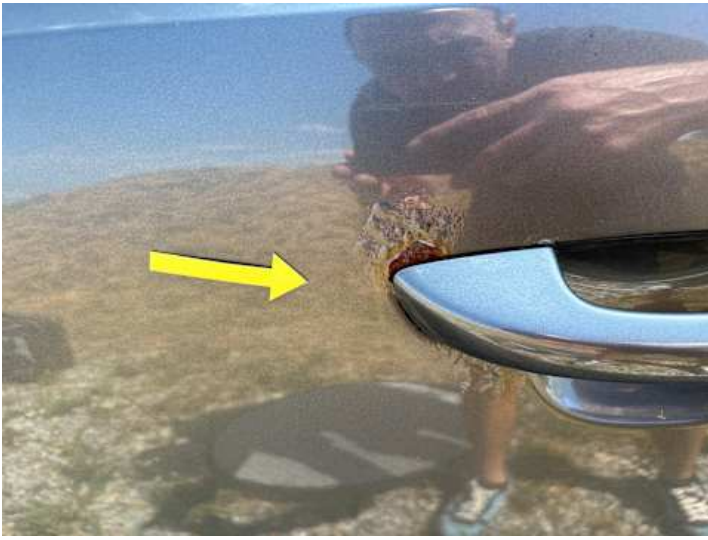
Fahrtür (Delle, Rost)
