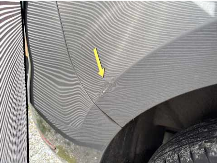
Seitenteil hinten rechts (Delle, Rost)
