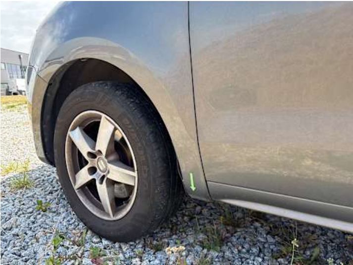
Kotflügel vorne links (Rost)
