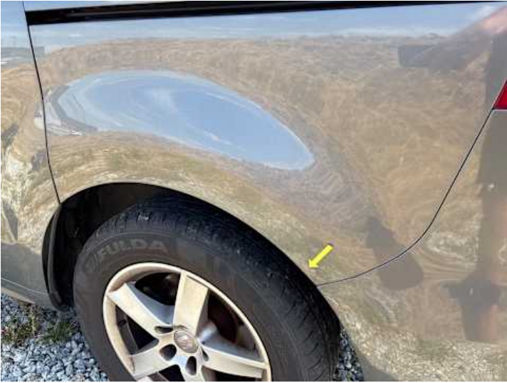
Seitenteil hinten links (Rost)
