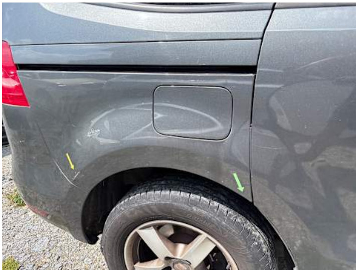
Seitenteil hinten rechts (Delle, Rost)
