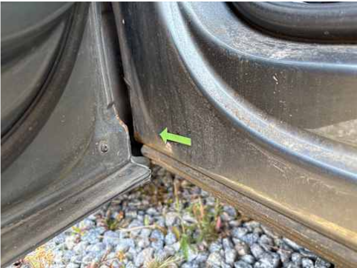
Schweller links (Rost)
