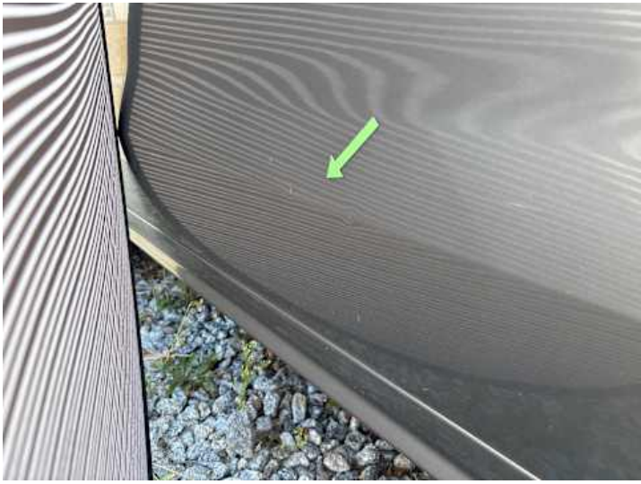
Fahrtür (Delle, Rost)
