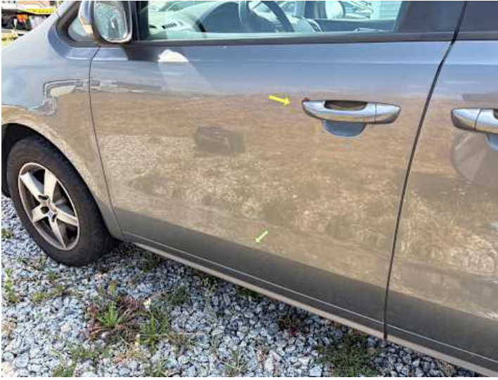
Fahrtür (Delle, Rost)
