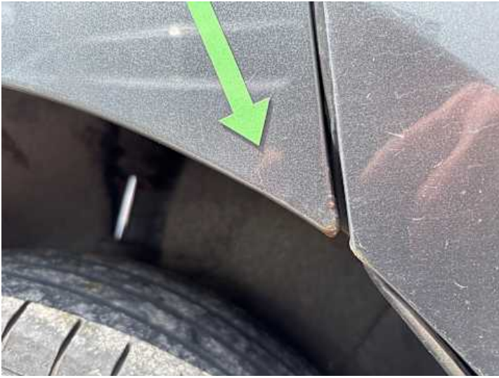
Seitenteil hinten rechts (Delle, Rost)
