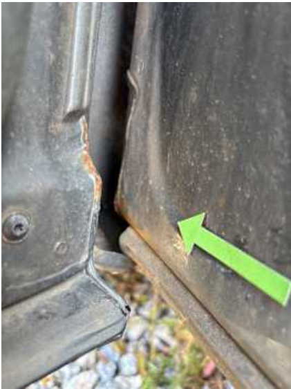
Schweller links (Rost)
