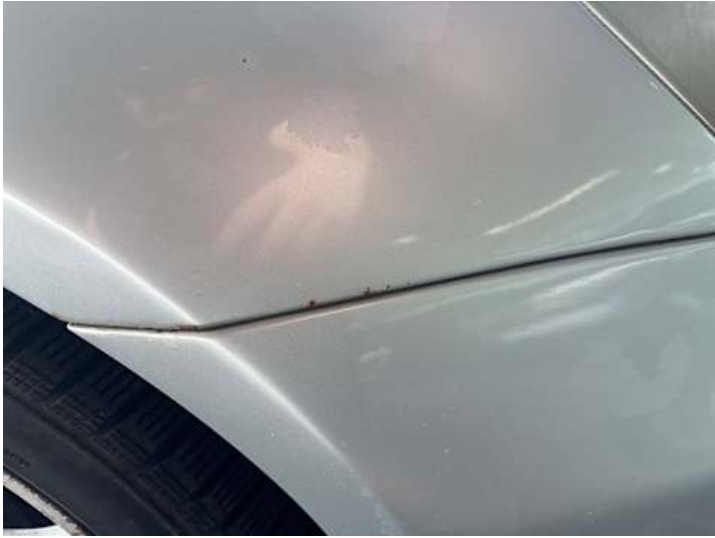
Kotflügel vorne rechts (Rost, Unsachgemäß instand gesetzt)
