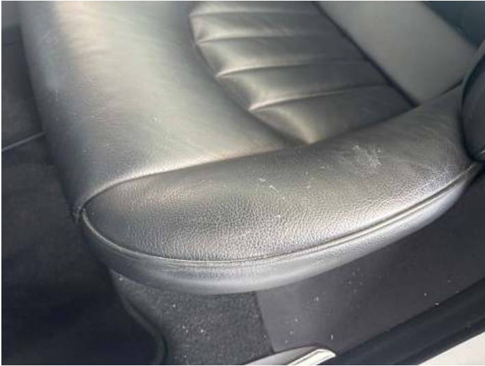
Innenraum (Verschmutzung, Verschleiß)
