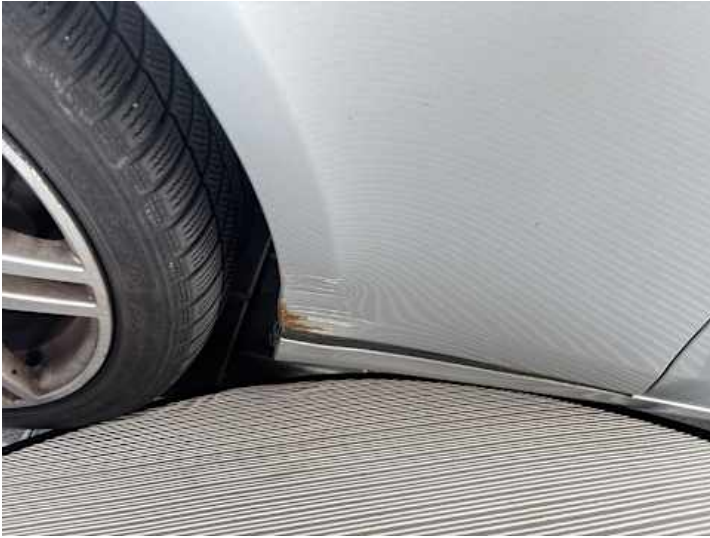
Kotflügel vorne links (Verformung, Kratzer, Rost, Spaltmaße ungenau)
