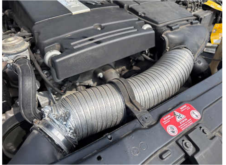
Innenraum (Riss/Bruch, Anderer Schaden): Rohrleitung nicht original!
