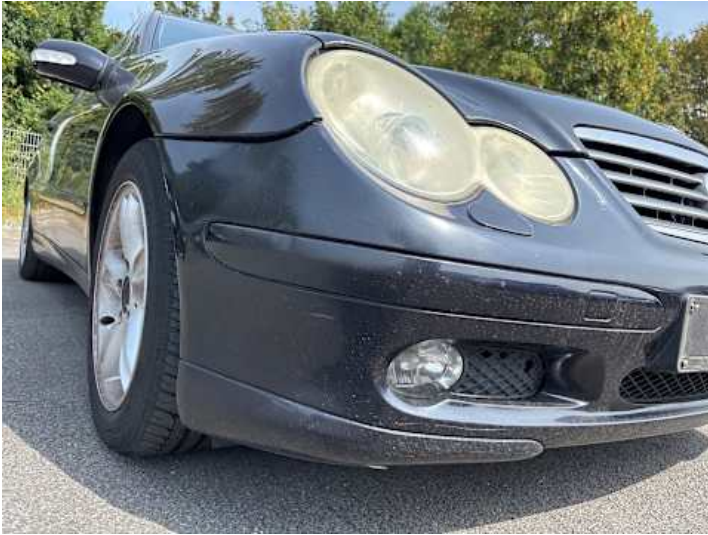
Stoßstange vorne (Kratzer, Delle, Lackschaden, Spaltmaße ungenau)
