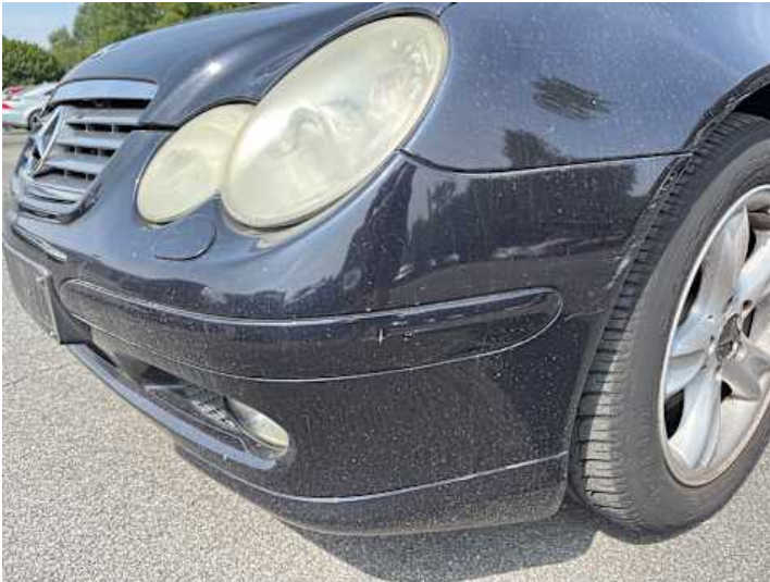
Stoßstange vorne (Kratzer, Delle, Lackschaden, Spaltmaße ungenau)
