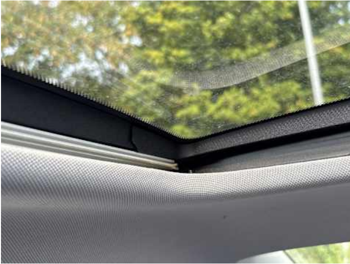
Innenraum (Anderer Schaden, Riss/Bruch): Schiebedach öffnet nicht
