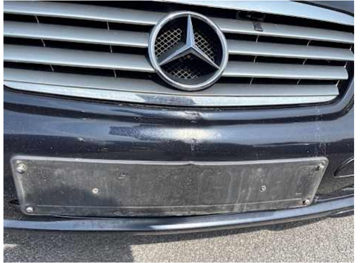
Stoßstange vorne (Kratzer, Delle, Lackschaden, Spaltmaße ungenau)
