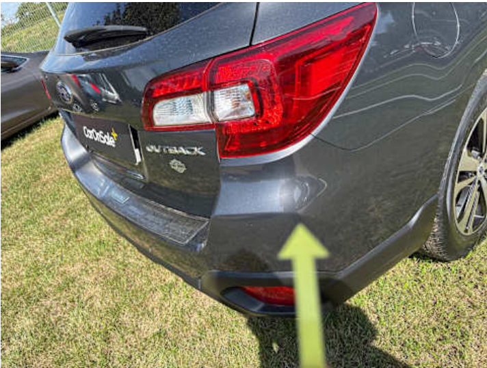
Stoßstange hinten (Kratzer)
