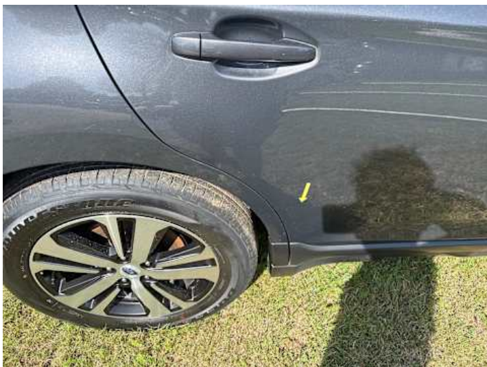
Türe hinten rechts (Kratzer, Delle)
