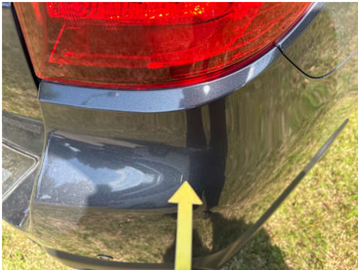
Stoßstange hinten (Kratzer)
