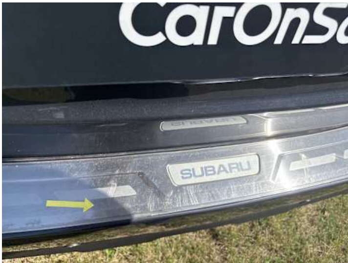
Stoßstange hinten (Kratzer)
