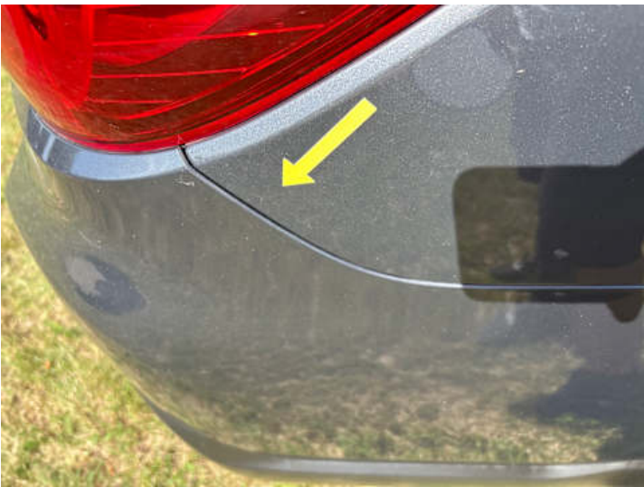
Stoßstange hinten (Spaltmaße ungenau)
