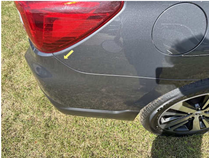
Stoßstange hinten (Spaltmaße ungenau)
