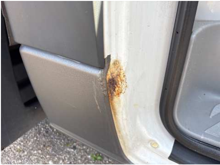
Seitenteil hinten rechts (Rost)
