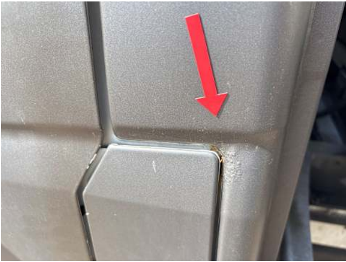
Seitenteil hinten links (Rost)
