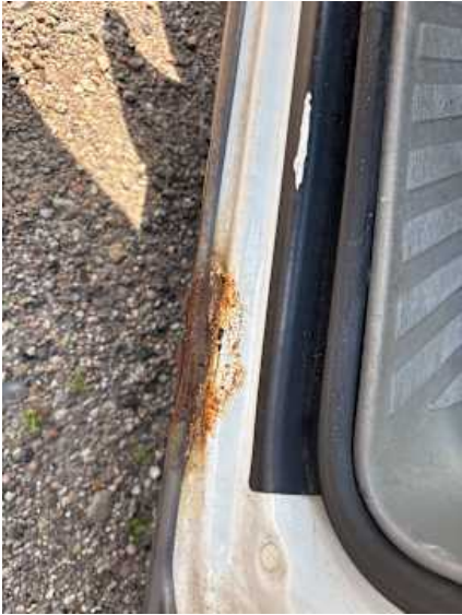
Schweller links (Rost)
