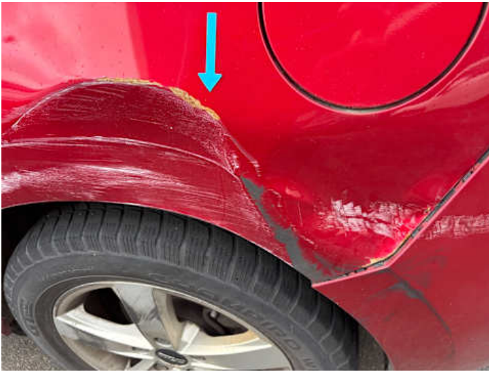
Seitenteil hinten links (Delle, Lackschaden, Rost)
