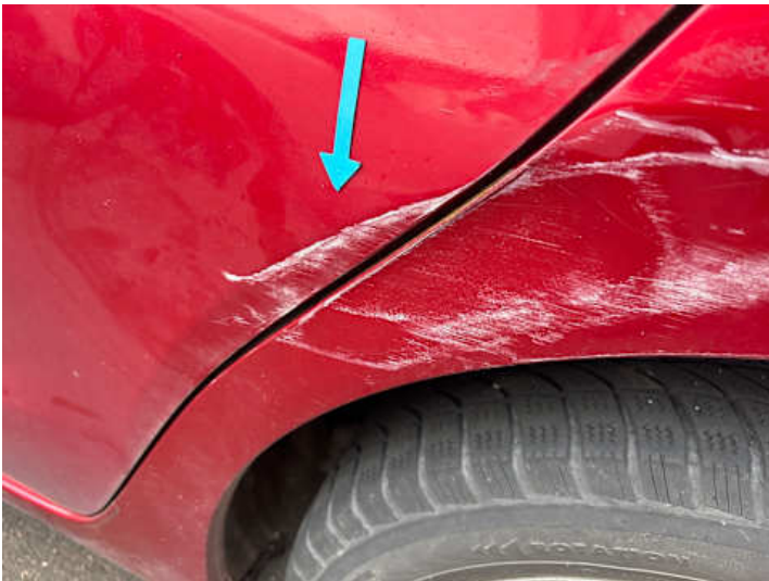
Türe hinten links (Delle, Lackschaden)
