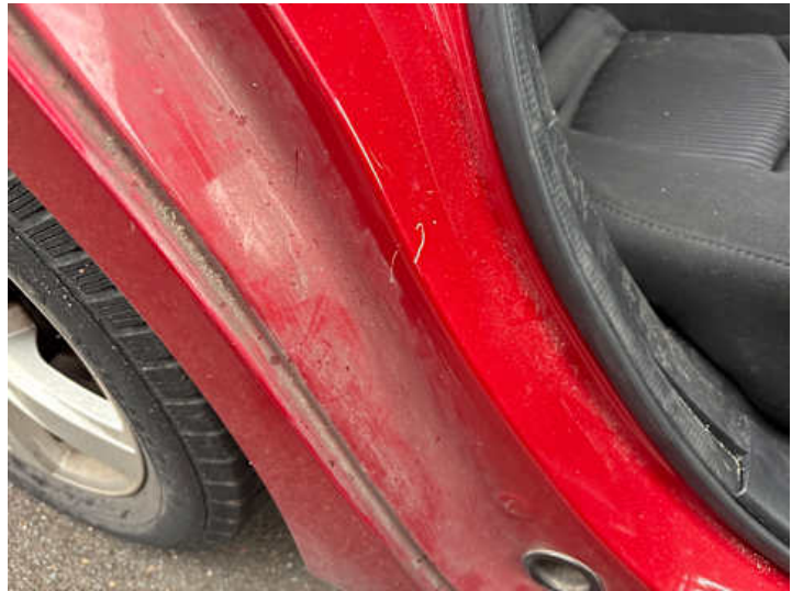
Seitenteil hinten rechts (Kratzer)
