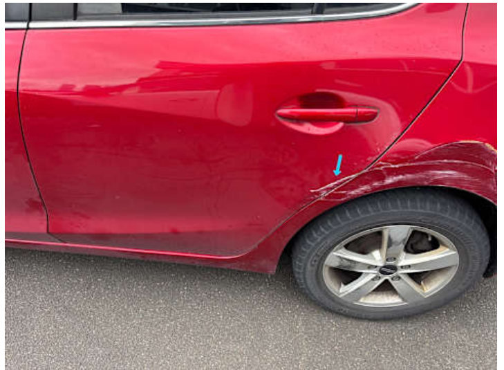
Türe hinten links (Delle, Lackschaden)
