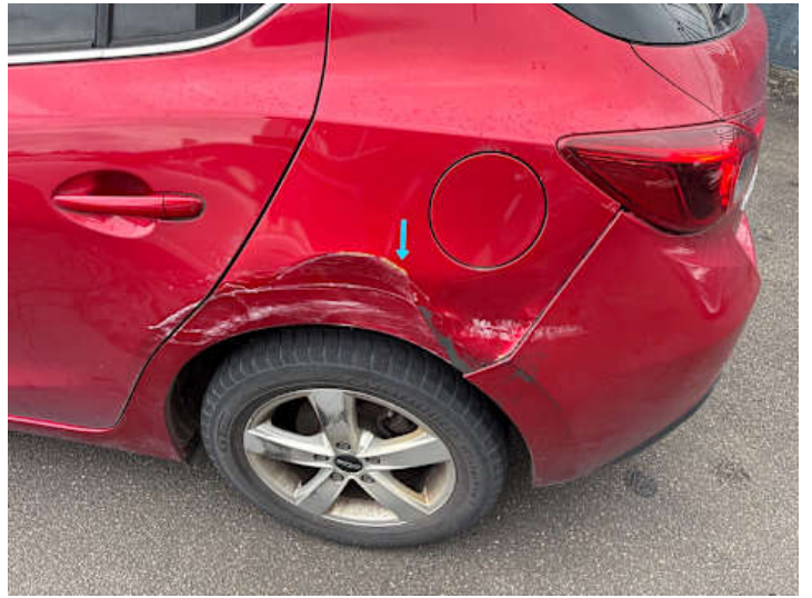
Seitenteil hinten links (Delle, Lackschaden, Rost)
