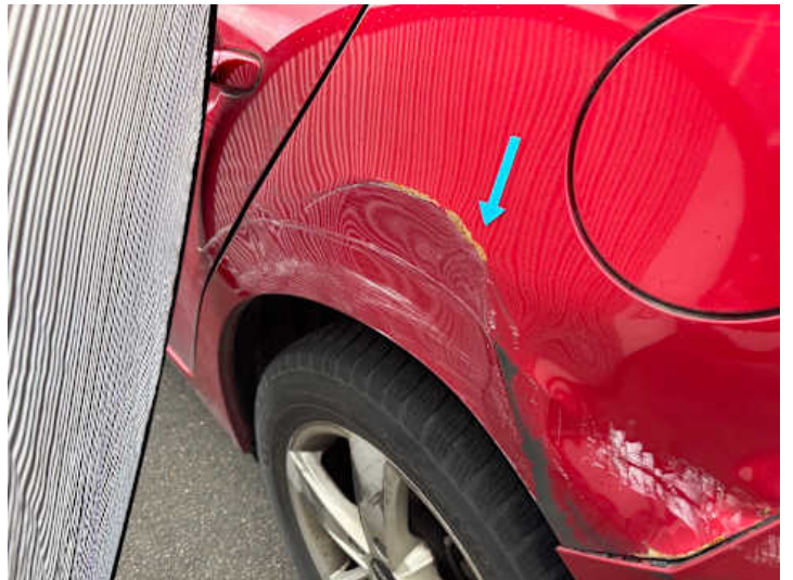
Seitenteil hinten links (Delle, Lackschaden, Rost)
