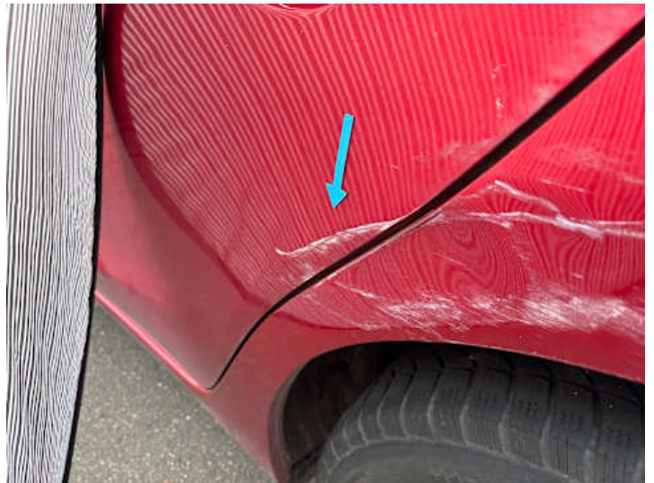
Türe hinten links (Delle, Lackschaden)
