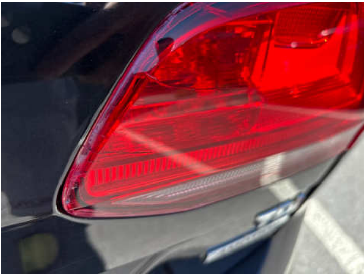
Rücklicht (rechts) (Riss/Bruch)
