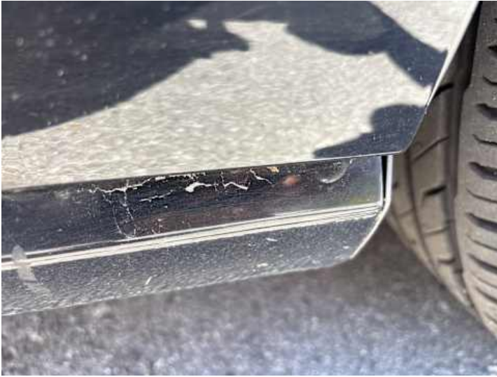
Schweller rechts (Rost)
