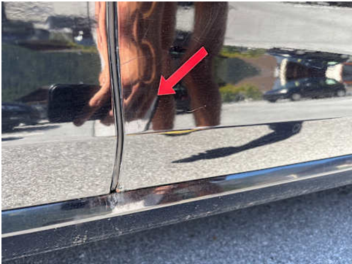
Beifahrertür (Delle, Rost)
