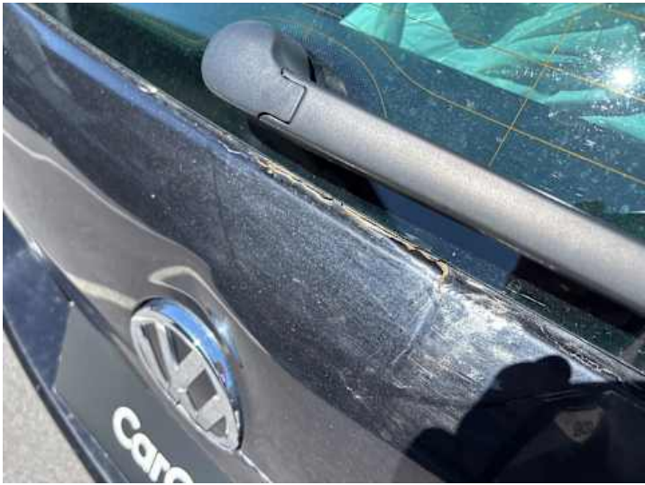
Heckklappe (Verformung, Rost)
