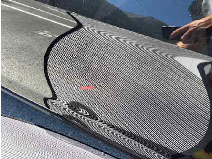
Beifahrertür (Delle, Lackschaden)
