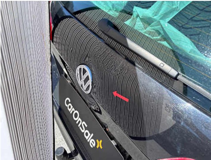
Heckklappe (Verformung, Rost)
