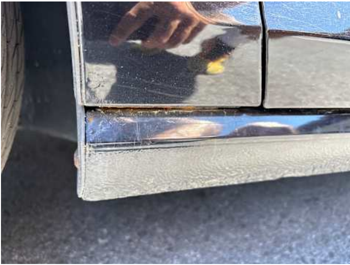
Schweller links (Rost)
