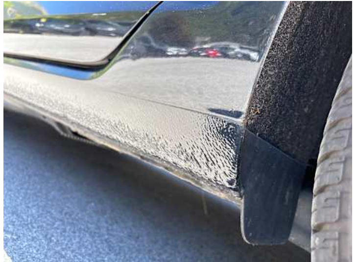
Schweller links (Rost)
