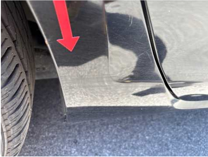
Schweller rechts (Kratzer, Rost)
