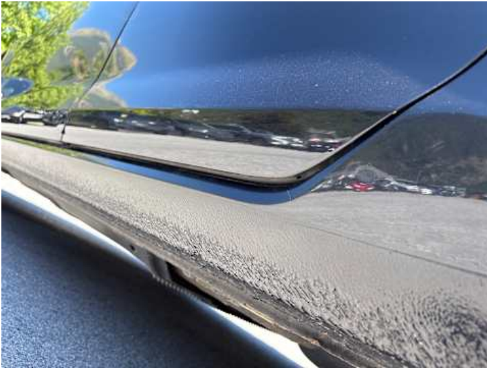
Türe hinten links (Spaltmaße ungenau)
