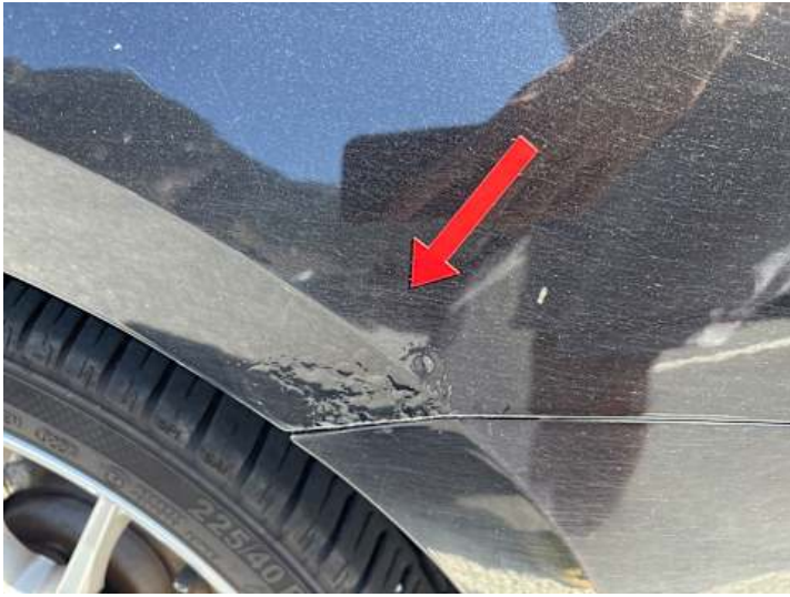
Seitenteil hinten links (Rost)
