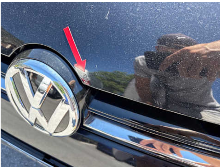
Motorhaube (Unsachgemäß instand gesetzt)
