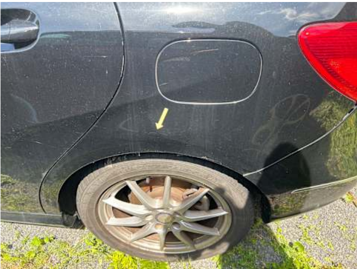
Seitenteil hinten links (Lackschaden, Kratzer)
