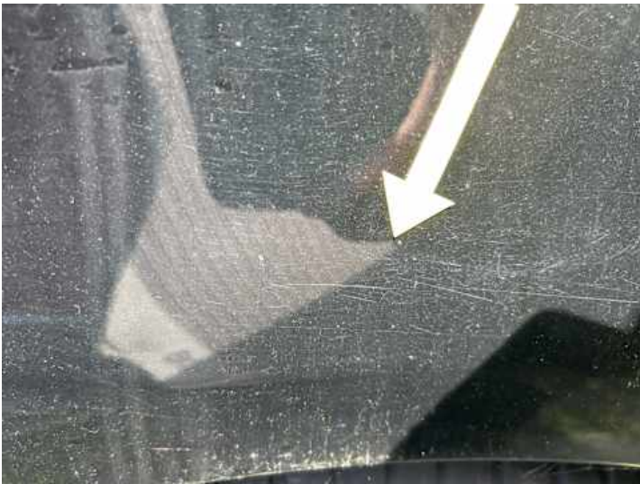
Seitenteil hinten links (Lackschaden, Kratzer)
