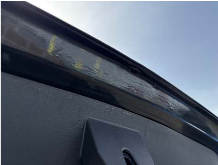
Heckklappe (Lackschaden, Unsachgemäß instand gesetzt)
