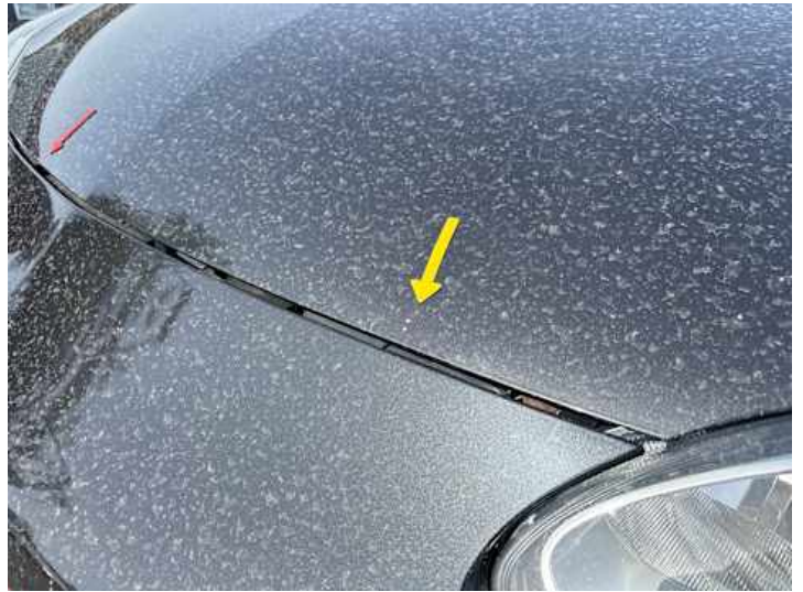
Motorhaube (Rost, Steinschlag)
