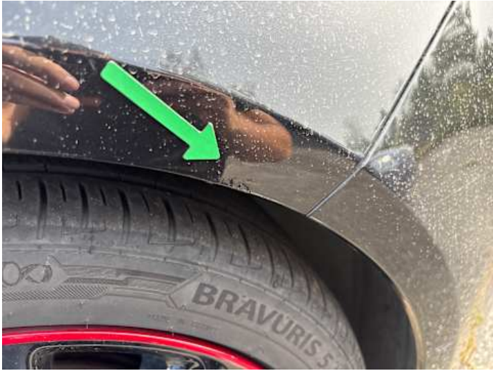
Kotflügel vorne rechts (Rost)
