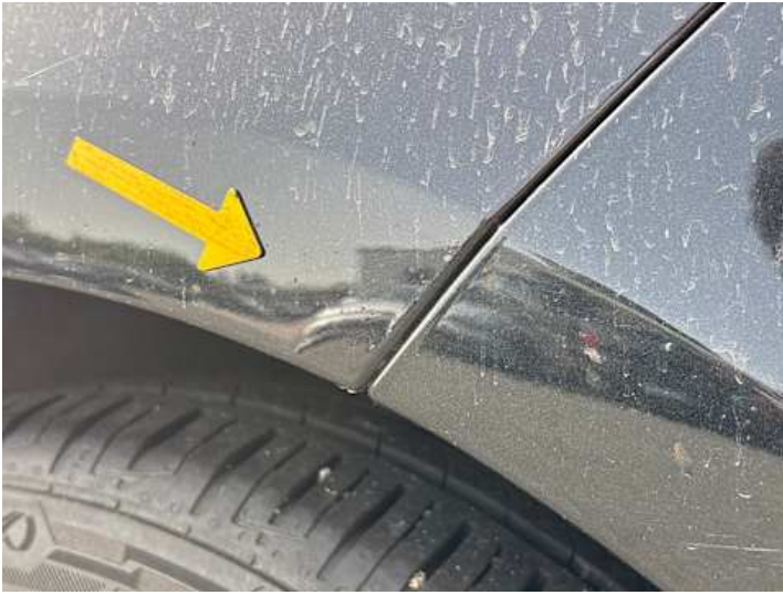
Seitenteil hinten links (Rost)
