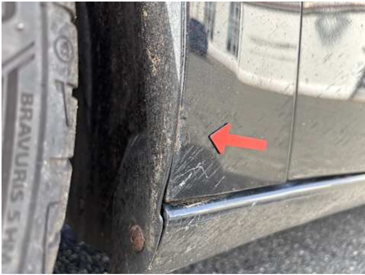
Kotflügel vorne links (Rost)
