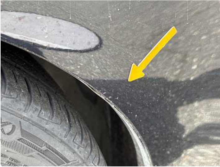
Kotflügel vorne links (Rost)
