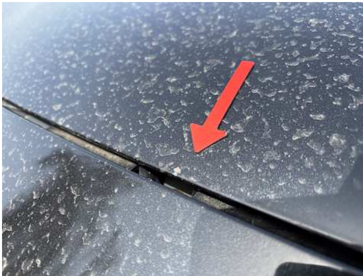
Motorhaube (Rost, Steinschlag)
