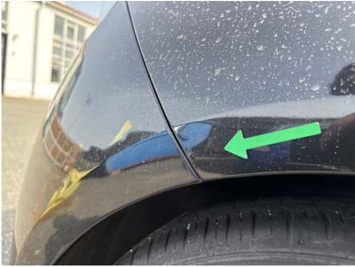
Seitenteil hinten rechts (Rost)
