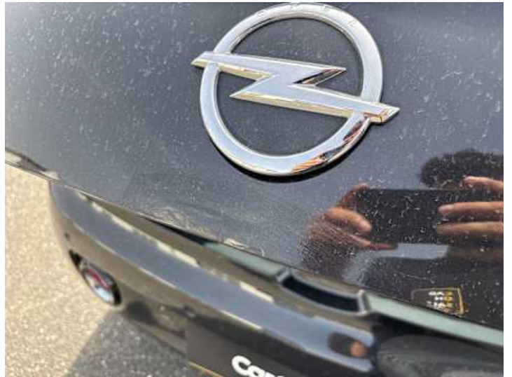
Heckklappe (Lackschaden, Unsachgemäß instand gesetzt)
