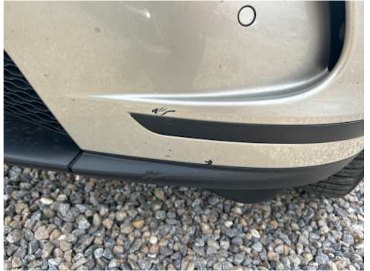
Stoßstange vorne (Kratzer)
