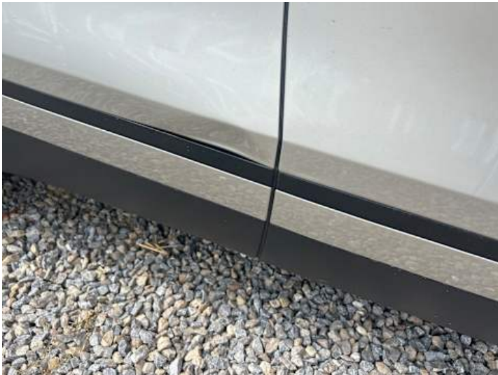
Türe hinten rechts (Verformung)
