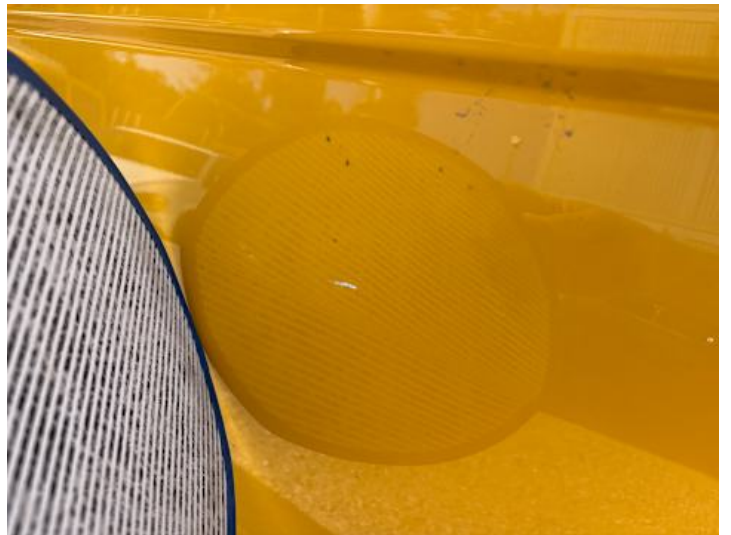
Türe hinten rechts (Kratzer, Delle)
