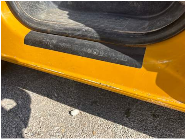
Schweller links (Kratzer, Lackschaden)
