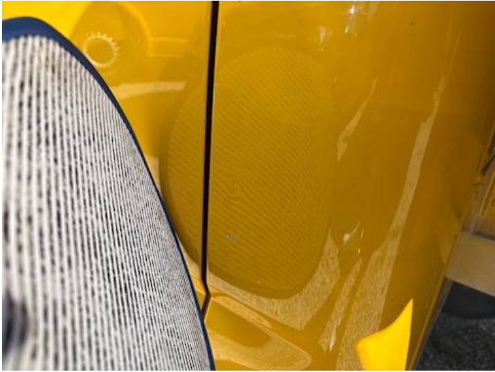
Seitenteil hinten links (Delle)
