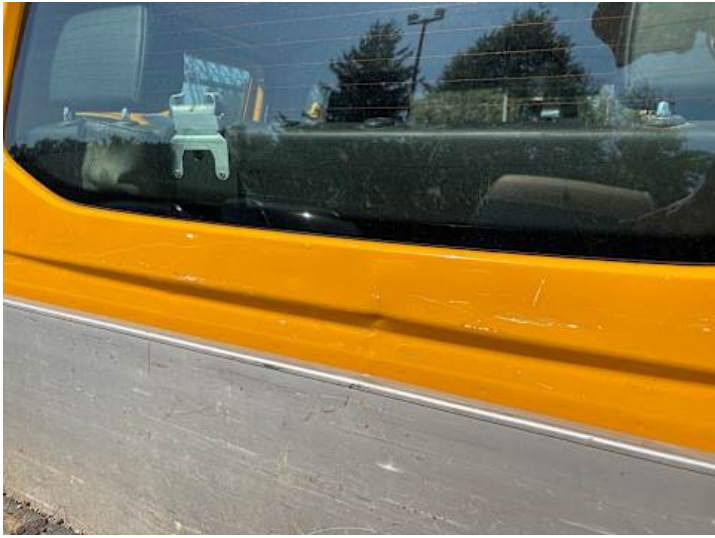
Seitenteil hinten links (Kratzer, Delle)
