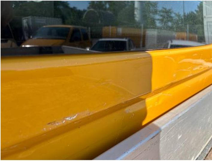
Seitenteil hinten links (Kratzer, Delle)
