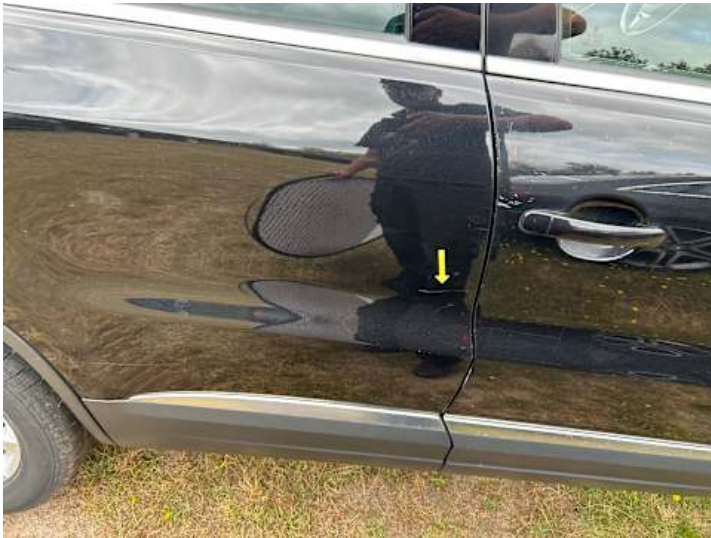
Türe hinten rechts (Kratzer, Lackschaden)
