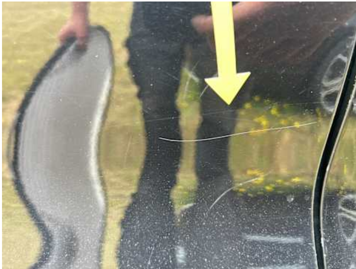
Türe hinten rechts (Kratzer, Lackschaden)
