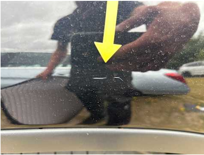
Kotflügel vorne links (Kratzer)
