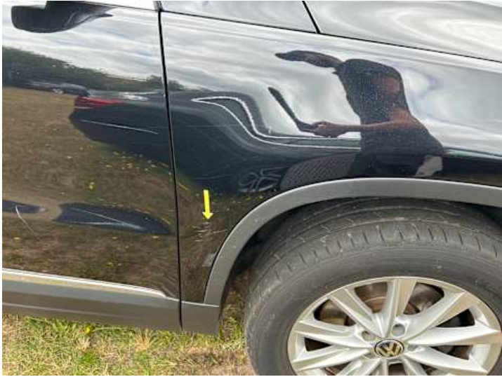
Kotflügel vorne rechts (Kratzer, Lackschaden)
