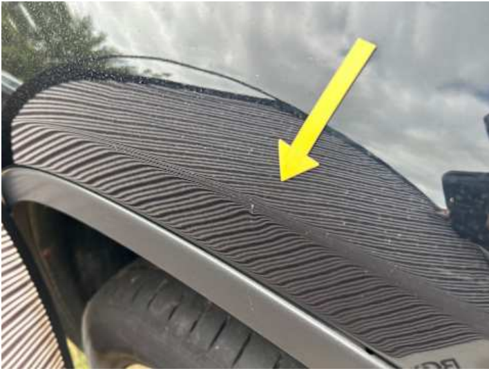
Kotflügel vorne rechts (Delle, Lackschaden)
