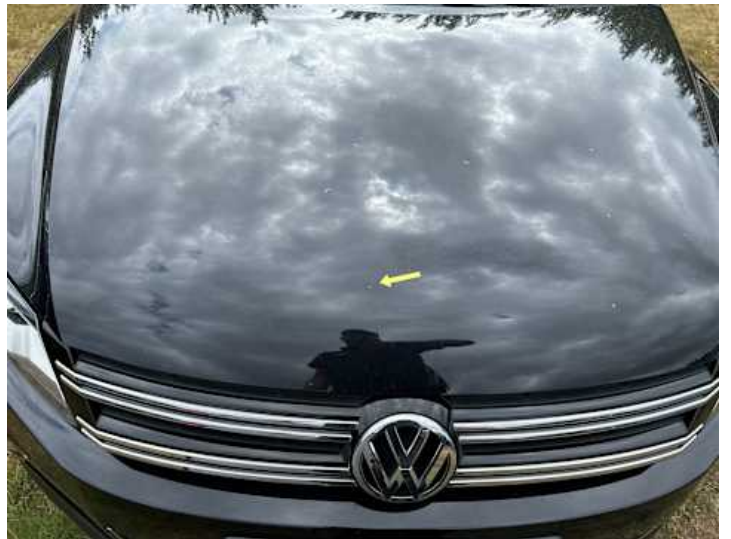
Motorhaube (Lackschaden, Steinschlag)
