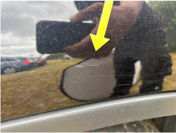
Seitenteil hinten links (Kratzer)
