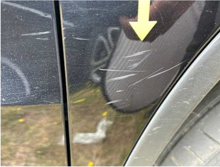
Kotflügel vorne rechts (Kratzer, Lackschaden)
