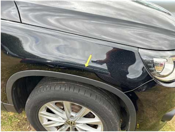
Kotflügel vorne rechts (Delle, Lackschaden)
