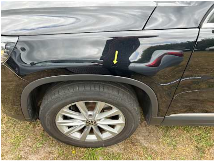
Kotflügel vorne links (Kratzer)
