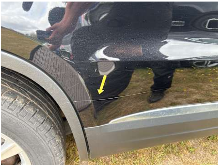
Türe hinten rechts (Kratzer, Lackschaden)
