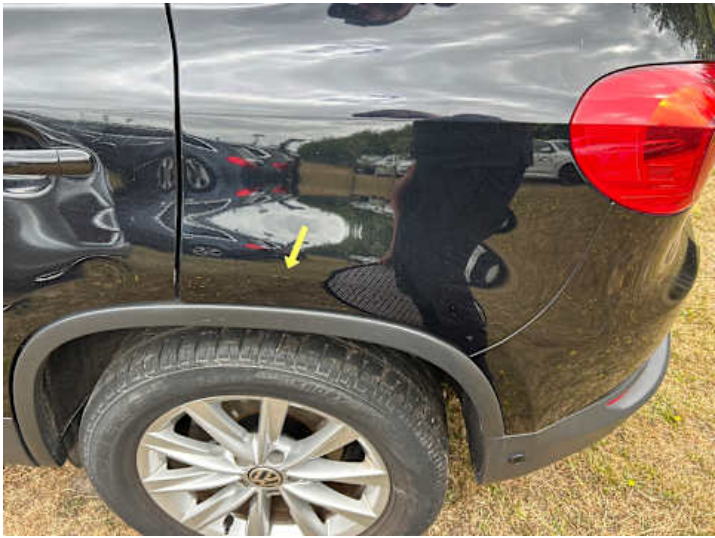
Seitenteil hinten links (Kratzer)
