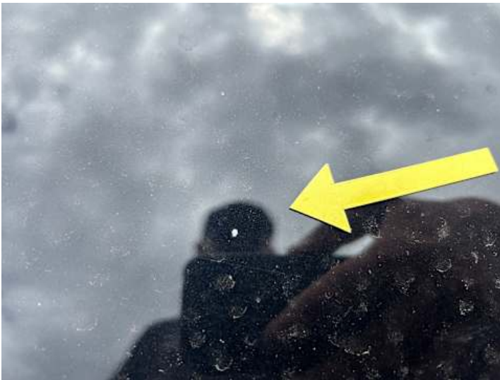
Motorhaube (Lackschaden, Steinschlag)
