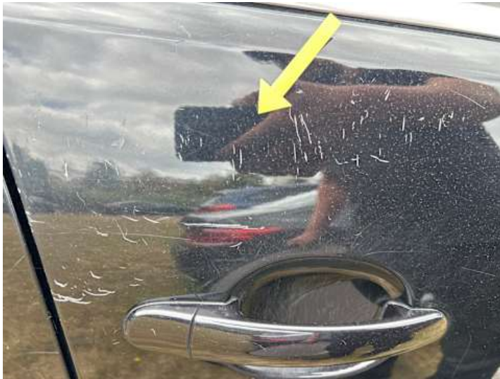
Beifahrertür (Kratzer, Lackschaden)
